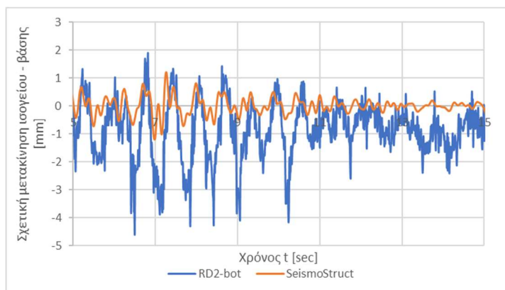
Διάγραμμα 4-53. Σύγκριση σχετικής μετακίνησης ισογείου – βάσης δοκιμίου Δ2-R2-BWAB Test 2.
