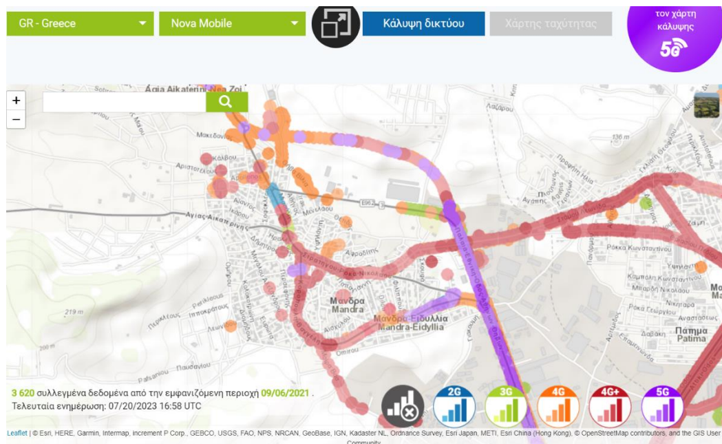
Εικόνα 5.1.7. Χαρτογραφική απεικόνιση της κάλυψης των τεχνολογιών κινητής τηλεφωνίας και διαδικτύου του φορέα της NOVA για την περιοχή του οικισμού της Μάνδρας. Πηγή δεδομένων: https://www.nperf.com/el/map/GR/-/signal/?ll=38.35306967336674&lg=24.49000000000013&zoom=6
