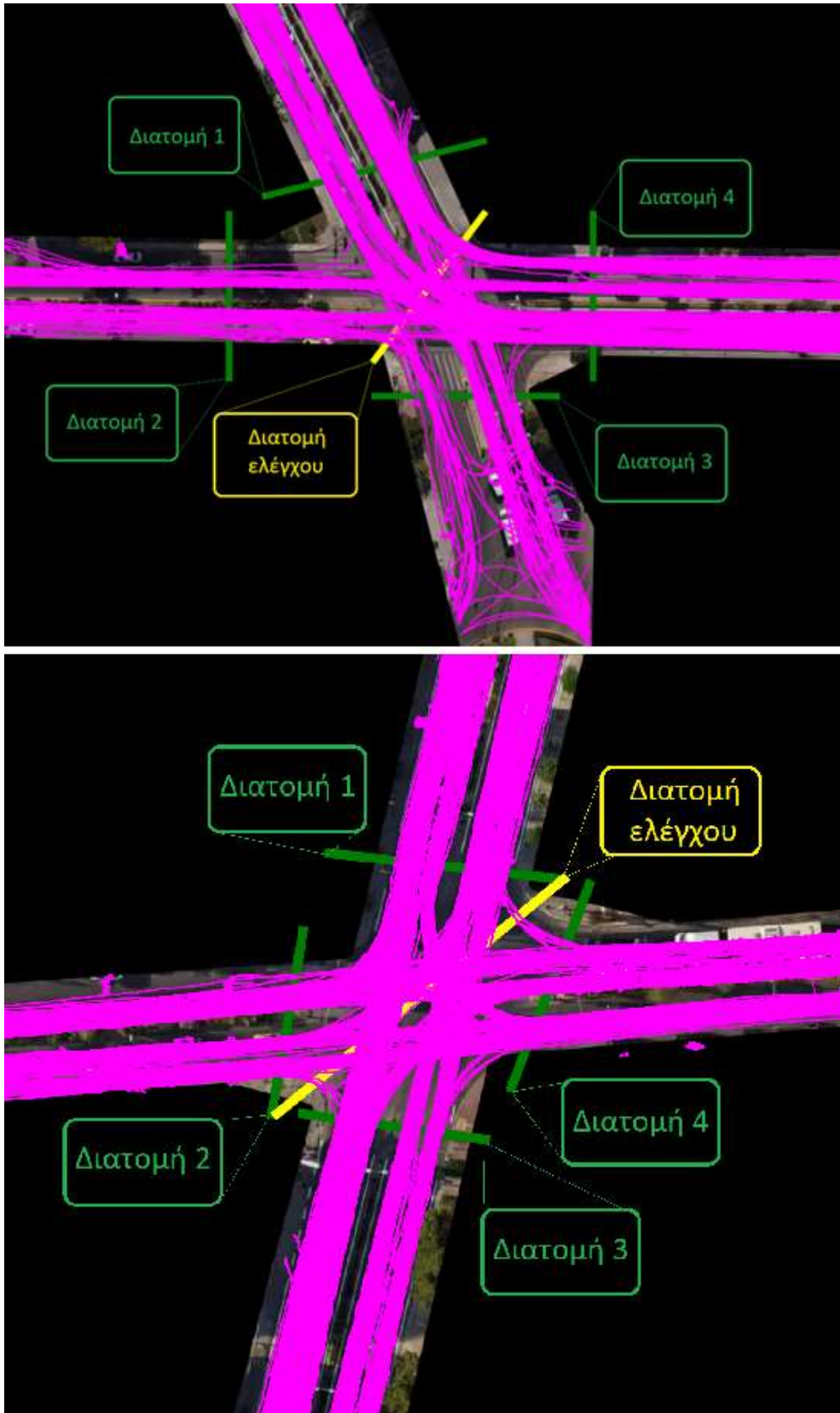
Σχήμα 33: Παρουσίαση των διατομών καταμέτρησης στους κόμβους Ηρώων Πολυτεχνείου – Παύλου Πεντάρη (άνω) και Πρωτόπαπα – Σοφοκλή Βενιζέλου (κάτω). Αντίστοιχα, με ματζέντα αποτυπώνεται η αθροιστική οπτικοποίηση των «έγκυρων» τροχιών που προήλθαν από τα DJI_0107.mp4 και DJI_0560.mov.
