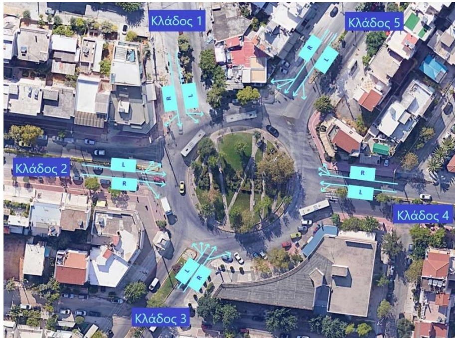
Σχήμα 50: Ο κυκλικός κόμβος της Πλατείας 25 ης Μαρτίου φέρει 5 κλάδους, ο καθένας με 2 λωρίδες στην πρόσβασή του, ενώ υπάρχουν 2 λωρίδες εντός του δακτυλίου. Επομένως κάθε λωρίδα πρόσβασης διαθέτει διακριτή κυκλοφοριακή ικανότητα και αναλύεται ξεχωριστά. Όπως εξηγείται στην επόμενη σελίδα, θεωρείται η κατανομή φόρτου της μορφής «Left-Through» κινήσεων για την αριστερή λωρίδα και «Through-Right» κινήσεων για τη δεξιά. Για το διαμοιρασμό του φόρτου σε 2 λωρίδες προς κοινή «Through» κίνηση, εφαρμόζονται αναλογίες 50-50. Για παράδειγμα, η ζήτηση των οχημάτων που θέλουν να μετακινηθούν από τον Κλάδο 2 στον Κλάδο 4, θεωρείται ισομοιρασμένη στη δεξιά και αριστερή λωρίδα της πρόσβασης. (γεωχωρικό υποβαθρο Google Earth)
