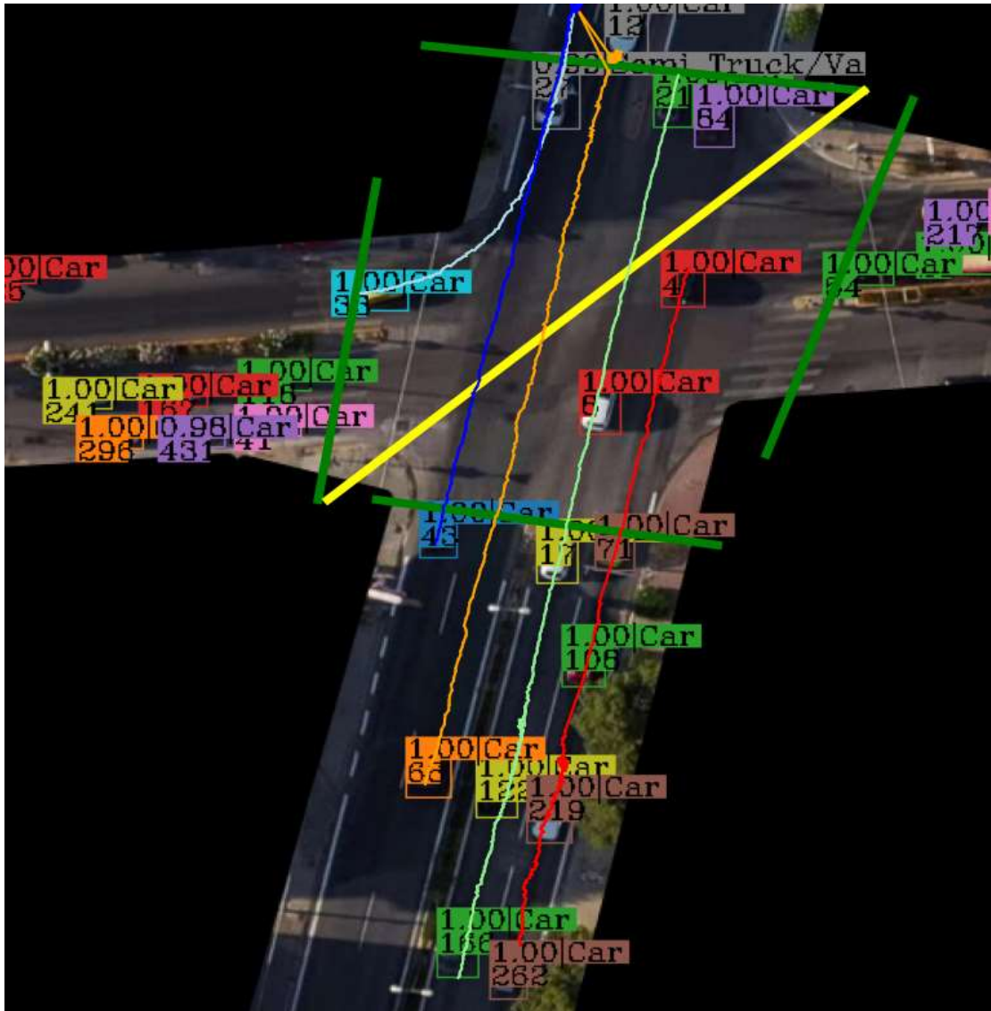
Σχήμα 44: Παραδείγματα οπτικοποίησης εξαγόμενων τροχιών οχημάτων από το βίντεο DJI_0560.mov.
