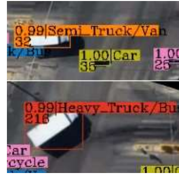
Σχήμα 46: Περίπτωση διαχωρισμού τροχιάς υπό διαφορετικά IDs. Επιπλέον έχει μεταβληθεί η πρόβλεψη κατηγορίας οχήματος του ανιχνευτή.
