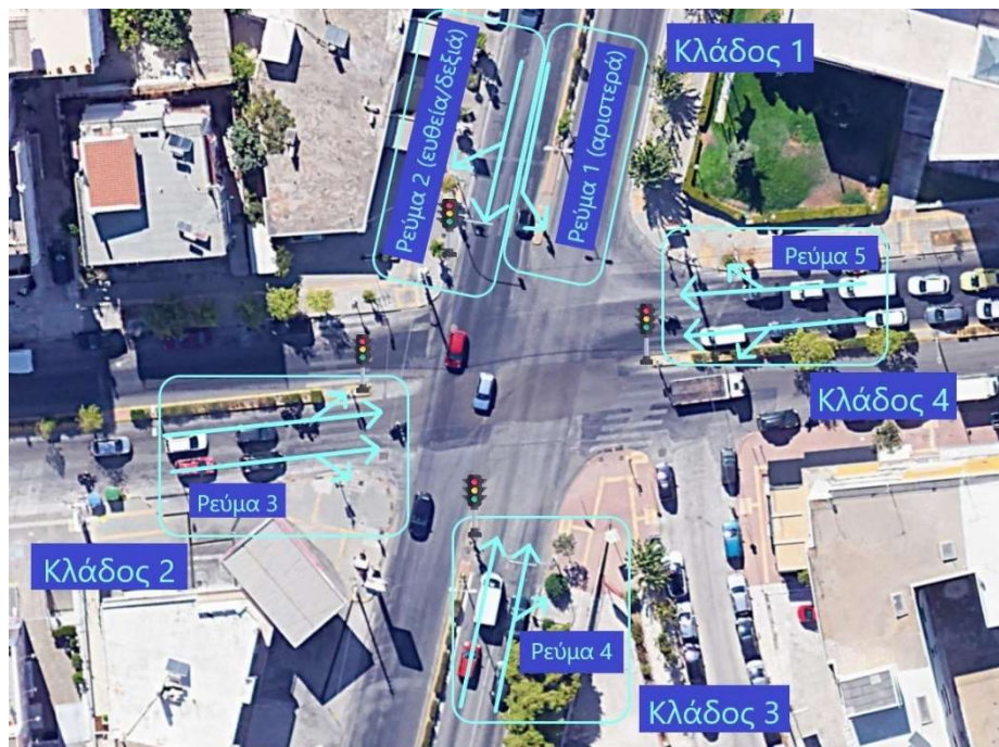
Σχήμα 49: Διάκριση ρευμάτων στον κόμβο Πρωτόπαπα – Σοφοκλή Βενιζέλου, όπως ορίζει το υφιστάμενο πρόγραμμα φωτεινής σηματοδότησης. (γεωχωρικό υποβαθρο Google Earth)
