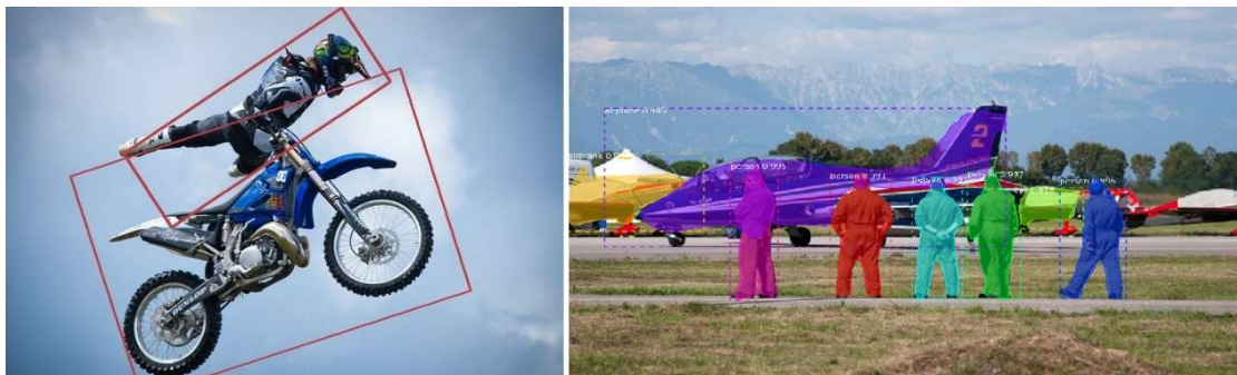
Σχήμα 10: Παραδείγματα oriented object detection (αριστερά) και instance segmentation (δεξιά). (πηγές: https://developer.nvidia.com/blog/detecting-rotated-objects-using-the-odtk/ , https://datascience.eu/computer-vision/mask-r-cnn/ , προσπελάστηκαν Αυγ. 2023)
