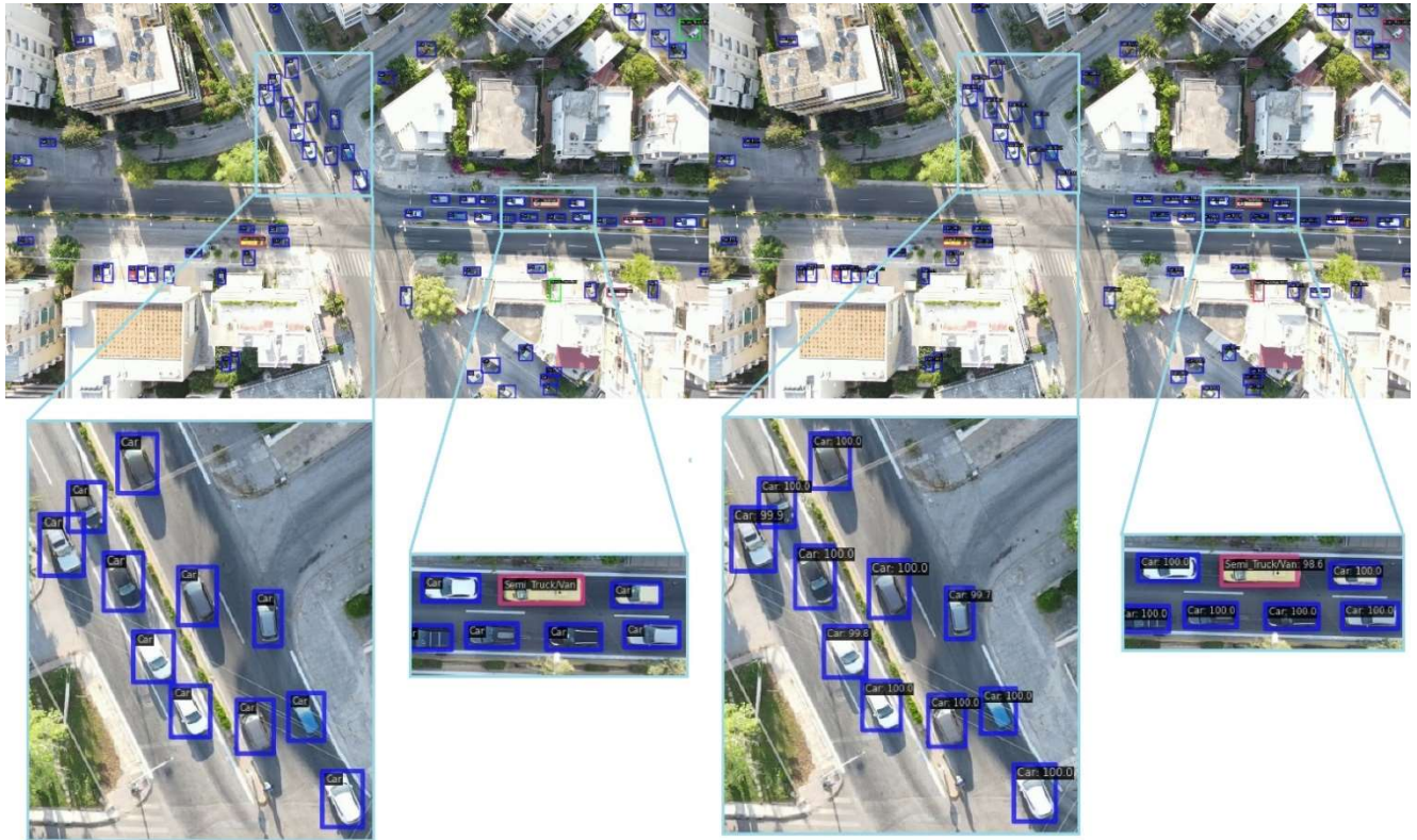
Σχήμα 38: Σύγκριση πληροφορίας αλήθειας (αριστερά), με τις εξαγόμενες ανιχνεύσεις (δεξιά) στον κόμβο Ηρώων Πολυτεχνείου – Παύλου Πεντάρη.
