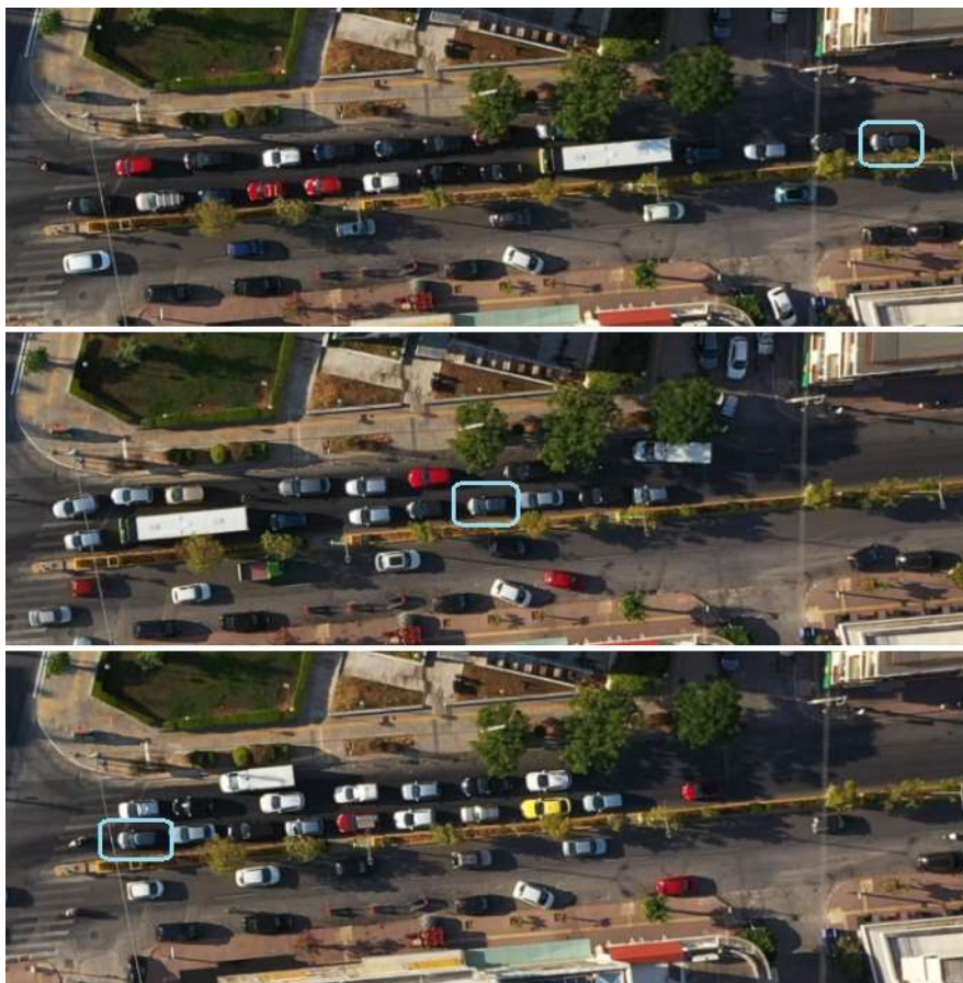
Σχήμα 51: Περίπτωση κατά την οποία ένα όχημα δεν κατάφερε να διέλθει του κόμβου Πρωτόπαπα – Σοφοκλή Βενιζέλου, παρότι αντίκρισε 3 κόκκινες ενδείξεις στο Ρεύμα 5 ( οι 2 ολοκληρωμένες διάρκειας + 1 περιορισμένης κατά την άφιξή του).
