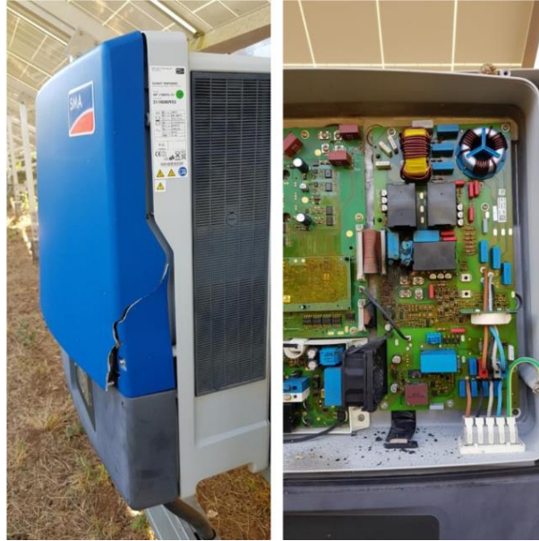
Εικόνα 2.20 Εσωτερικό κάψιμο αντιστροφέα Νο 7
