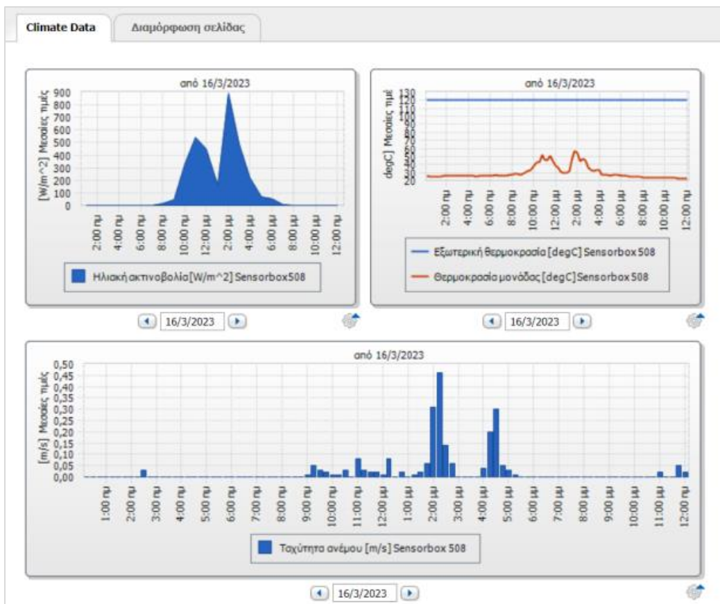
Εικόνα 2.18 Απεικόνιση ωριαίων κλιματολογικών δεδομένων για τις 16/03/2023 Πηγή: sunny portal
