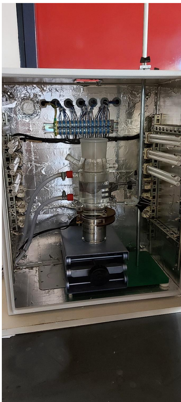
Εικόνα 15. Αντιδραστήρας υψηλών υπερήχων μέσα στον θάλαμο UVA που χρησιμοποιήθηκε για τα πειράματα.
