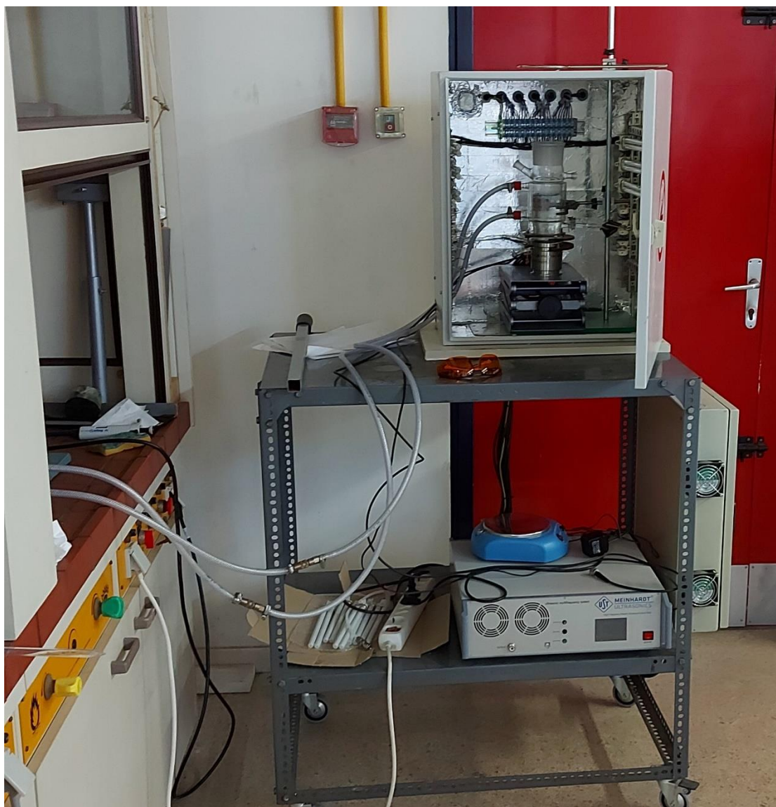
Εικόνα 17. Ολοκληρωμένη μορφή της πειραματικής διάταξης, με τον θάλαμο UVA, τον αντιδραστήρα, το μηχάνημα υπερήχων και στο αριστερό μέρος τον ψύκτη ανακυκλοφορίας Julabo
