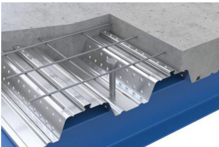
Σχήμα 5-1: Απεικόνιση του επιλεγόμενου χαλυβδόφυλλου ComFlor 60, [37]
