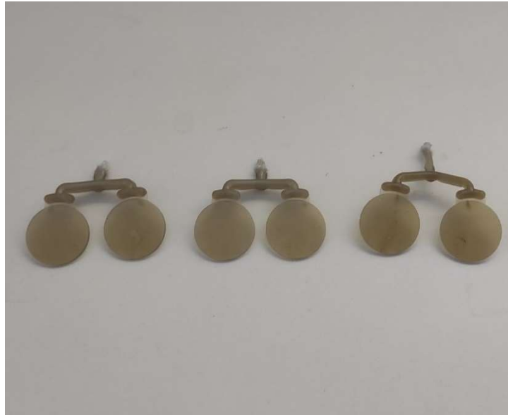
Εικόνα 21: Στρογγυλά δοκίμια για ρεολογικές δοκιμές
