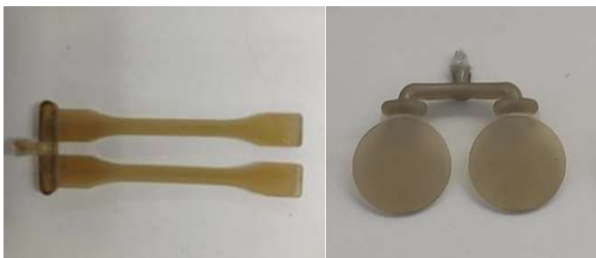
Εικόνα 19: Δοκίμια dog-bone για tensile testing (δεξιά) και κυκλικά δοκίμια για ρεολογικές δοκιμές (αριστερά)
