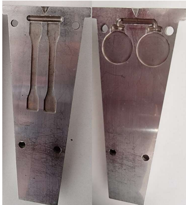
Εικόνα 28: Εσωτερικό τμήμα μεταλλικών καλουπιών για χύτευση μέσω έγχυσης. Για δοκίμια dog-bone χρησιμοποιούνται 2 ίδια τμήματα σαν αυτό που απεικονίζεται αριστερά. Για στρογγυλά δοκίμια χρησιμοποιούνται 2 ίδια τμήματα σαν το δεξιά
