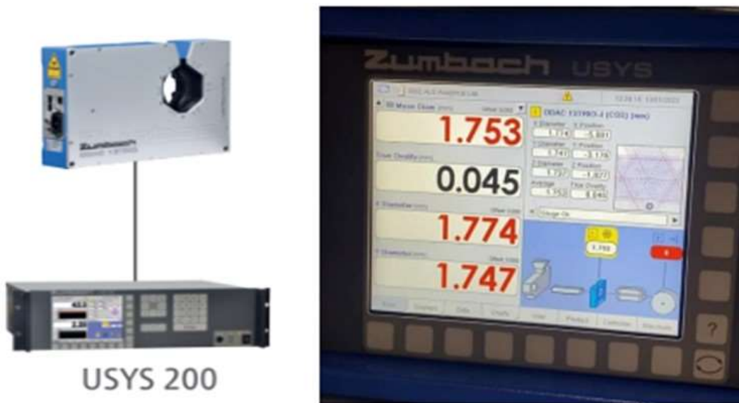
Εικόνα 24: Καταγραφικό όργανο διαμέτρου νήματος με χρήση λέιζερ, ODAC TRIO three axial laser
