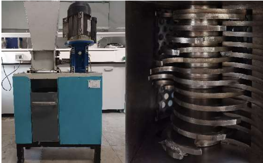
Εικόνα 11: Τεμαχιστής μπουκαλιών (αριστερά). Λεπίδες τεμαχιστή (δεξιά)
