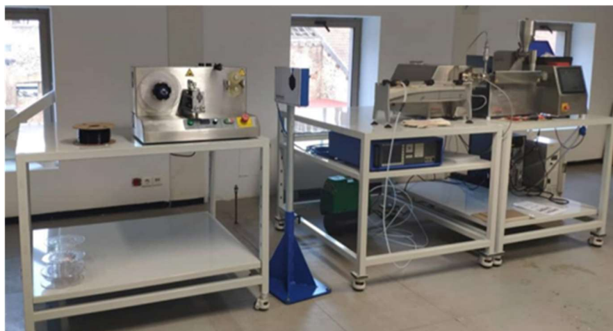
Εικόνα 12: Πιλοτική γραμμή παραγωγής νήματος πολυμερών μέσω εκβολής
