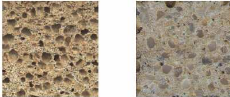
ΣΧΗΜΑ 7.22: Τσιμέντο. Αριστερά απλό, δεξιά ενισχυμένο με ΥΑΦ
