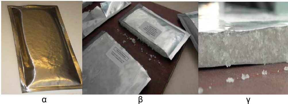
ΣΧΗΜΑ 5.1: Ευρύτατα διαδεδομένος τρόπος συσκευασίας ΥΑΦ, για πολλών ειδών υλικά και πλήθος διαφορετικών εφαρμογών: (α) συσκευασία ΥΑΦ, (β) τομή συσκευασίας, (γ) λεπτομέρεια
