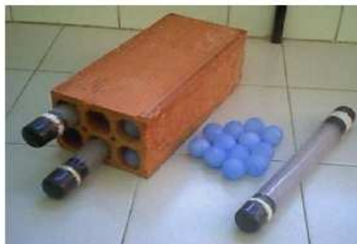
ΣΧΗΜΑ 7.23: Τούβλο ενισχυμένο με σωλήνες ΥΑΦ
