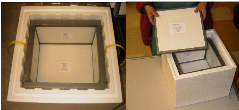
ΣΧΗΜΑ 7.11: Τυπικές πλάκες με ΥΑΦ για ενίσχυση συσκευασιών μεταφοράς προϊόντων
