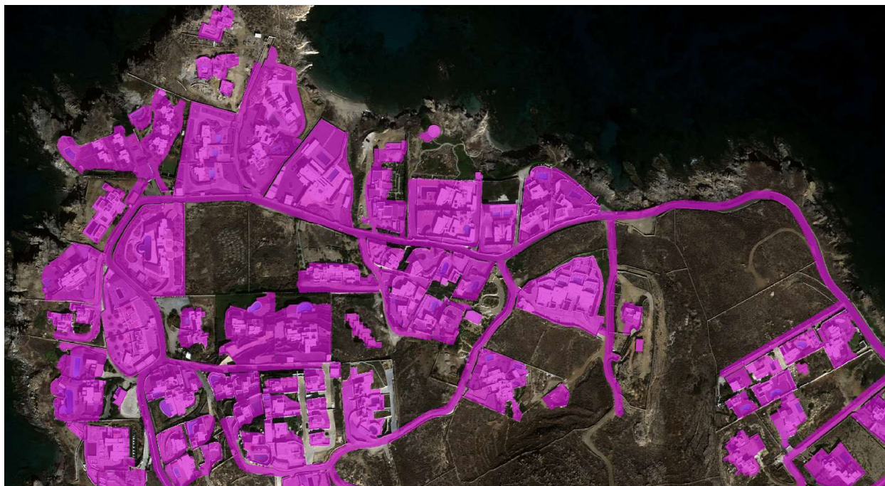
Εικόνα 18 : Δείγμα παραχθέντων επισημειωμένων δεδομένων από Δορυφορική Εικόνα στη Μύκονο
