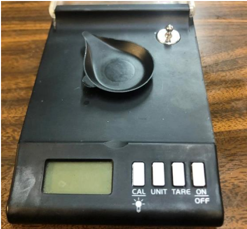
Εικόνα 25: Ζυγαριά στην οποία μετρήθηκε η μάζα των δοκιμίων
