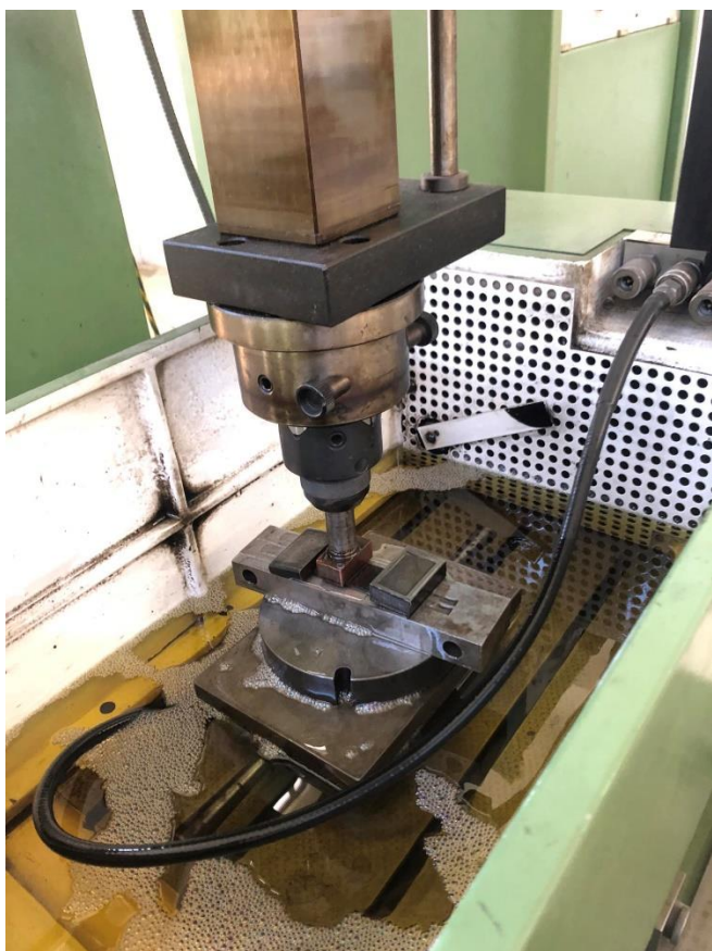
Εικόνα 26: Τοποθέτηση του 1ου δοκιμίου με μηδενική γωνία τοποθέτησης και χρησιμοποίηση εδράσεων
