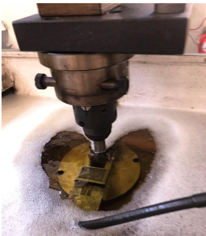
Εικόνα 27: Πλήρωση της δεξαμενής με διηλεκτρικό ρευστό και κάλυψη του τεμαχίου
