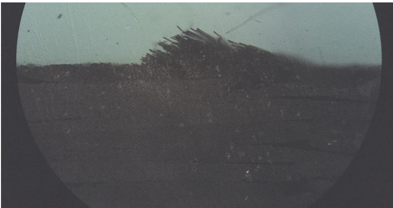
Εικόνα 61: ZOOM IN στις ίνες για το δοκίμιο A 3 (Μεγέθυνση 200x)
