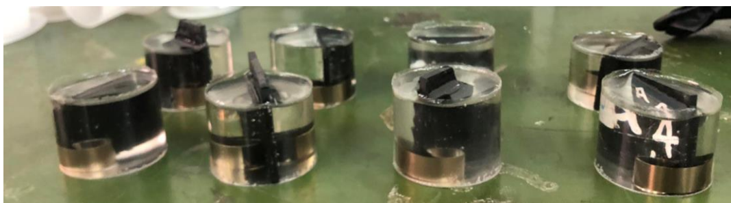
Εικόνα 34: Εγκιβωτισμένα δοκίμια μετά την αφαίρεση των κυαθίων σε πρόοψη
