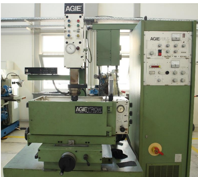
Εικόνα 20: Η εργαλειομηχανή ηλεκτροδιάβρωσης του εργαστηρίου
