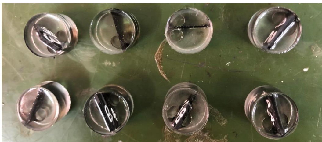
Εικόνα 35: Εγκιβωτισμένα δοκίμια μετά την αφαίρεση των κυαθίων σε κάτοψη
