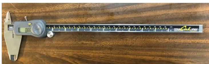
Εικόνα 40: Ηλεκτρονικό παχύμετρο για την ακριβή μέτρηση των διαστάσεων
