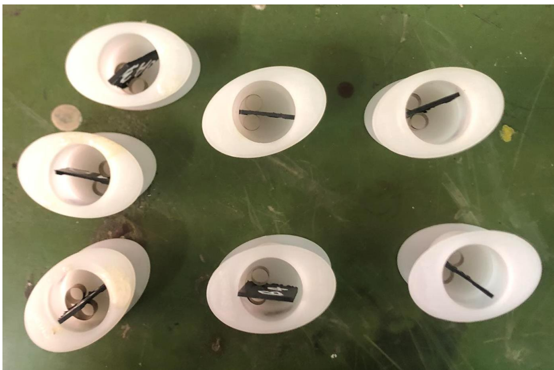
Εικόνα 33: Εγκιβωτισμένα δοκίμια πριν τη στερεοποίηση της ρητίνης
