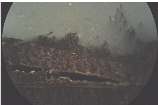
Εικόνα 66: ZOOM IN στις ίνες για το δοκίμιο B_4 (Μεγέθυνση 200x)
