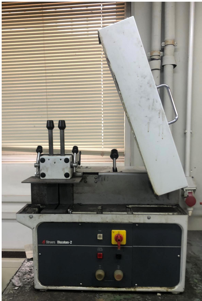
Εικόνα 30: Κοπτικός τροχός του εργαστηρίου
