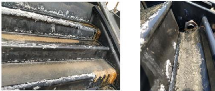
Εικόνα 61: Δημιουργία μικροφίλμ στη ροή εσωτερικά του αποστακτήρα ( αριστερά ) και παρεμπόδιση απορροής της άλμης ( δεξιά ).
