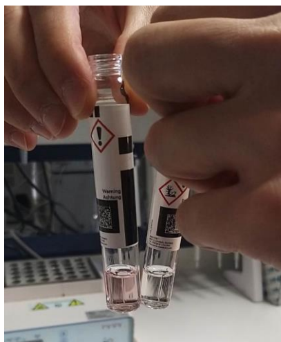
Σχήμα 6.8: Φιαλίδιο του υπερκείμενου, με αντιδραστικό σάκχαρο (αριστερά) και φιαλίδιο υπερκείμενου χωρίς αντιδραστικό σάκχαρο (δεξιά)
