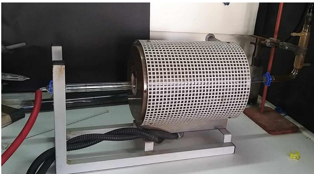
Σχήμα 6.14: Οριζόντιος φούρνος που πραγματοποιήθηκε πυρόλυση της βιομάζας
