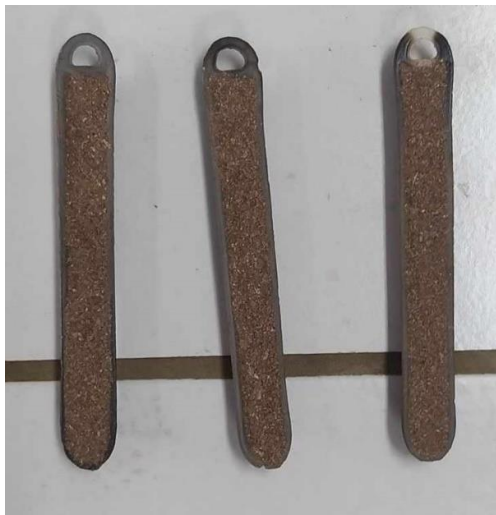
Σχήμα 6.13: Κάψες με βιομάζα, πριν την πυρόλυση.
