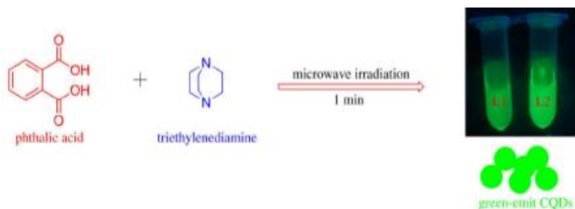
Σχήμα 2.8: Σύνθεση CDs χρησιμοποιώντας φούρνο μικροκυμάτων.
