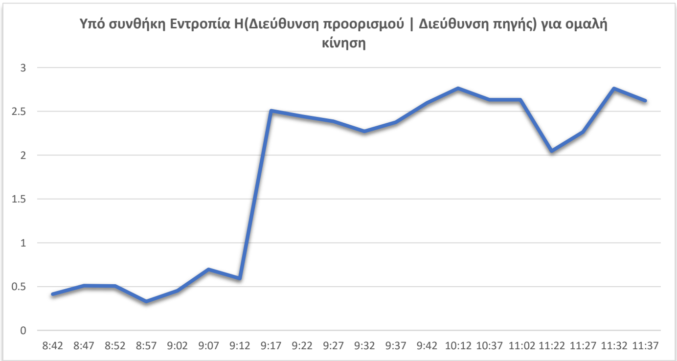
Διάγραμμα 4: Τιμή της Υπό Συνθήκης Εντροπίας H(Διεύθυνση προορισμού | Διεύθυνση πηγής) αποκλειστικά για την ομαλή κίνηση
