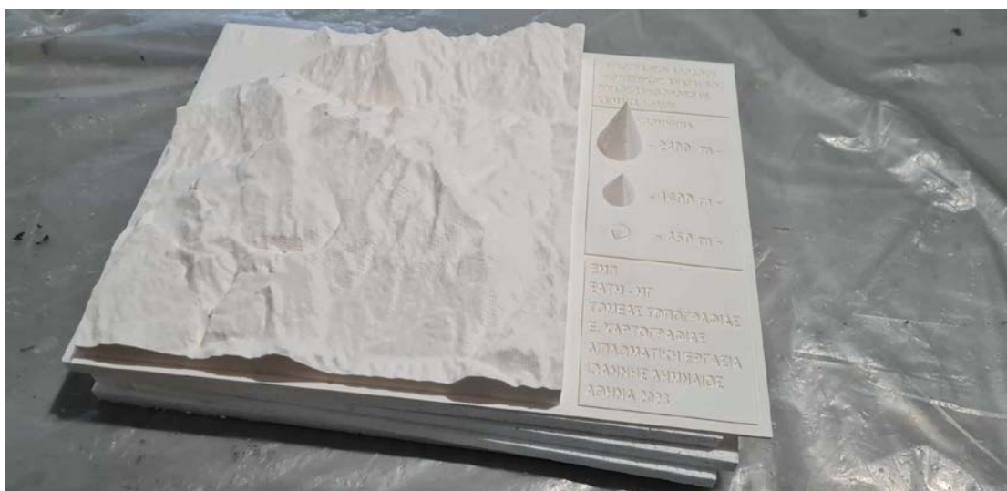
Σχήμα 5.18: Ο τρισδιάστατα εκτυπωμένος χάρτης της απόδοσης του υψομετρικού ανάγλυφου της οροσειράς της Πίνδου στη τελική του μορφή.
