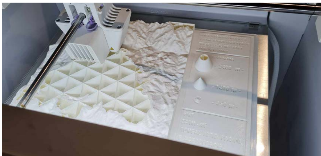
Σχήμα 5.15: Στάδιο από τη κατασκευή του τρισδιάστατου μοντέλου του υψομετρικού ανάγλυφου στον Ultimaker S5.
