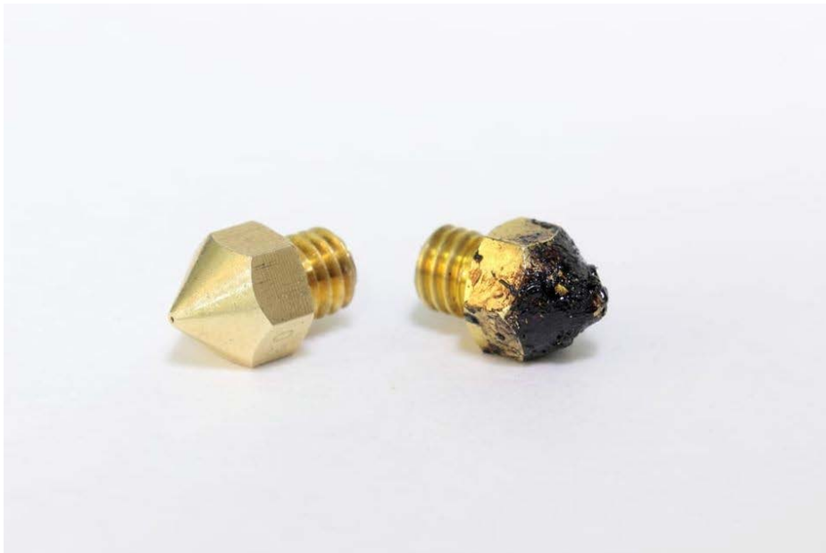
Σχήμα 4.5: Φραγμένο ακροφύσιο από υψηλή θερμοκρασία ή μολυσμένο πολυμερές(σχήμα από Tess Boissonneault, 2022)
