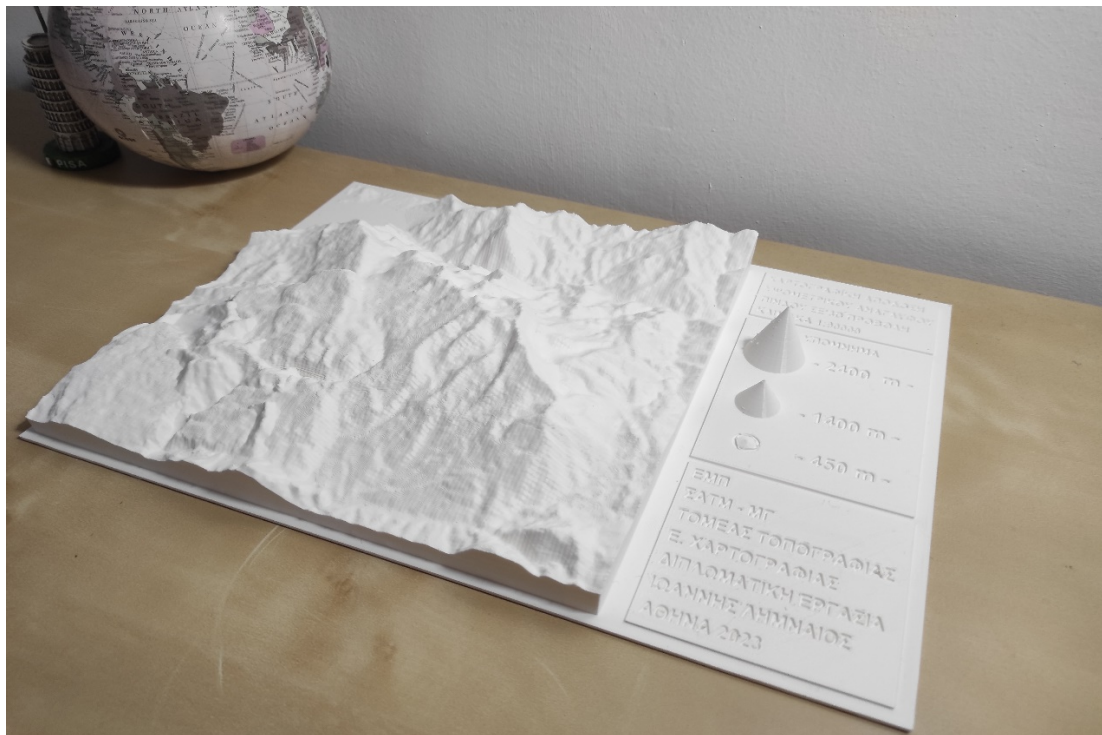
Σχήμα 5.19: Ο τρισδιάστατα εκτυπωμένος χάρτης της απόδοσης του υψομετρικού ανάγλυφου της οροσειράς της Πίνδου στη τελική του μορφή
