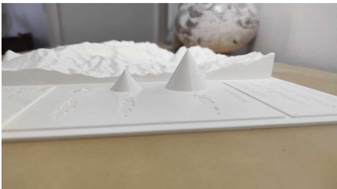
Σχήμα 5.20: Ο τρισδιάστατα εκτυπωμένος χάρτης της απόδοσης του υψομετρικού ανάγλυφου της οροσειράς της Πίνδου στη τελική του μορφή από πλάγια λήψη
