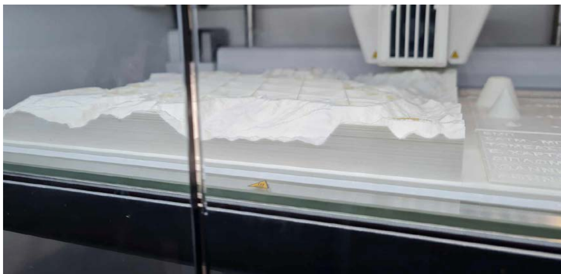
Σχήμα 5.16: Στάδιο από τη κατασκευή του τρισδιάστατου μοντέλου του υψομετρικού ανάγλυφου στον Ultimaker S5 από πλάγια όψη.
