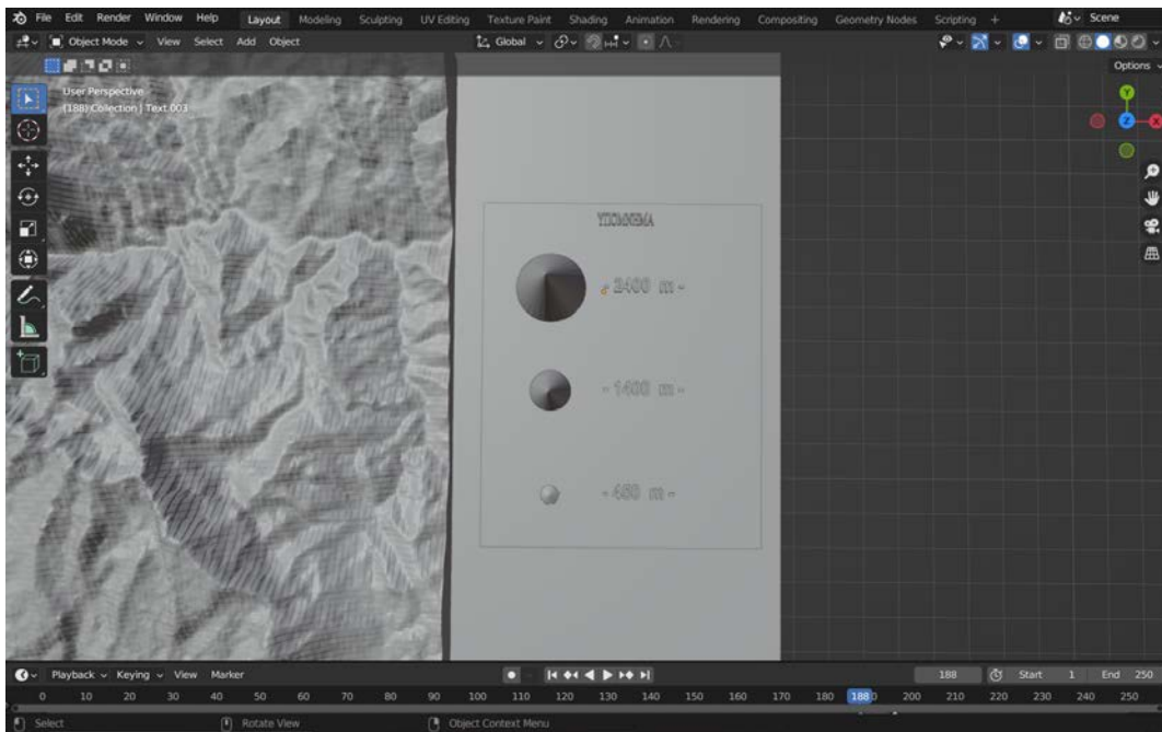
Σχήμα 3.13: Το 3D υπόμνημα του τρισδιάστατου χάρτη, με κάθε κόνο να αναπαριστά τα υψόμετρα 450 m, 1400 m, 2400 m (από κάτω προς τα επάνω, όπως φαίνεται στην εικόνα)
