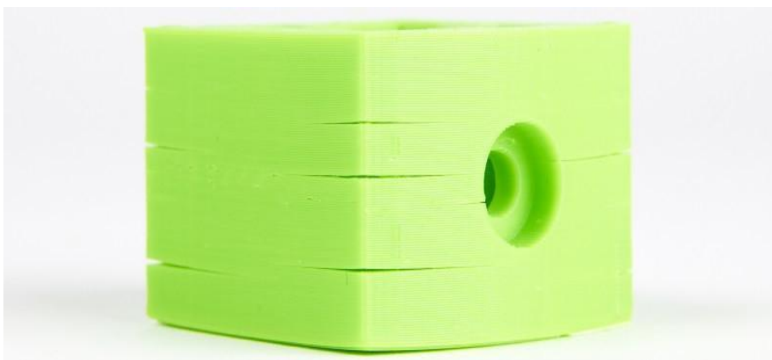
Σχήμα 3. 21: Φαινόμενο διαχωρισμού στρωμάτων λόγω συρρίκνωσης κατά την ψύξη του υλικού. (σχήμα από Geeetech.com)
