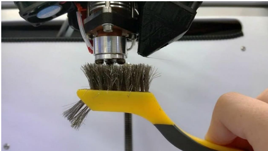
Σχήμα 3. 24: Χρήση συρμάτινης βούρτσας για τον καθαρισμό του εξωτερικού του ακροφυσίου ( Σχήμα από Airwolf 3D)
