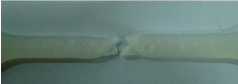
Εικόνα 4.6: Παραμόρφωση της επιφάνειας του δοκιμίου εφελκυσμού του PE, λόγω της επιμήκυνσης του.
