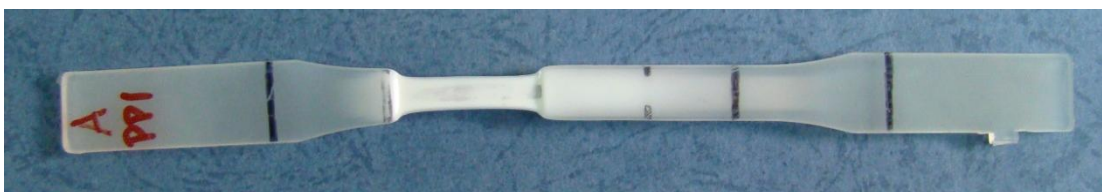
Εικόνα 5.7: Δοκίμιο εφελκυσμού του πρώτου κύκλου εκβολής του PP, μετά την μέτρηση του. Δημιουργία «λαίμωσης».
