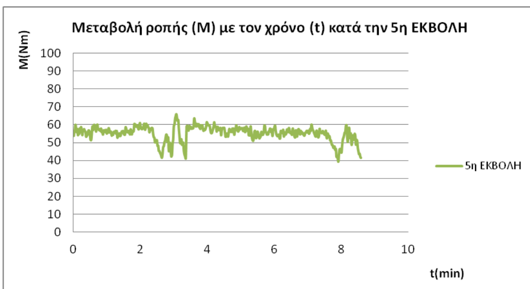
Σχήμα 4.3: Διάγραμμα ροπής στρέψης του κοχλία συναρτήσει του χρόνου, για το PE κατά τον πέμπτο κύκλο εκβολής
