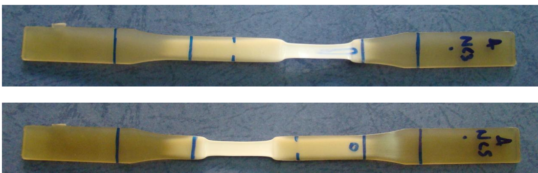
Εικόνα 5.9: Δοκίμια εφελκυσμού του τρίτου και του πέμπτου κύκλου εκβολής του PP-OMMT-COMP, μετά την μέτρηση. Δημιουργία «λαίμωσης».
