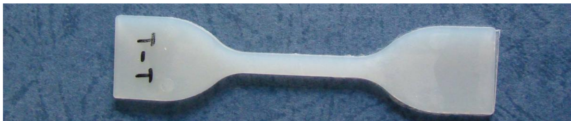
Εικόνα 3.10: Δοκίμιο πολυαιθυλενίου κατά ASTM D638-03.
