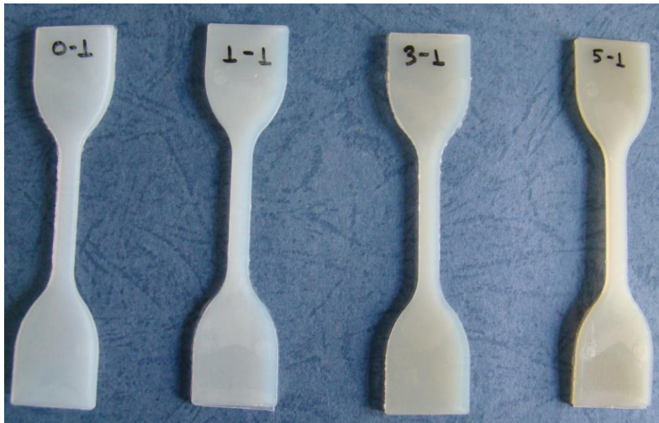
Εικόνα 4.3: Δοκίμια εφελκυσμού του παρθένου PE, του πρώτου, του τρίτου και του πέμπτου κύκλου εκβολής του.
