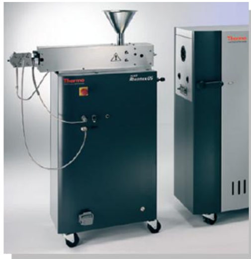
Εικόνα 3.1: Δικόχλιο σύστημα εκβολής Haake PTW 16.
