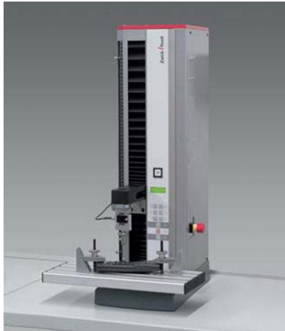
Εικόνα 3.26: Δυναμόμετρο ZWICK Z005.
