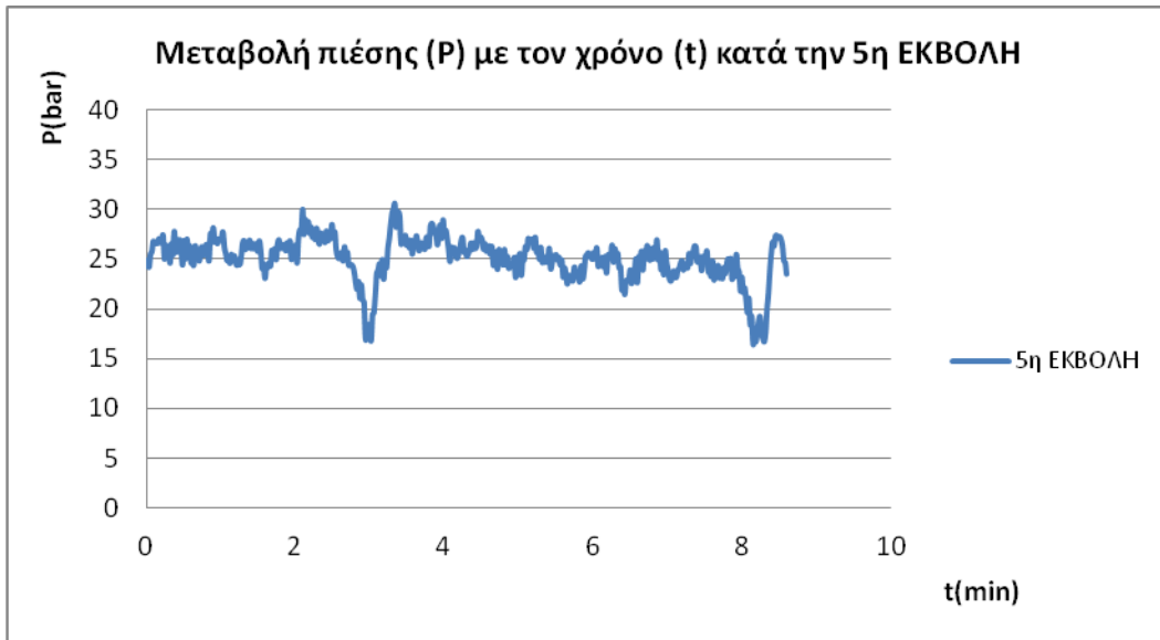
Σχήμα 4.7: Διάγραμμα πιέσεων στη μήτρα συναρτήση του χρόνου για το ΡΕ, κατά τον πέμπτο κύκλο εκβολής
