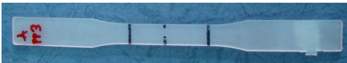
Εικόνα 3.11 : Δοκίμιο πολυπροπυλενίου κατά ASTM D638-01.
