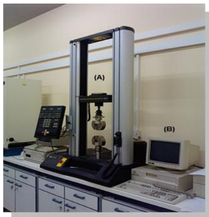
Εικόνα 3.23: Μηχανή εφελκυσμού Instron. A) κεντρική μονάδα Instron, B) ηλεκτρονικός υπολογιστής καταγραφής και χειρισμού της μηχανής.
