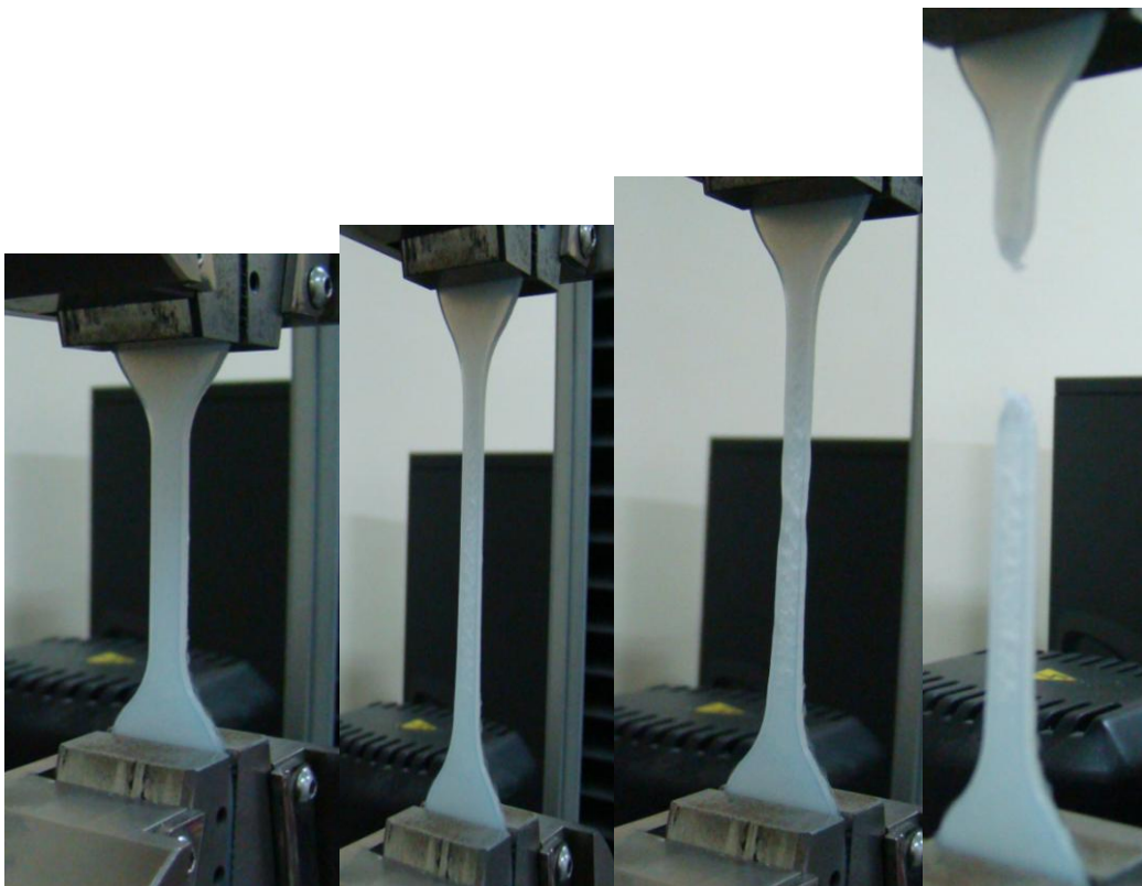
Εικόνα 4.4: Δοκίμιο εφελκυσμού του πρώτου κύκλου εκβολής του PE, πριν την έναρξη της μέτρησης, κατά τη διάρκεια και μετά την θραύση του.
