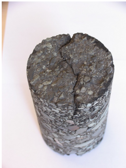
Εικόνα 4.6: Top-Down Cracking Πηγή: (Pavement Interactive, 2023)
