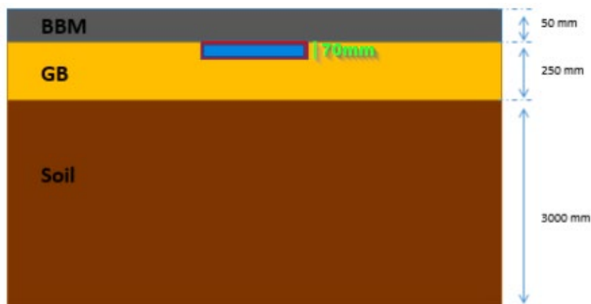
Εικόνα 3.10: Διατομή ελέγχου με την μέθοδο FEM
