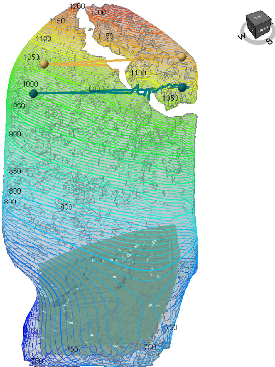
Εικόνα 5.22 Ορισμός μετώπων αποκόλλησης πέτρινων όγκων
