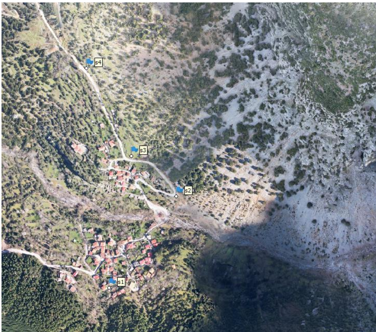
Εικόνα 4.12 ίδρυση θέσεων σημείων ελέγχου εδάφους(GCPS)
