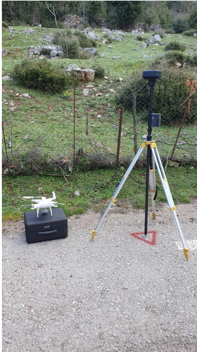
Εικόνα 2.25 Drone RTK κατά την διάρκεια αποτύπωσης
