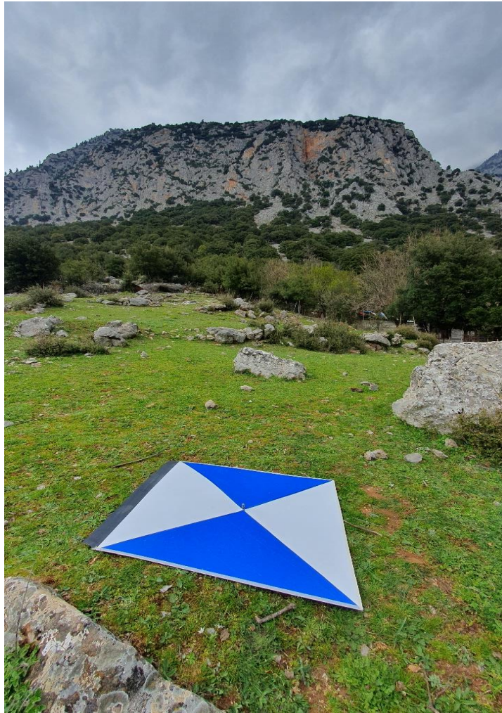
Εικόνα 4.10 Σημείο Ελέγχου Εδάφους S3 (GCP) με βορειοανατολική κατεύθυνση (Η μαύρη λωρίδα στο φωτοσταθερό συμβολίζει τον βορρά)
