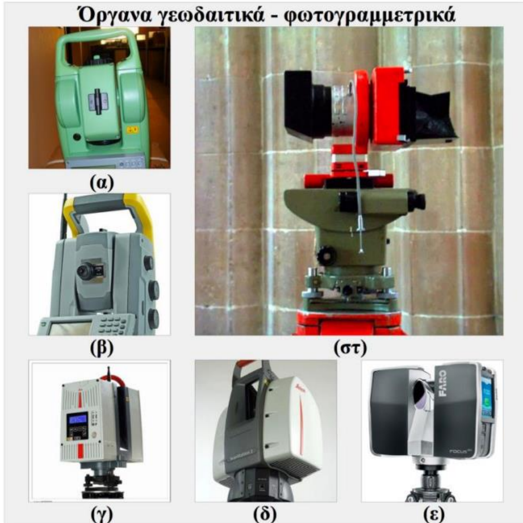
Εικόνα 2.20 Σύγχρονα αντιπροσωπευτικά γεωδαιτικά όργανα που χρησιμοποιούνται στις γεωδαιτικές μεθόδους: (α). Γεωδαιτικός σταθμός χωρίς απαίτηση πρίσματος (β). Ρομποτικός γεωδαιτικός σταθμός (γ), (δ), και (ε). Διάφοροι τύποι Laser scanner (στ). Επίγεια φωτογραμμετρική κάμερα (Δούκας et al., 2012)
