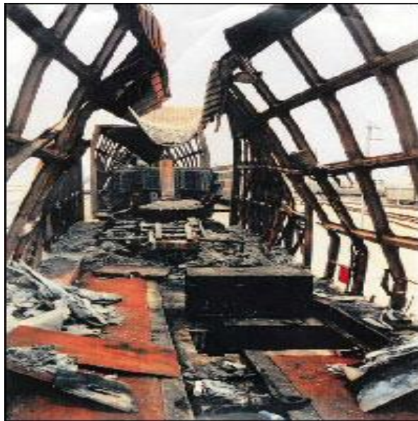
Εικόνα 1. 7 Το καμμένο βαγόνι μετά το ατύχημα στη σήραγγα της Μάγχης
