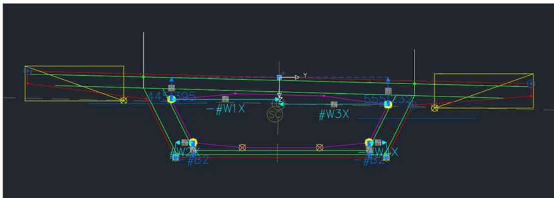
Εικόνα 200. Μεταβλητή πάχους κορμών (#W1X), (#W2X), (#W3X) και (#W4X).
