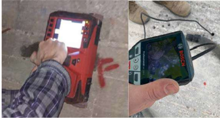
Εικόνα 17. Χρήση ακτινογράφιση οπλισμού (αριστερά) και χρήση ενδοσκόπησης (δεξιά).
