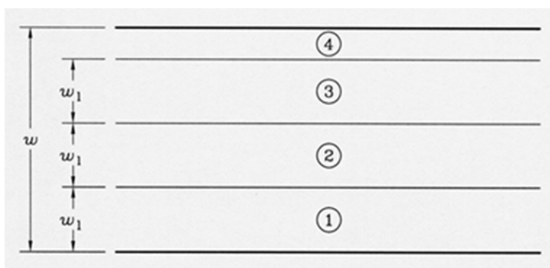
Πίνακας 9. Αριθμός και πλάτος των ονομαστικών λωρίδων κυκλοφορίας [EN1991-2(4)].
