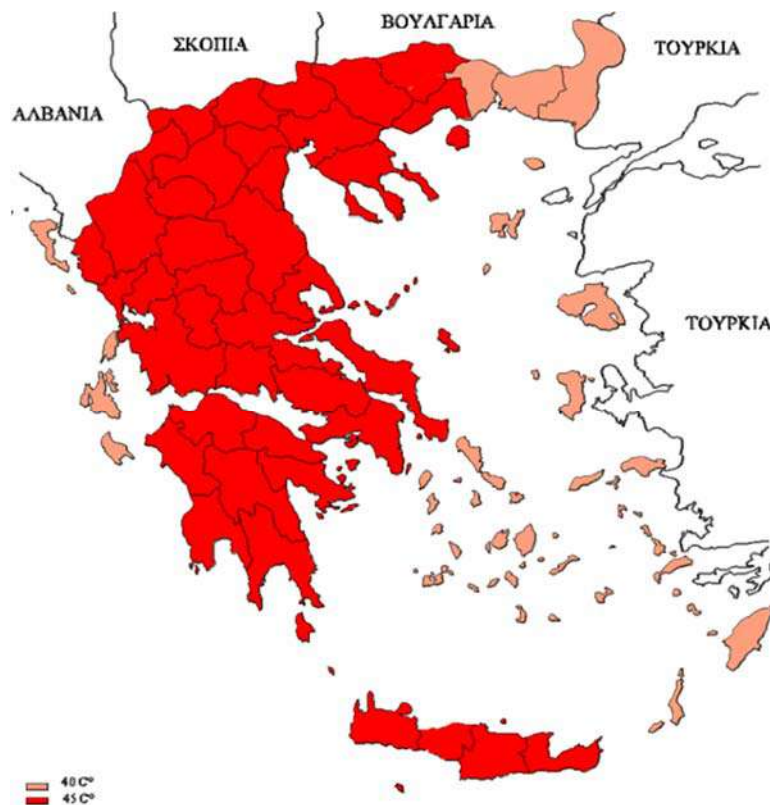
Εικόνα 76. Χάρτης μεγίστων θερμοκρασιών από σκιά, T_{max} (Standard, Eurocode 1 - Actions on structures 2002).
