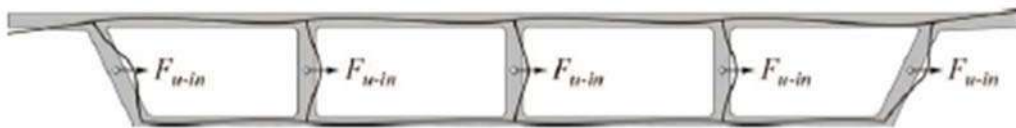
Εικόνα 177. Εγκάρσιες δυνάμεις προέντασης σε επίπεδο διατομής (Corven 2016).
