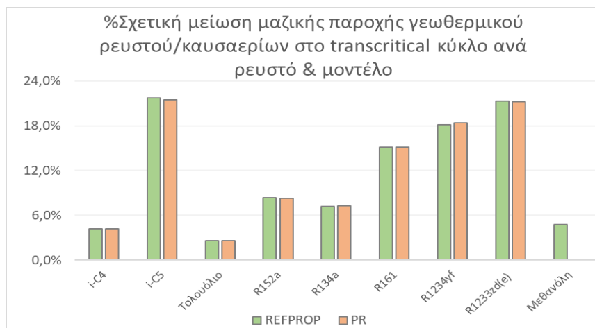
Σχήμα 6.3.7. %Σχετική μείωση της μαζικής παροχής του γεωθερμικού ρευστού/των καυσαερίων στο transcritical ORC σε σχέση με το υποκρίσιμο ανά ρευστό και ανά θερμοδυναμικό μοντέλο.
