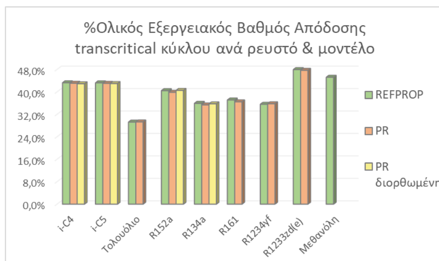
Σχήμα 6.2.2. Ολικός εξεργειακός βαθμός απόδοσης transcritical απλού ORC ανά εργαζόμενο μέσο και ανά θερμοδυναμικό μοντέλο.
