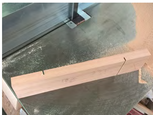
Σημάδεμα πριστοτεμαχίου για τη δημιουργία των εγκοπών
