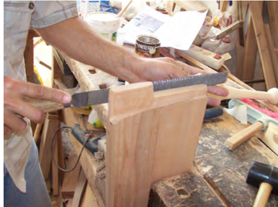
Διαδικασία επεξεργασίας τόρμου
