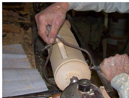
μέτρηση με παχύμετρο
