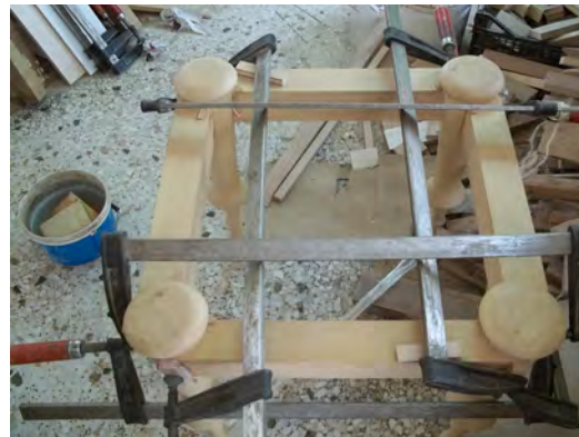
Η έδρα διαμορφώθηκε από 4 τεμάχια πριστής ξυλείας, τα οποία συναρμόστηκαν με μισοχάρακτο σύνδεσμο.
