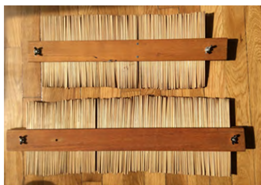
Κατασκευή ξύλινου προφιλόμετρου. Ηρώ Ψιλοπούλου
