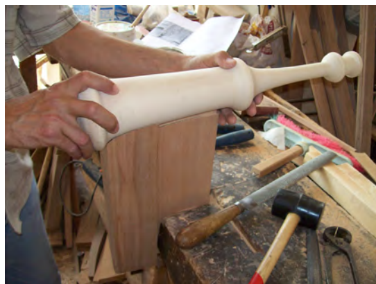
Δοκιμή σωστής συναρμογής ποδιού-διαδοκίδας.
