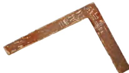
Εικόνα 156. Αιγυπτιακή ξυλουργική γωνία 90° σε σχήμα Γ με ανισομήκη ξύλινα σκέλη πλάτους 0,030 μ. και πάχους 0,004.
