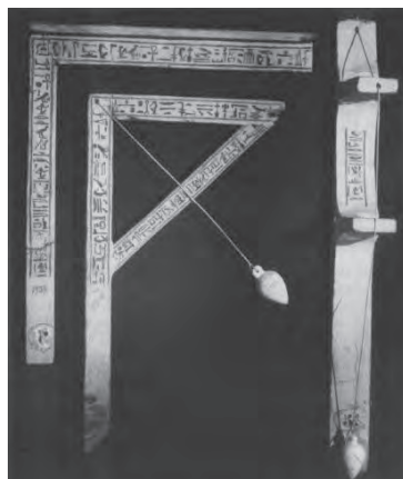
Εικόνα 159. Αιγυπτιακή μετρητική γωνία του 1300 π.Χ. σε συνδυασμό με νήμα της στάθμης. Παρόμοια εργαλεία ήταν γνωστά από τον Ραμσή, διαστάσεων 31,6X23,9
