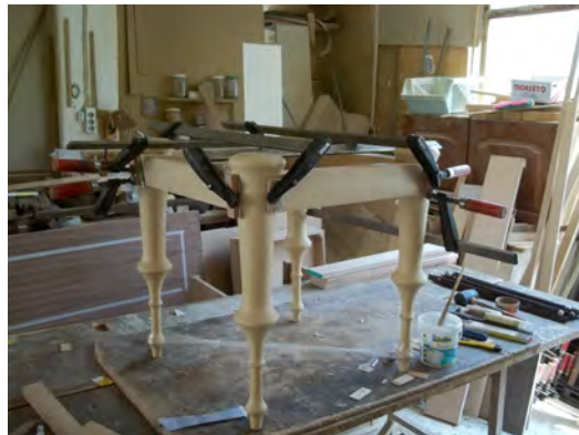
Η έδρα διαμορφώθηκε από 4 τεμάχια πριστής ξυλείας, τα οποία συναρμόστηκαν με μισοχάρακτο σύνδεσμο.
