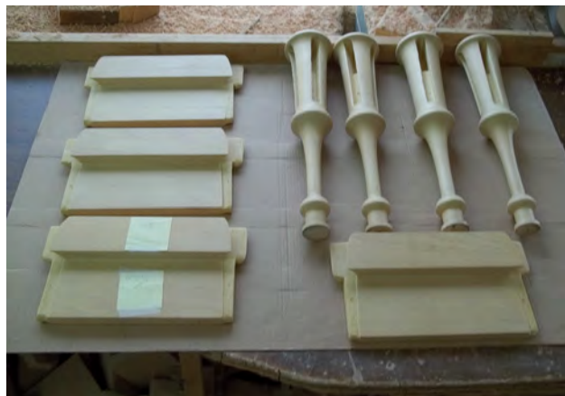
Δοκιμή σωστής συναρμογής ποδιού-διαδοκίδας.
