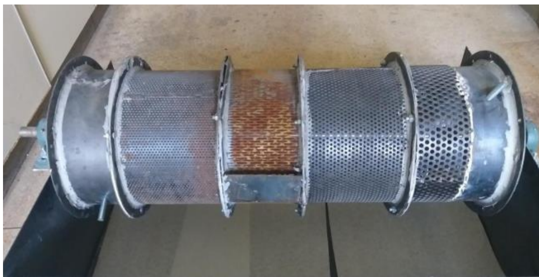
Εικόνα 15. Περιστρεφόμενο κυλινδρικό κόσκινο Trommel.
