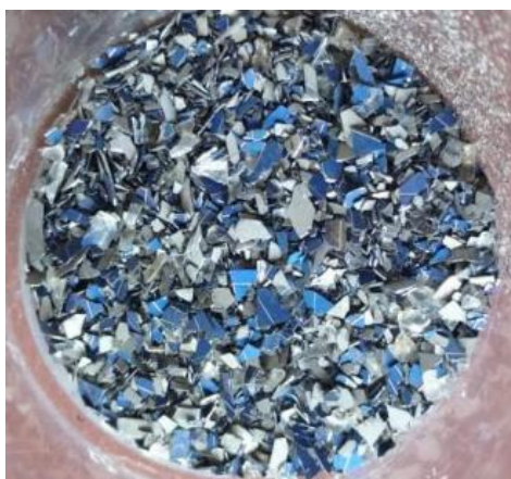
Εικόνα 21. Κομμάτια πυριτίου μετά την έκλυση με νερό και ακετόνη.
