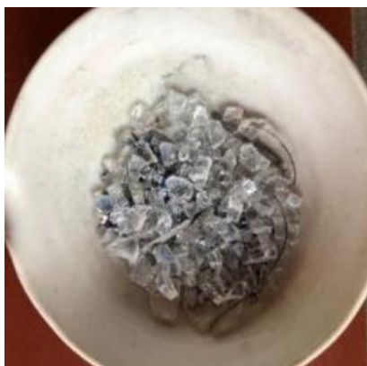
Εικόνα 19. Κομμάτι φωτοβολταϊκού πάνελ ύστερα από έψηση στους 550°C για 30 min.
