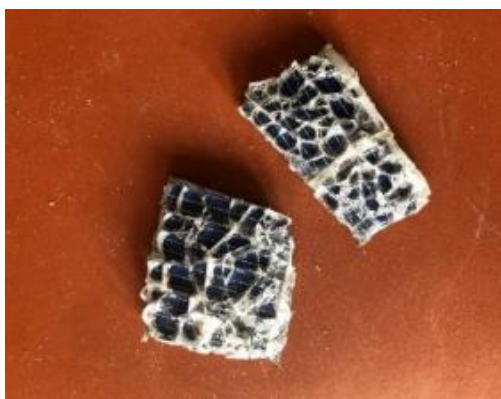
Εικόνα 14. Κομμάτια φωτοβολταϊκού πάνελ ύστερα από τεμαχισμό.
