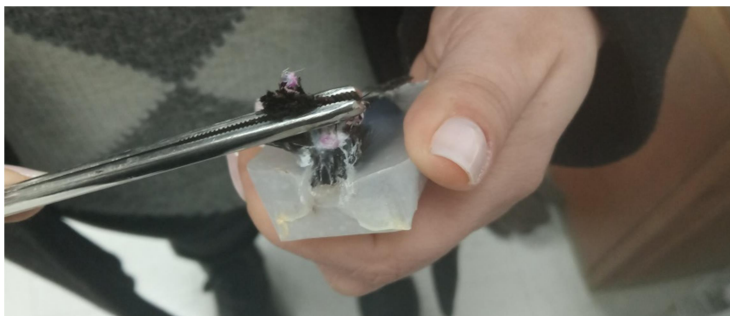
Εικόνα 4.4.2: Η απόπειρα εξαγωγής των ινών από το δείγμα. Αν και στις άκρες του δείγματος οι ίνες μπορούσαν να απομακρυνθούν δε συνέβη το ίδιο και στο κέντρο του.
