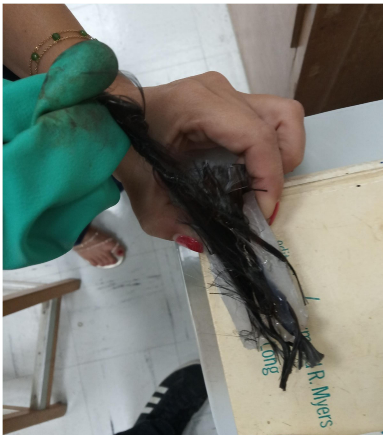
Εικόνα 4.4.3: Η επίτευξη της εξαγωγής των ινών από το δείγμα. Αξίζει να σημειωθεί ότι υπάρχει μια διαφορά χρόνου από τη στιγμή που βγάζεις το δείγμα από τη γεννήτρια μέχρι τη στιγμή που επιχειρείται η εξαγωγή των ινών, συνεπώς το πολυμερές να στερεοποιείται ελαφρώς και να μην διευκολύνεται η διαδικασία.
