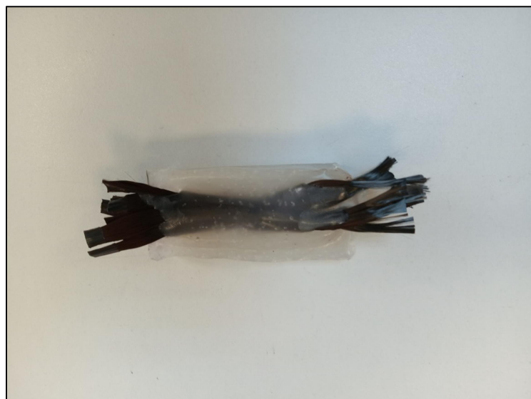
Εικόνα 3.5.2: Το τελικό παραλληλεπίπεδο δείγμα συνθέτου αφού αφαιρεθεί από το καλούπι.
