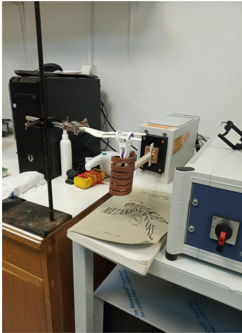
Εικόνα 3.6.1: Η γεννήτρια μαγνητικού πεδίου TrueHeat HF 5010 TRUMPF. Μέσα στο πηνίο είναι στερεωμένο το δείγμα του συνθέτου
