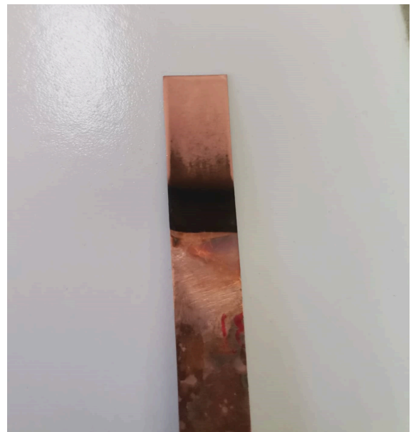
Σχήμα 6.3: Οπίσθια πλευρά δείγματος ηλεκτροδίου CuO που έχει φθαρεί μετά από ποτενσιοστατικό πείραμα οξείδωσης διαλύματος NaOH 0.5 M, γλυκόζης 20 mM σε δυναμικό E = +0.350 V για 21 ώρες
