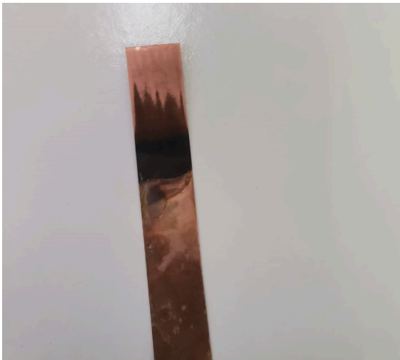
Σχήμα 6.2: Μπροστινή πλευρά δείγματος ηλεκτροδίου CuO που έχει φθαρεί μετά από ποτενσιοστατικό πείραμα οξείδωσης διαλύματος NaOH 0.5 M, γλυκόζης 20 mM σε δυναμικό E = +0.350 V για 21 ώρες
