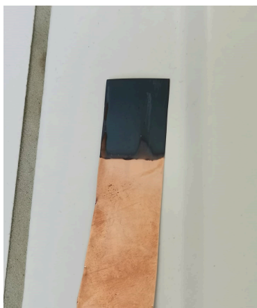
Σχήμα 2.5: Δείγμα ηλεκτροδίου \text{Cu}(\text{OH})_2 μετά από γαλβανοστατική οξείδωση
