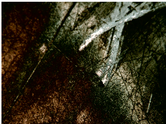
Σχήμα 2.13: Δείγμα λείου ηλεκτροδίου CuO που έχει φθαρεί περιφερειακά σε x10 μεγέθυνση
