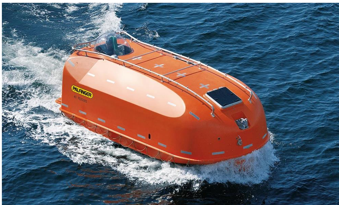
Εικόνα 1.3.3.1: Πλήρως κλειστή σωσίβια λέμβος.
