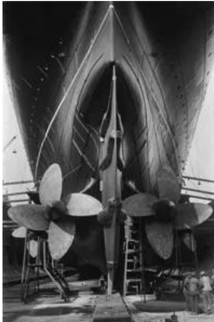
Εικόνα 1.3.5.1: Οι προπέλες διπλέλικου επιβατηγού πλοίου.
