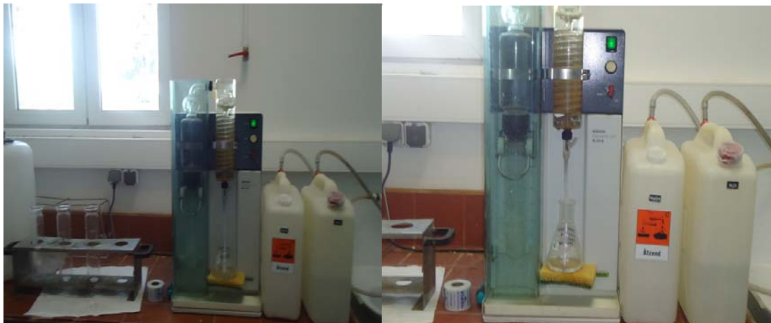
Εικόνα 3.17: Ειδικοί κύλινδροι και συσκευή απόσταξης αμμωνίας τύπου BÜCHI
