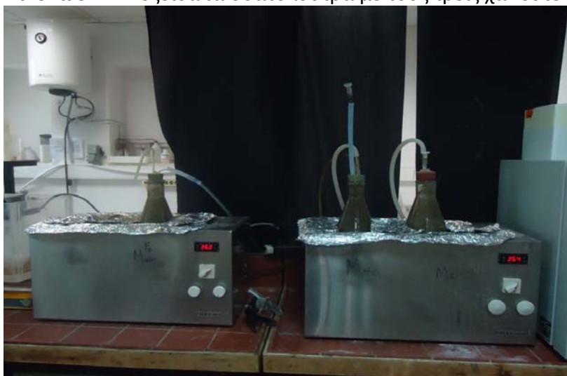
Εικόνα 3.1: Ανοξείδωτα υδατόλουτρα με τους τρεις χωνευτές
