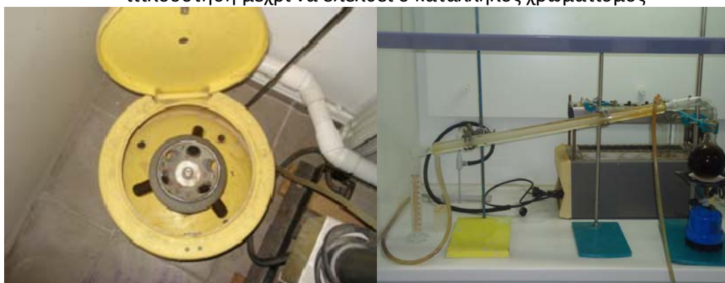
Εικόνα 3.16: Μέτρηση VFAs, από αριστερά προς δεξιά: φυγοκέντριση, απόσταξη, τιτλοδότηση μέχρι να επέλθει ο κατάλληλος χρωματισμός
