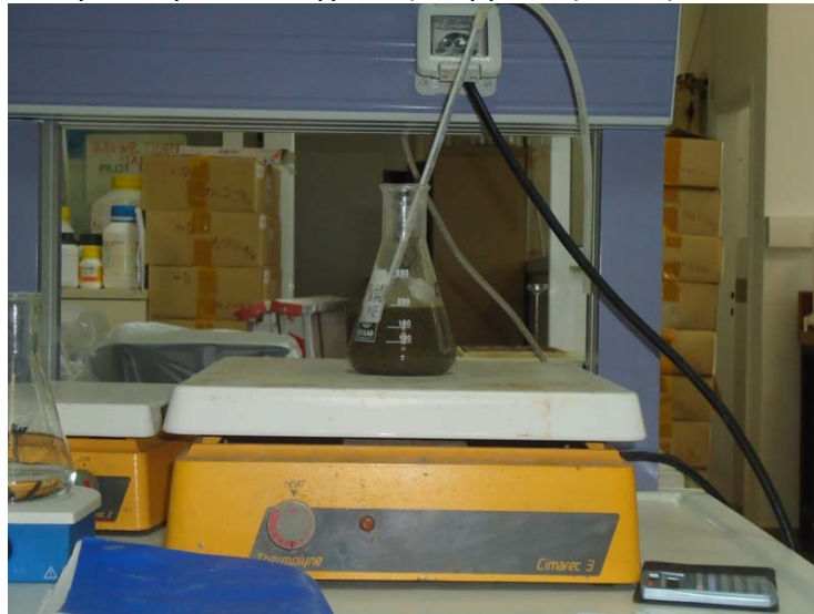
Εικόνα 3.13: Προετοιμασία δείγματος: Θέρμανση στους 37 °C και ανάδευση
