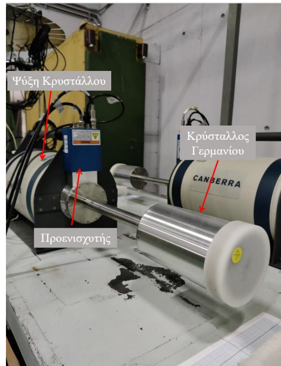
Εικόνα 3.4: Ο ανιχνευτής Γερμανίου και η ψύξη του
