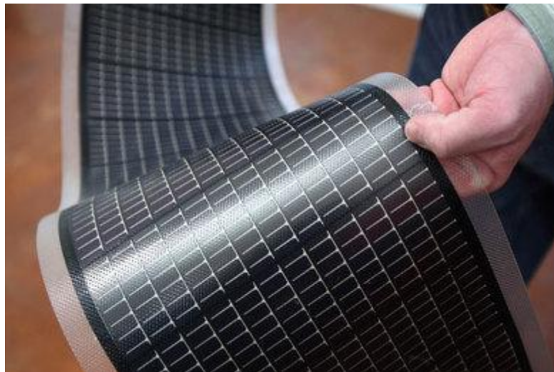
Εικόνα 2.3 Η ερευνητική ομάδα του Πανεπιστημίου του Μισούρι ανέπτυξε ένα λεπτό, εύκαμπτο φύλλο νανοκεραιών (nantennas), οι οποίες εκτός από το φως, μπορούν ακόμα να συλλέγουν τη θερμότητα που παράγεται από βιομηχανικές διαδικασίες και την μετατρέπουν άμεσα σε ηλεκτρική - Περιοδικό Journal of Solar Energy Engineering .
