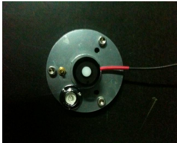
Εικόνα 6.6 Πυρανόμετρο για μέτρηση ακτινοβολίας
