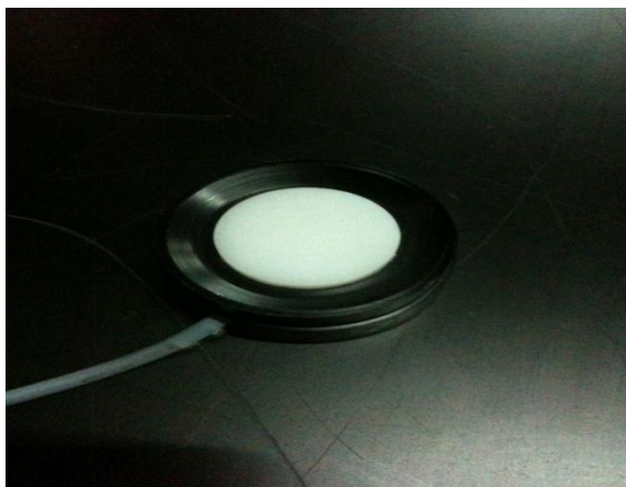
Εικόνα 6.4 Λουξόμετρο για μέτρηση φωτεινής έντασης.
