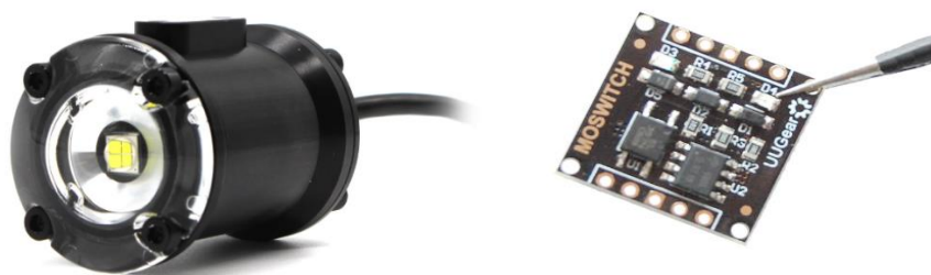
Σχήμα 3.9: Αριστερά: Lumen Subsea Light for ROV/AUV. Δεξιά: ο διακόπτης MOSWITCH-SPDT, Πηγή : https://bluerobotics.com
