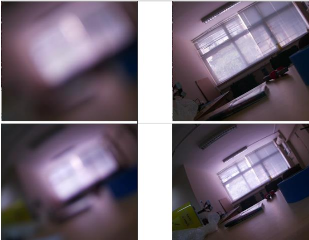
Σχήμα 3.29: Παραδείγματα με σωστό και λάθος εστίαση με διαφορετικά ζουμ
