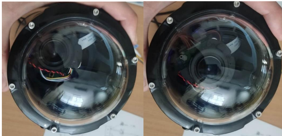
Σχήμα 3.26: Αριστερά: Η κάμερα έρχεται σε επαφή με το περίβλημα της. Δεξιά: Η κάμερα βρίσκεται στην σχετική κεντρική της θέση.
