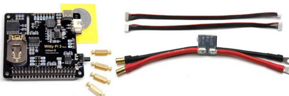
Σχήμα 3.6: Αριστερά: Witty Pi 3 REV2. Δεξιά: ο αισθητήρας Power Sense Module. Πηγή : https://bluerobotics.com/
