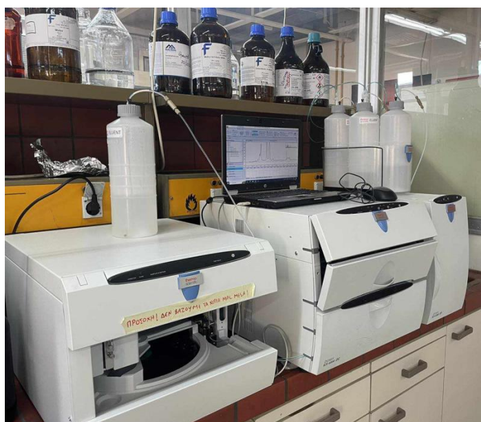
Εικόνα 14. Διάταξη χρωματογραφίας ανταλλαγής ανιόντων υψηλής απόδοσης με αμπερομετρική παλμική ανίχνευση (HPAEC-PAD).
