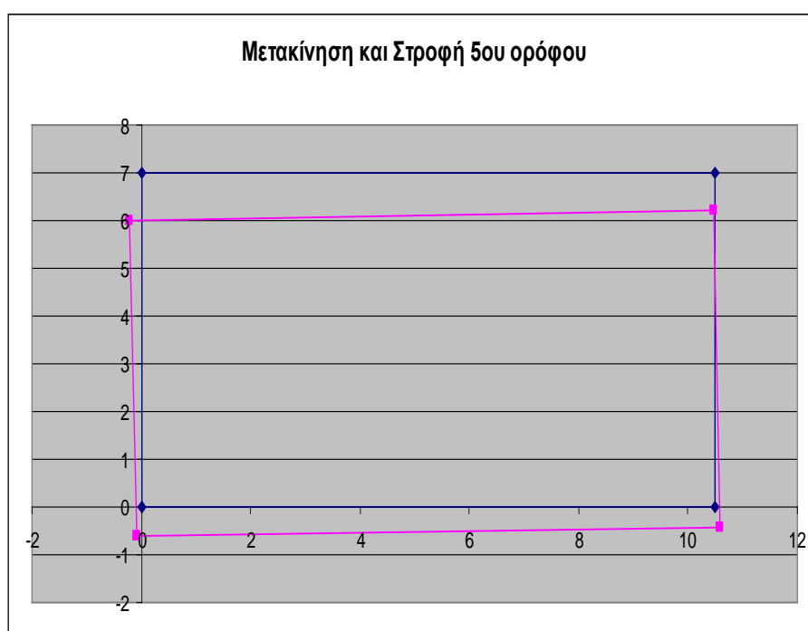
Σχ. 5.24: Μετακίνηση και στροφή 5 ου ορόφου
