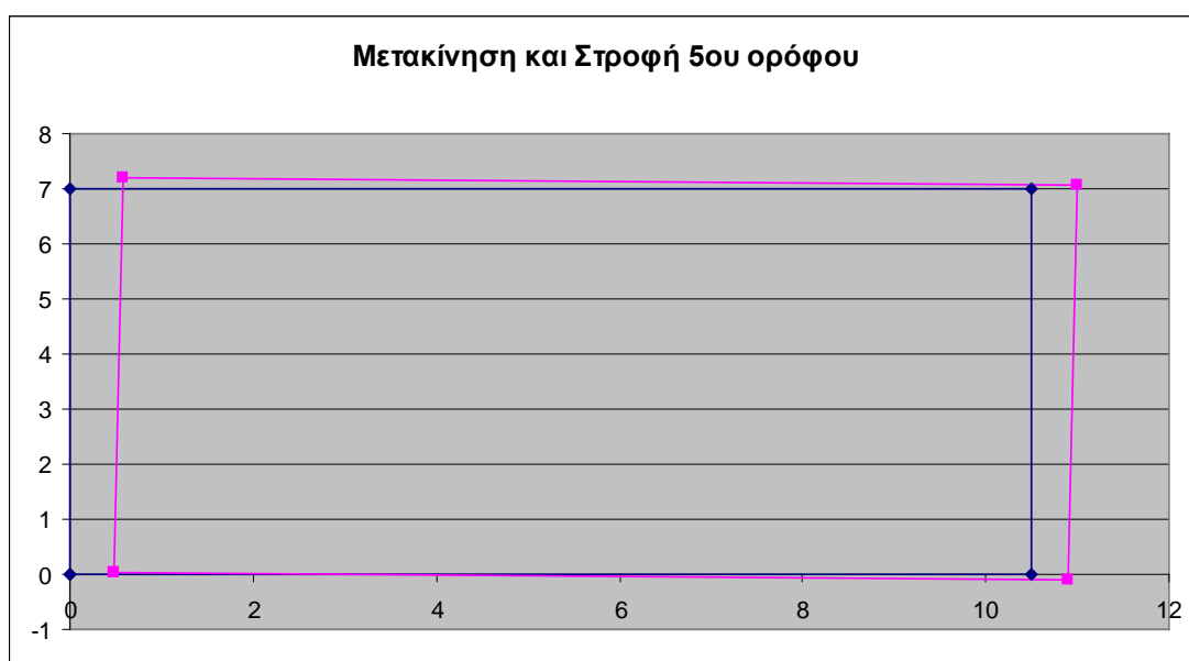
Σχ.4.32: Μετακίνηση και στροφή 5 ου ορόφου
