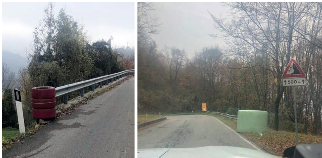
Σχήμα 4.23. Διαφορετικοί τύποι προστατευτικών διατάξεων που μπορούν να τοποθετηθούν στα άκρα εκτεθειμένων προστατευτικών στηθαίων [8].
