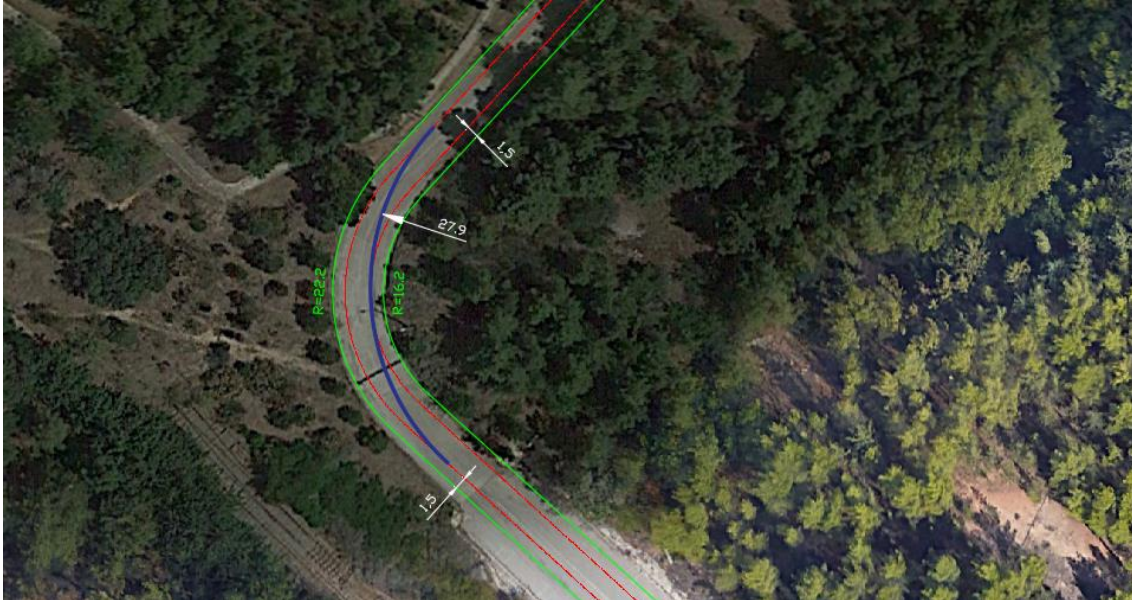
Σχήμα 10.8. Γεωμετρικός προσδιορισμός της ακτίνας στροφής του οχήματος.
