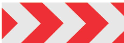
Σχήμα 5.7. Πινακίδα (zebra / chevron) - χρησιμοποιείται διεθνώς για την επισήμανση και την εύκολη αναγνώριση της αγωνιστικής πορείας, συνδυαζόμενη με αντιστοίχου χρώματος ταινίες καθοδήγησης [8].
