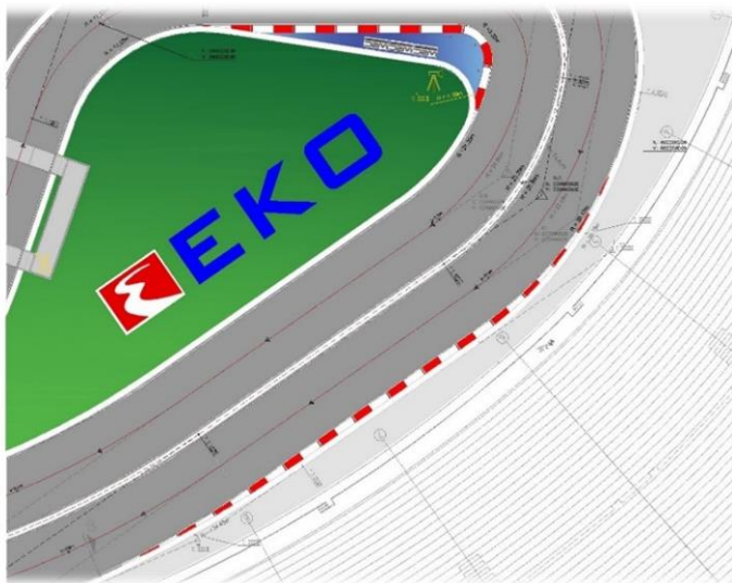
Σχήμα 9.3. Περίπτωση τοπικής διευρύνσης κατά την έξοδο της κανιστροειδούς στροφής των κορυφών K16 και K17, μέγιστου πλάτους 0.75m διατηρούμενο για μήκος 21,5m.
