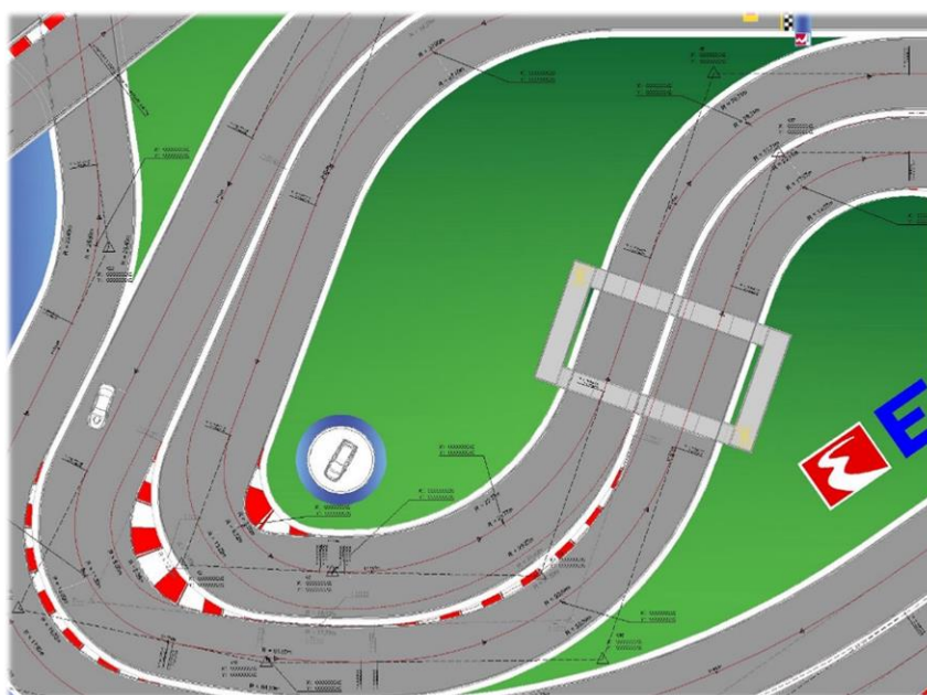
Σχήμα 9.2. Το σύμπλεγμα των εσωτερικών στροφών της διαδρομής διαθέτει μεταβλητό καθαρό πλάτος οδοστρώματος σε επιλεγμένα σημεία, αυτό γίνεται ορατό εάν παρατηρήσει κανείς την αξονική γραμμή και τις εκατέρωθεν αυτής κόκκινες γραμμές επισημάνσεις του τυπικού πλάτους των 7.00m.
