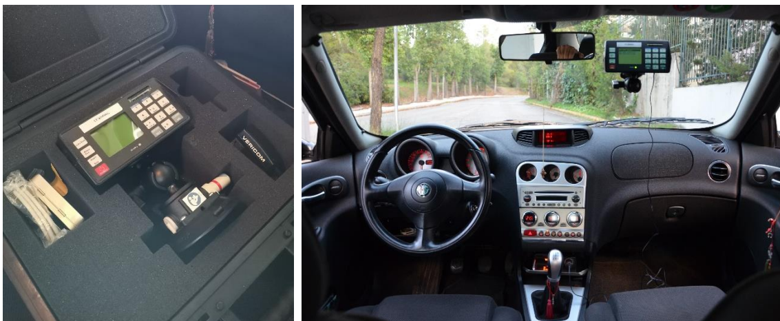
Σχήμα 10.8. Αριστερά το VERICOM VC4000FG με τη βαλίτσα μεταφοράς του και δεξιά κατάλληλα τοποθετημένο στον ανεμοθώρακα του αυτοκινήτου δοκιμής ώστε να μην ενοχλεί τον οδηγό αλλά ταυτόχρονα να μπορεί και να το χειριστεί.
