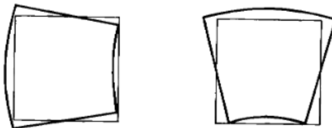
Εικόνα 16. Παραμόρφωση στοιχείου επίπεδης έντασης σε κάμψη [20]
