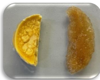
Εικόνα 26: Υδρογέλες κατά τη διαδικασία του swelling μέσα σε ρυθμιστικά διαλύματα
