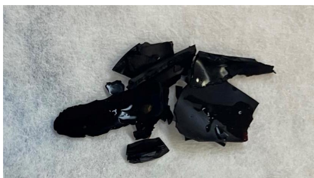
Εικόνα 33: Αποσχηματισμός Υδρογέλης που έχει ξηραθεί σε φούρνο
