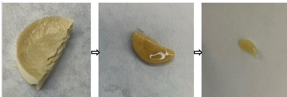
Εικόνα 32: Συρρίκνωση Υδρογέλης με ελάχιστη ποσότητα χιτοζάνης κατά τη διαδικασία του Swelling
