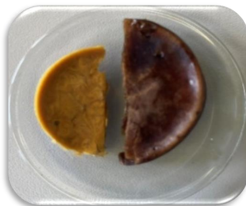
Εικόνα 31: Ικανότητα διόγκωσης Υδρογέλης κεντρικού σημείου και αλλαγή χρώματος – αντίδραση MR
