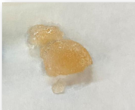
Εικόνα 38: Διογκωμένη υδρογέλη που υποβλήθηκε σε ρεολογικές μετρήσεις με 10% OLE - NADES, 12.5% w/v CS (20-100 cps) και 3% w/v Tween 80
