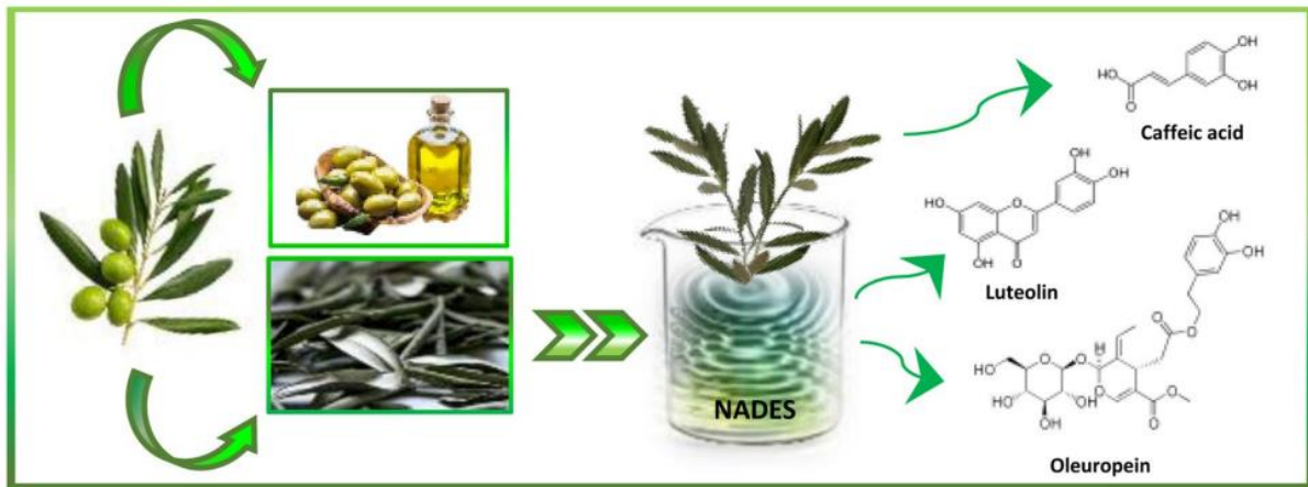
Εικόνα 9: Εκχύλιση φύλλων ελιάς με NADES προς την ανάκτηση βιοδραστικών ενώσεων [32]
