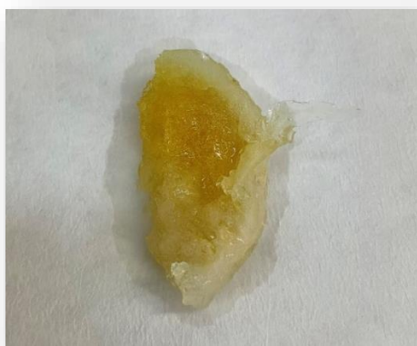
Εικόνα 35: Διογκωμένη Υδρογέλη με 10% v/v OLE - Extract & 10% w/v CS (20-100cps) & 3% w/v Tween 80
