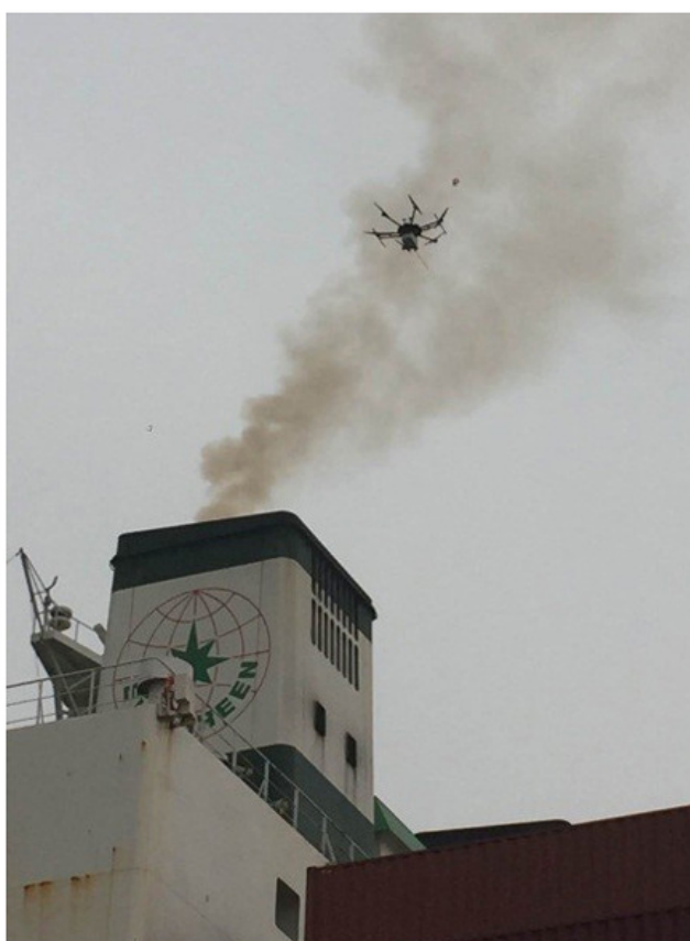
Εικόνα 5.1: Χρήση μη-επανδρωμένου αεροσκάφους για την επιτήρηση των εκπομπών SOx. 4
