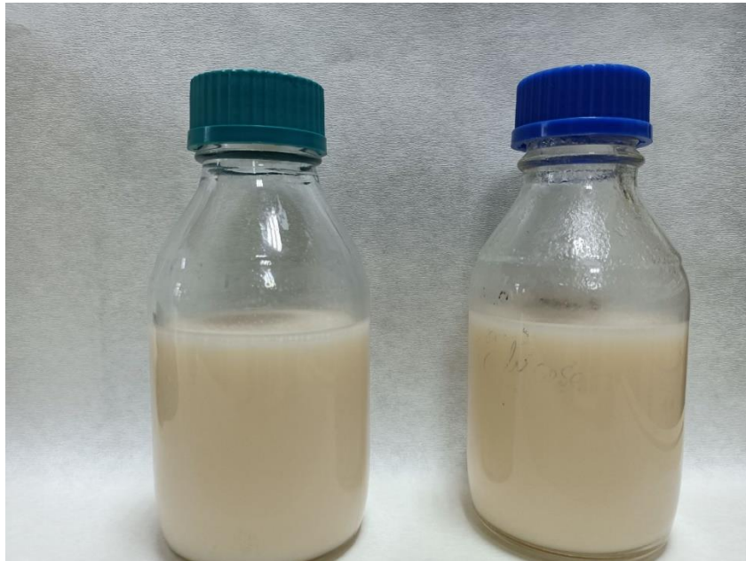
Εικόνα 11: Τα ομογενοποιημένα διαλύματα των καλλιιεργειών MM με τα αλκάνια (αριστερά) και των καλλιιεργειών ελέγχου με το C_{16} (δεξιά), έπειτα από τη συσκευή υπερήχων.
