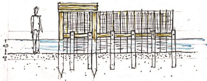
Χαρακτηριστική τομή της θεμελίωσης των καλαμωτών
