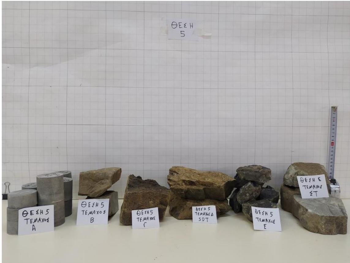
Σχήμα 65. Δοκίμια εργαστηριακών δοκιμών από την θέση έρευνας.
