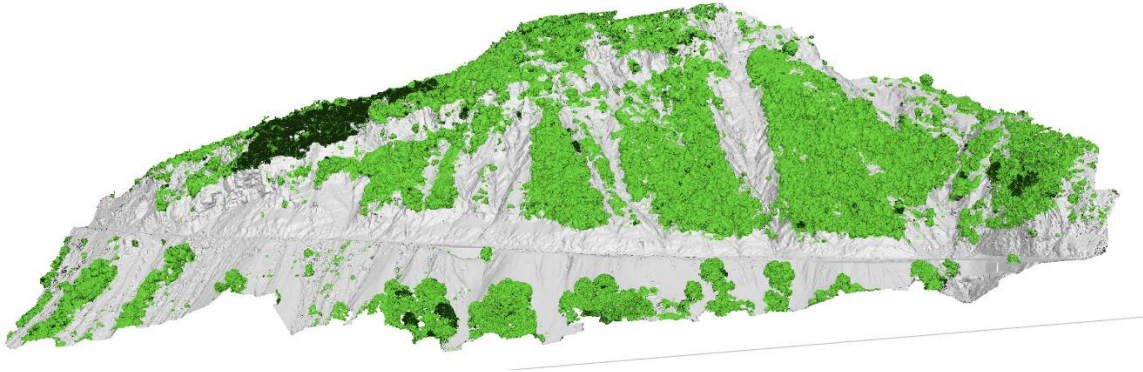
Σχήμα 44. Ταξινόμηση νέφους σημείων. Κατηγοριοποίηση βλάστησης – βραχώμαζας στην θέση έρευνας
