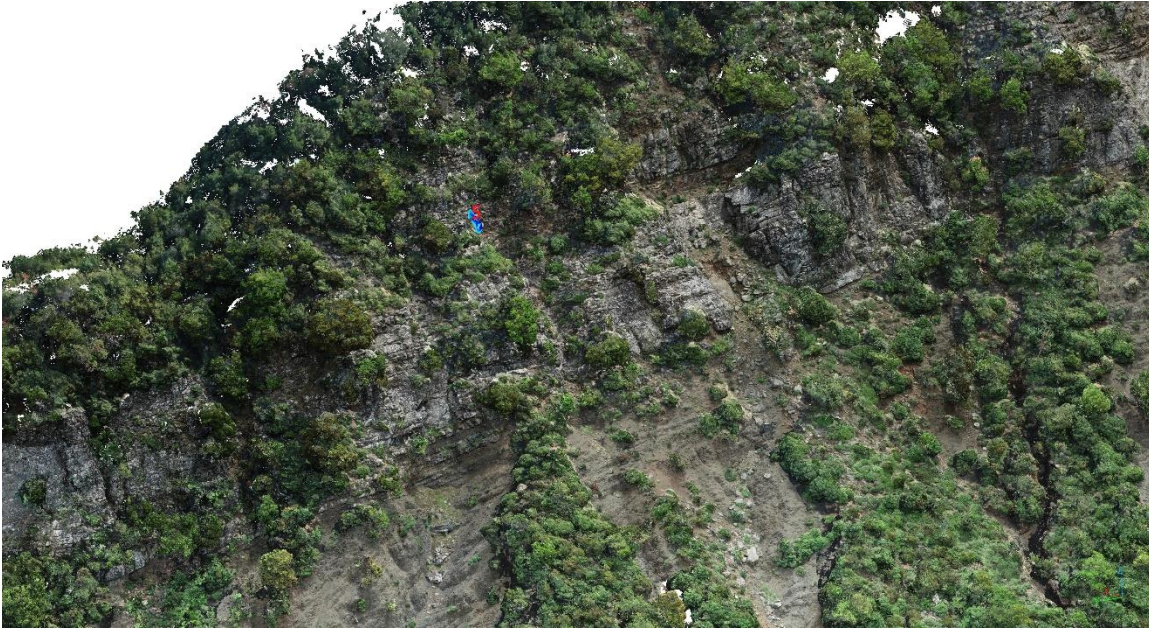
Σχήμα 98. Ανίχνευση μεταβολών στο κεντρικό και ανάντη τμήμα του πρανούς για τη χρονική περίοδο Οκτωβρίου 2021 – Μαΐου 2023. Οι μεταβολές αποτυπώνονται, με ψυχρά χρώματα (μπλε), απώλεια υλικού
