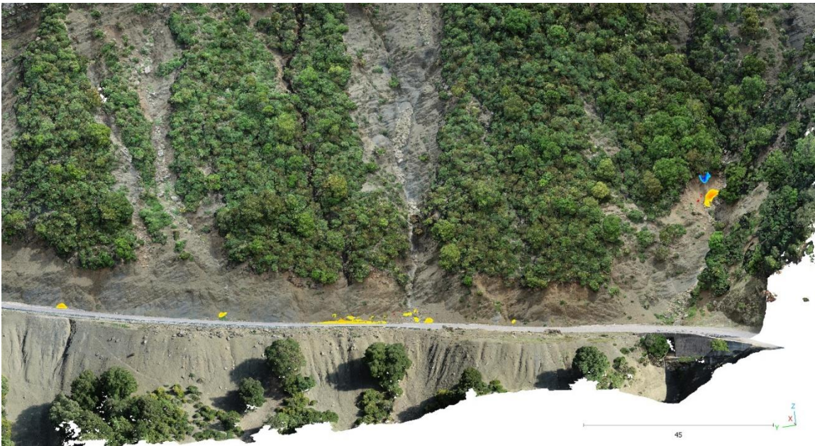
Σχήμα 99. Ανίχνευση μεταβολών στο νοτιοδυτικό τμήμα του πρανούς για τη χρονική περίοδο Οκτωβρίου 2021 – Μαΐου 2023. Οι μεταβολές αποτυπώνονται, με ψυχρά χρώματα (μπλε), απώλεια υλικού, και με θερμότερα χρώματα (κίτρινα), προσθήκη υλικού
