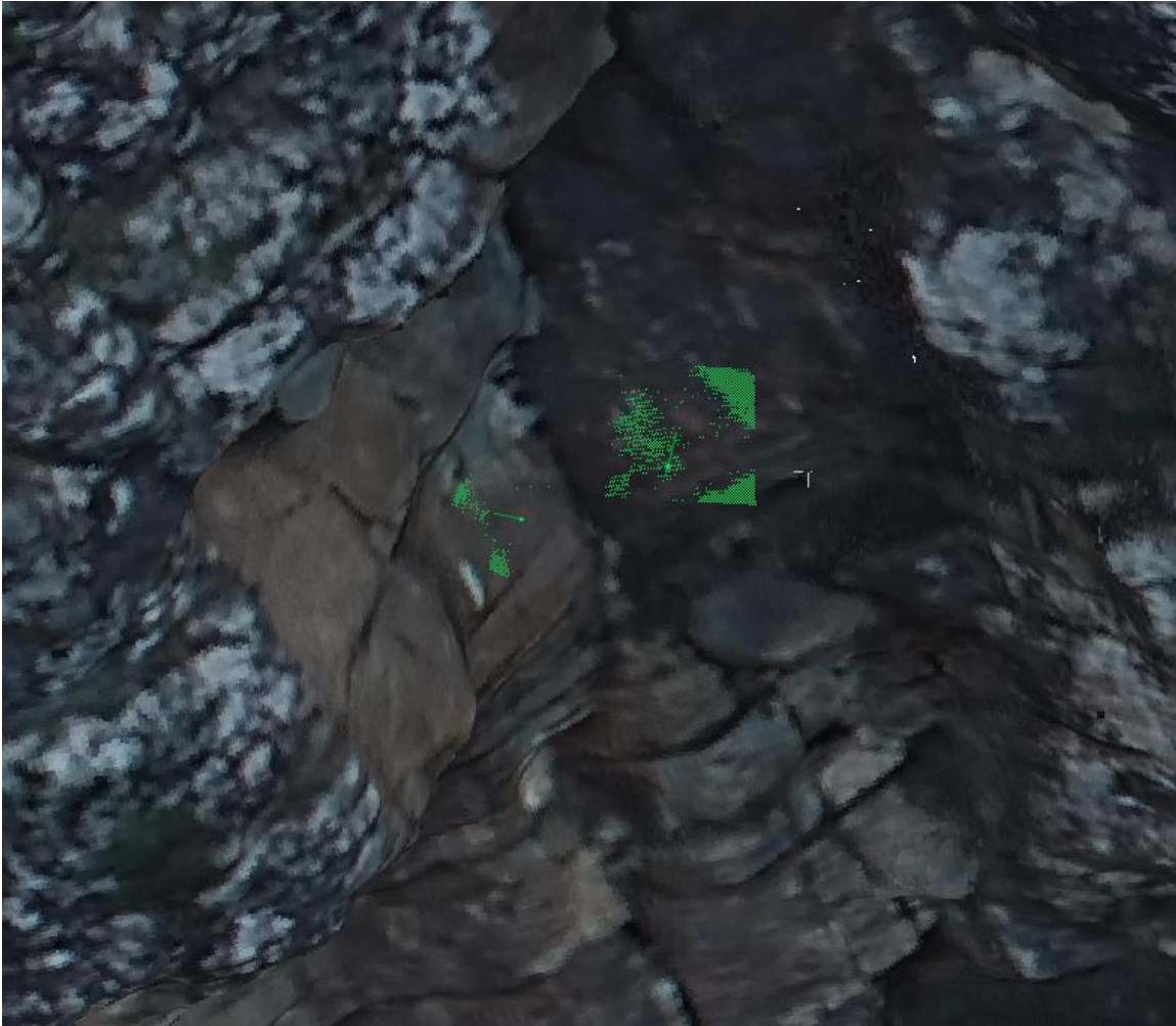
Σχήμα 81. Επίπεδα ασυνεχειών J1 και J2 στο τμήμα που εκτιμήθηκε η μέγιστη βραχοκατάπτωση
