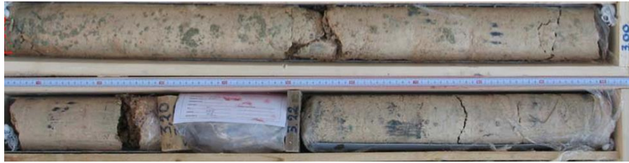
Σχήμα 4. 13 Γεωλογική Ενότητα 3 από την Γεώτρηση CATP5.
