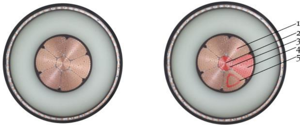
Εικόνα 2. Διατομή καλωδίου με αγωγό τύπου Milliken. (1) πυρίνας τμήματος/μονός αγωγός, (2) πυρίνας καλωδίου, (3) πυρίνας αγωγού, (4) τμήμα μορφής πίτας, (5) στρώση τμήματος.
