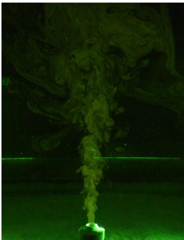
Σχήμα 3.19 Στρωμάτωση του αποδέκτη
