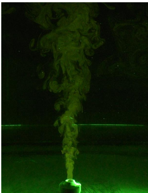
Σχήμα 3.18 Φωτογραφία τη στιγμή που οι στρόβιλοι ρευστού που έχει ήδη παροχετευτεί εισέρχονται στη φλέβα
