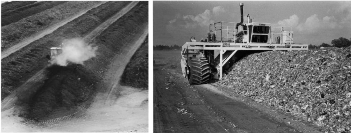
Εικόνα 8. Τυπική διάταξη οριζόντιου ανοιχτού συστήματος κομποστοποίησης, τύπου αναστρεφόμενων σειραδίων (Diaz et al., 2002)
