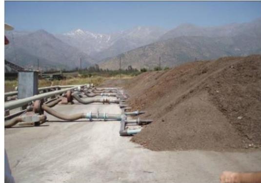
Εικόνα 9. Τυπική διάταξη οριζόντιου ανοιχτού συστήματος κομποστοποίησης, τύπου αεριζόμενων στατικών σωρών (Diaz et al., 2002)
