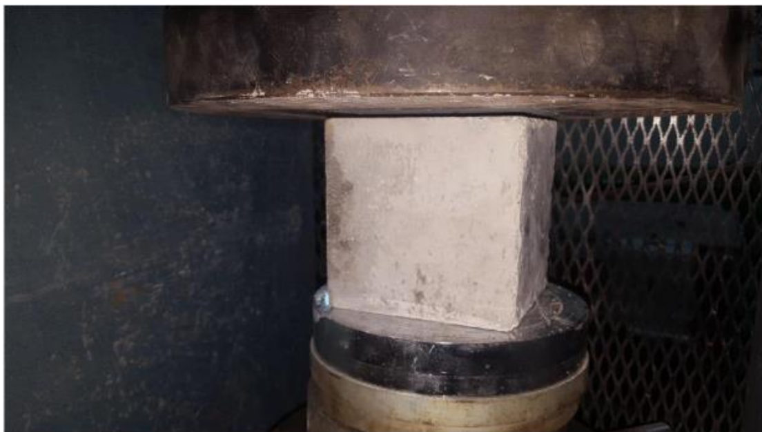
Εικόνα 4.1: Διαδικασία θραύσης του δοκιμίου με σκοπό τον προσδιορισμό της θλιπτικής αντοχής f_c
