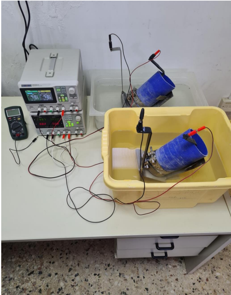
Εικόνα 4.3: Ηλεκτρική διάταξη δοκιμής NT 492
