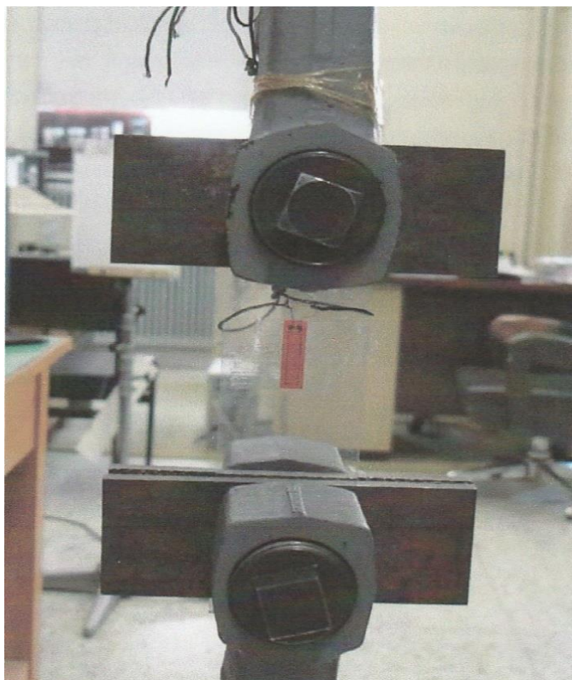
Εικόνα 4.5 Ηλεκτρομηκυνσιόμετρα που είναι προσκολλημένα στο δοκίμιο
