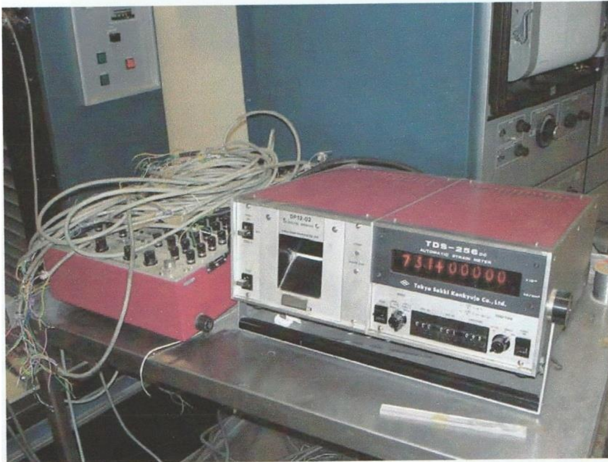
Εικόνα 4.6 Βαθμονομημένη γέφυρα Wheatstone που συνδέεται με τα ηλεκτρομηκυσιόμετρα του δοκιμίου
