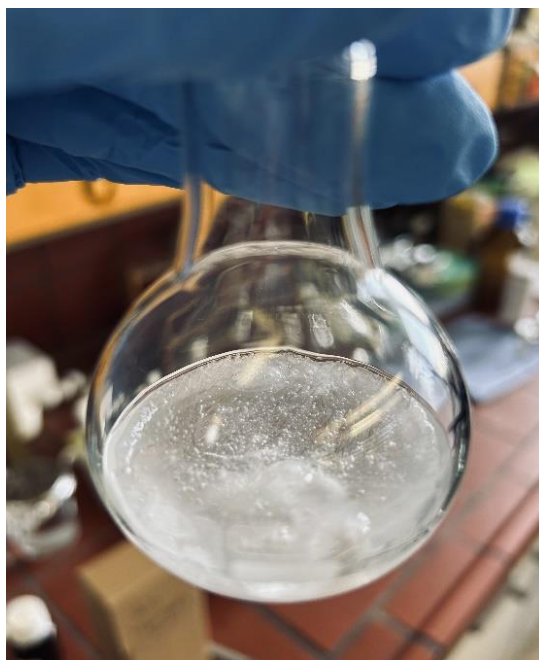
Εικόνα 20: Διασπορά σε ξηρή μορφή τοποθετημένη σε σφαιρική φιάλη των 50 mL με 20 mL αιθανόλη
