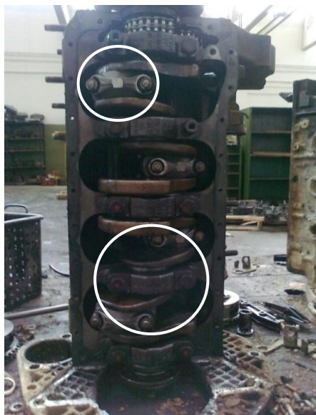
Εικόνα 2.27 Αριστερά διακρίνονται τα καβαλέτα των διωστήρων (πάνω) και στροφαλοφόρου άξονα (μέση), μέσα σε κύκλους. Δεξιά και μέσα στον κύκλο, οι δύο μαύρες γραμμές επισημαίνουν ότι πρόκειται για τον 2ο διωστήρα.
