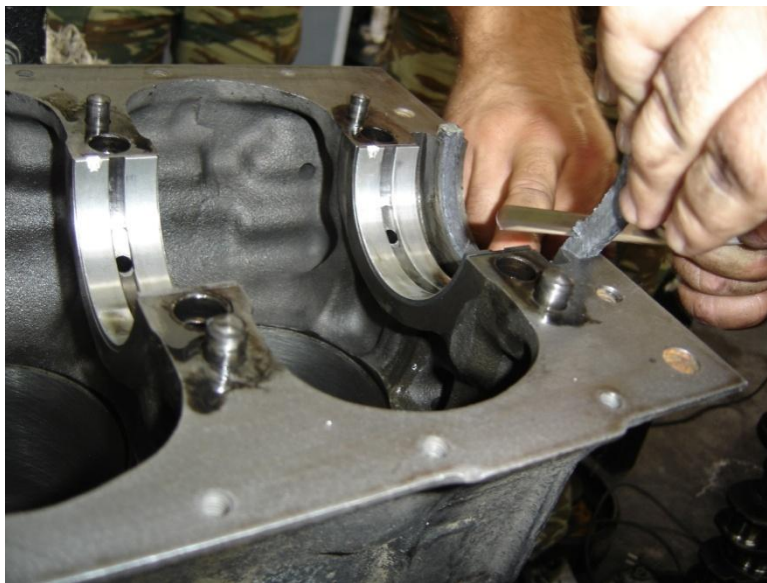
Εικόνα 2.130 Τοποθέτηση και κοπή της σαλαμάστρας.
