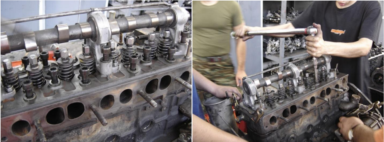
Εικόνα 2.158 Στην αριστερή φωτογραφία απεικονίζονται κάποιοι κοχλίες τις κυλινδροκεφαλής. Στη δεξιά φωτογραφία σύσφιξη με το δυναμόκλειδο.
