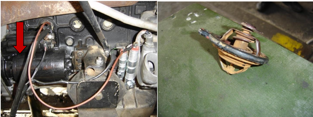
Εικόνα 2.178 Στην αριστερή φωτογραφία απεικονίζεται η σύνδεση των καλωδίων της μίζας (βέλος). Στη δεξιά φωτογραφία απεικονίζεται ο θερμοστάτης.
