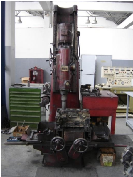
Εικόνα 2.37 Εργαλειομηχανές boring (αριστερά) και honing (δεξιά)
