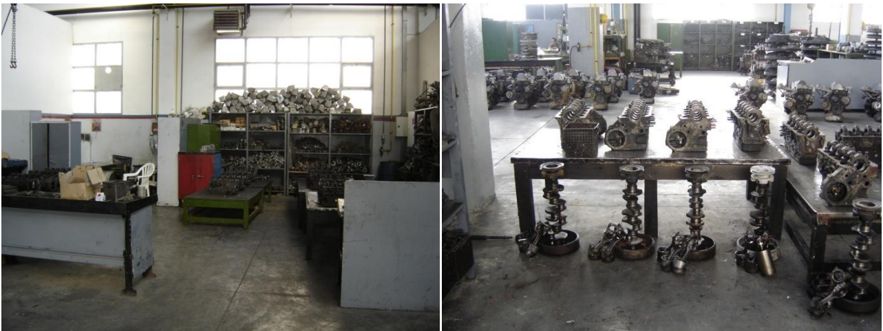
Εικόνα 2.115 Στην αριστερή φωτογραφία, άποψη των ραφιών με τα μέρη του κινητήρα. Στη δεξιά φωτογραφία, μπλοκ με "σετ" βολάν - διωστήρες - στροφαλοφόρους.
