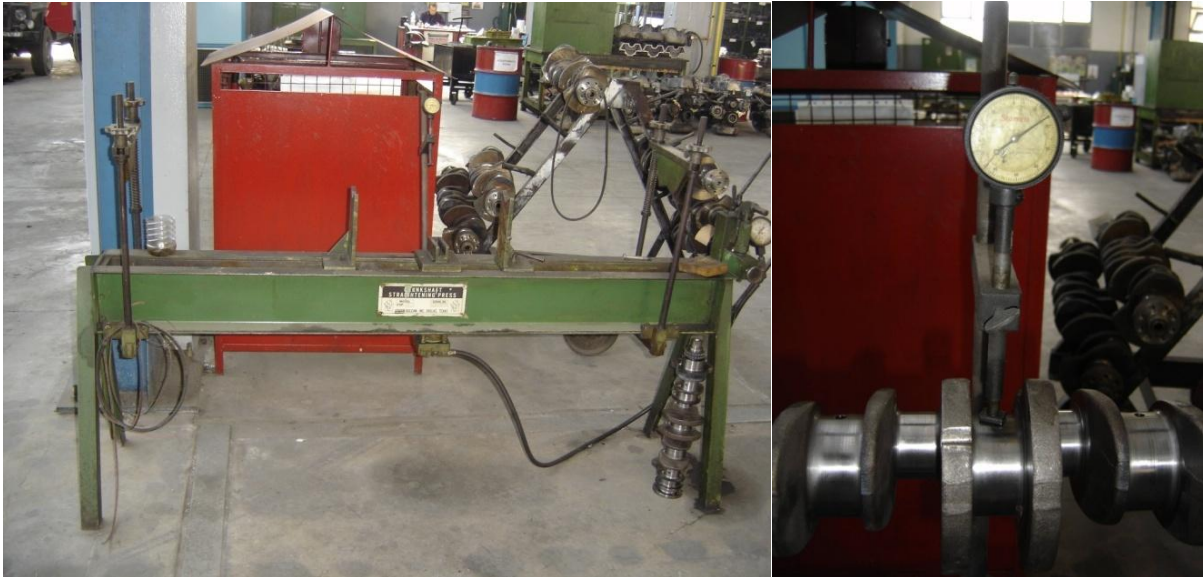
Εικόνα 2.100 Αριστερά η πρέσσα στην οποία εκτελείται ο έλεγχος της ευθύτητας του στροφαλοφόρου άξονα. Δεξιά το μετρητικό ρολόι με το οποίο ελέγχεται η απόκλιση από την ευθεία.
