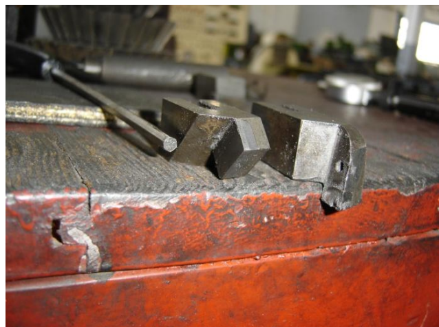
Εικόνα 2.49 Στην αριστερή φωτογραφία η μανιβέλα μετακίνησης πάνω-κάτω του άξονα της εργαλειομηχανής. Στην αριστερή φωτογραφία με τη σειρά κοπτικά εργαλεία δημιουργίας κλίσης και απότμησης.
