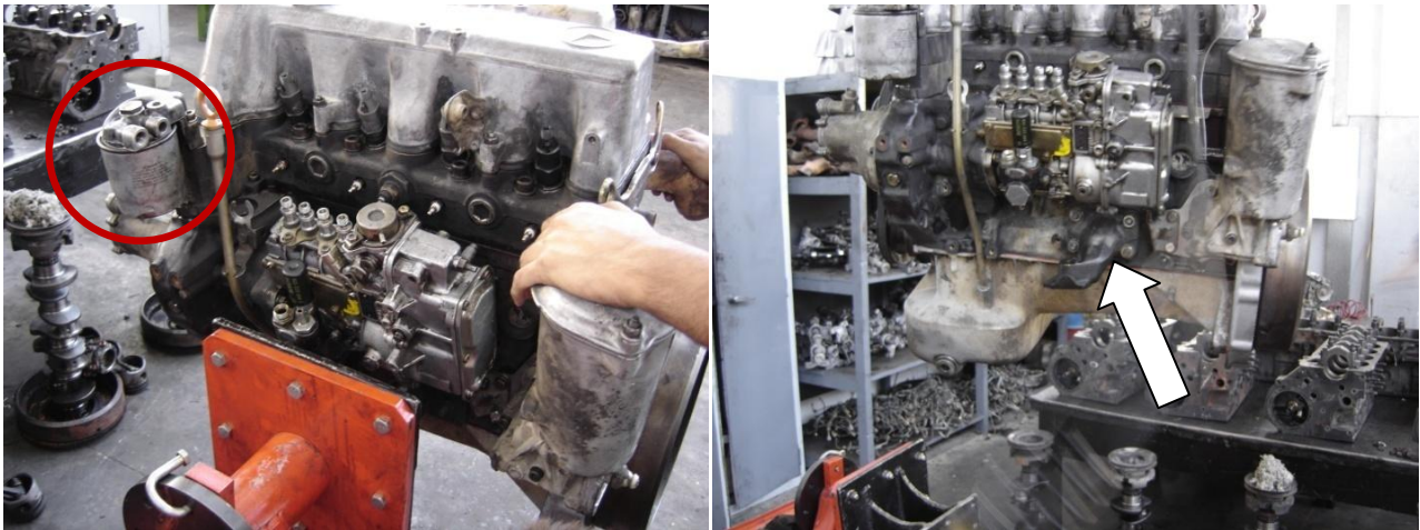
Εικόνα 2.172 Στην αριστερή φωτογραφία επισημαίνεται η βάση και το φίλτρο πετρελαίου. Επίσης, διακρίνεται η ΑΥΠ στη θέση της. Στη δεξιά φωτογραφία επιδεικνύεται η βάση του κινητήρα που κοχλιώθηκε τελευταία.
