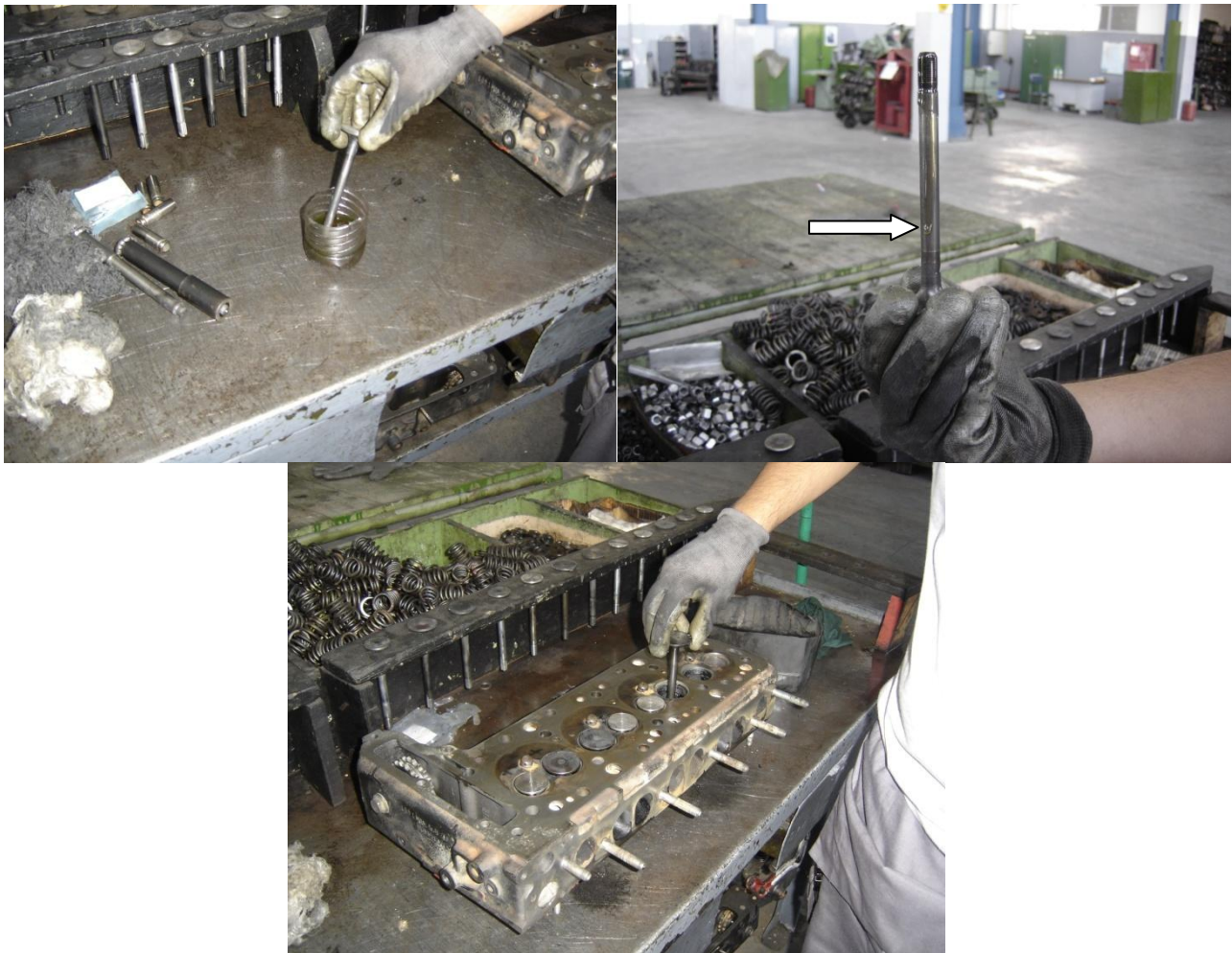
Εικόνα 2.89 Στιγμιότυπα από την τοποθέτηση των βαλβίδων. Αριστερά επάνω "βούτηγμα" στο λάδι. Δεξιά επάνω με βέλος επισημαίνεται το δάκρυ που σχηματίζεται όταν το λάδι ρέει. Κάτω τοποθέτηση βαλβίδων.
