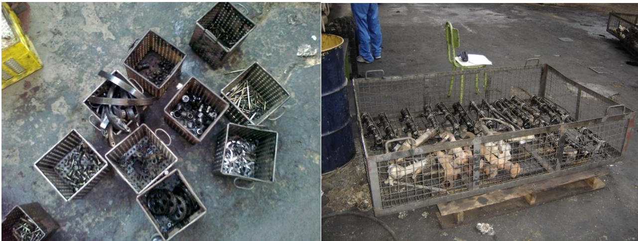
Εικόνα 2.2 Μικρά και μεγάλα διάτρητα καλάθια στα οποία συγκεντρώνονται τα εξαρτήματα προς πλύσιμο.
