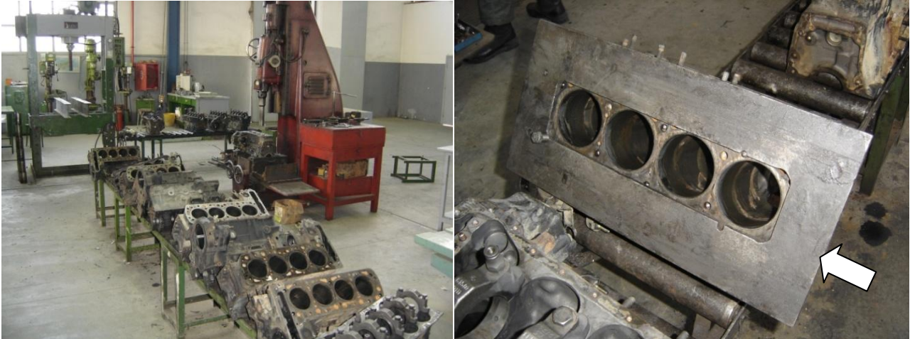
Εικόνα 2.40 Στην αριστερή φωτογραφία ο ραουλόδρομος αναμονής της πρέσας. Δεξιά φωτογραφία η ιδιοσυσκευή τοποθέτησης στην πρέσσα.
