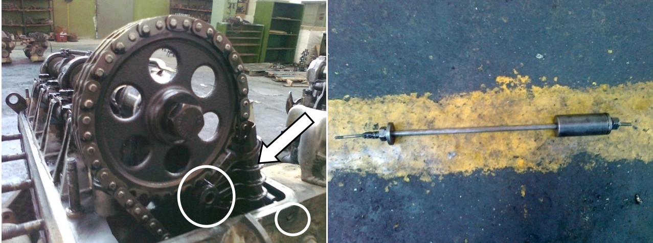
Εικόνα 2.13 Αριστερά διακρίνεται ο τριγωνικός οδηγός της αλυσίδας (βέλος), λίγο κάτω και δεξιά από την τροχαλία του εκκεντροφόρου άξονα. Σε κύκλους η βίδα (13) και ο πύρος συγκράτησης. Δεξιά φωτογραφία ο εξολκέας.
