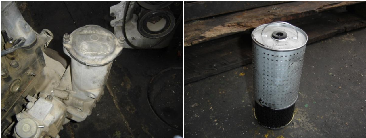
Εικόνα 2.5 Αριστερά η θήκη του φίλτρου λαδιού και δεξιά το στοιχείο του φίλτρου.
