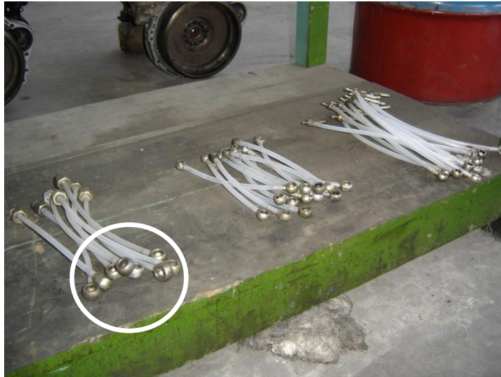
Εικόνα 2.58 Καινούργιες σωληνώσεις πετρελαίου. Σε κύκλο επισημαίνονται οι επαναχρησιμοποιούμενοι μαστοί.
