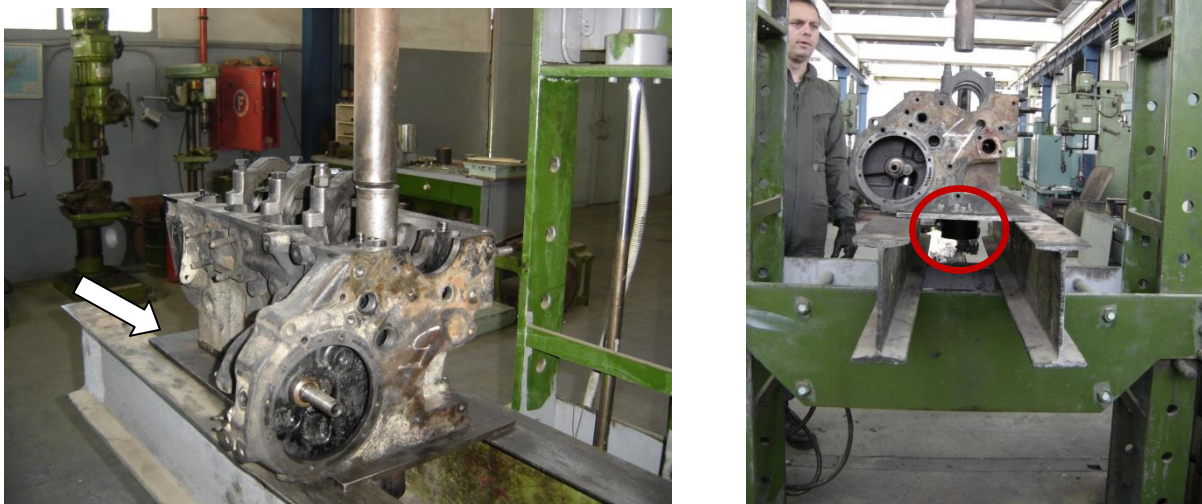
Εικόνα 2.41 Ξεπρεσάρισμα χιτωνίου. Με το λευκό βέλος επισημαίνεται η ιδιοκατασκευή στήριξης στην πρέσσα. Στην δεξιά φωτογραφία και μέσα σε κύκλο διακρίνεται το χιτώνιο που βγαίνει από τον κύλινδρο.
