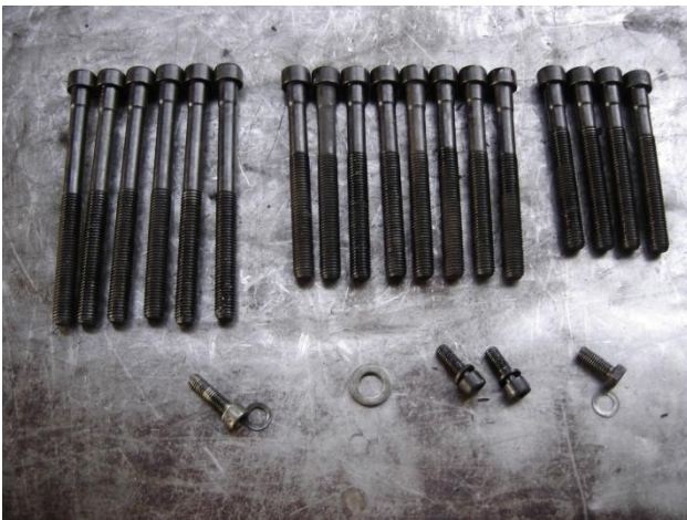
Εικόνα 2.159 Στην αριστερή φωτογραφία απεικονίζονται όλοι οι κοχλίες (και οι ροδέλες) που συγκρατούν την κυλινδροκεφαλή πάνω στον κορμό.
