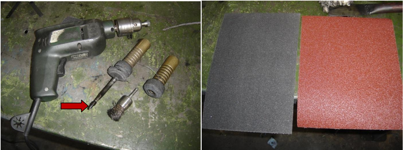
Εικόνα 2.67 Στην αριστερή φωτογραφία απεικονίζεται το ηλεκτρικό δρόπανο με τις λειαντικές πέτρες και τη συρματοβουρτσα. Στις λειαντικές πέτρες προσαρμόζεται μία ράβδος (βέλος). Στη δεξιά φωτογραφία απεικονίζονται το ψιλό (μαύρο) και το χοντρό (κόκκινο) συμριδόπανο.
