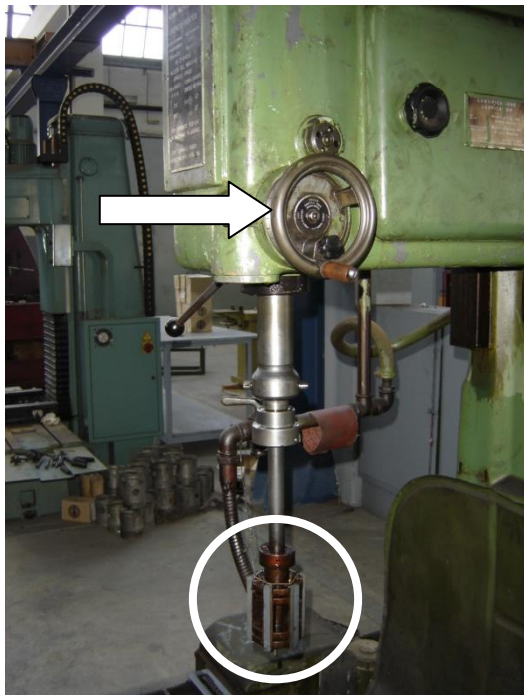
Εικόνα 2.51 Στην αριστερή φωτογραφία με το άσπρο βέλος η μανιβέλα μεταβολής διαμέτρου του λειαντικού στοιχείου και μέσα στον κύκλο το λειαντικό στοιχείο. Δεξιά φωτογραφία το μπλοκ στην τράπεζα της εργαλειομηχανής.
