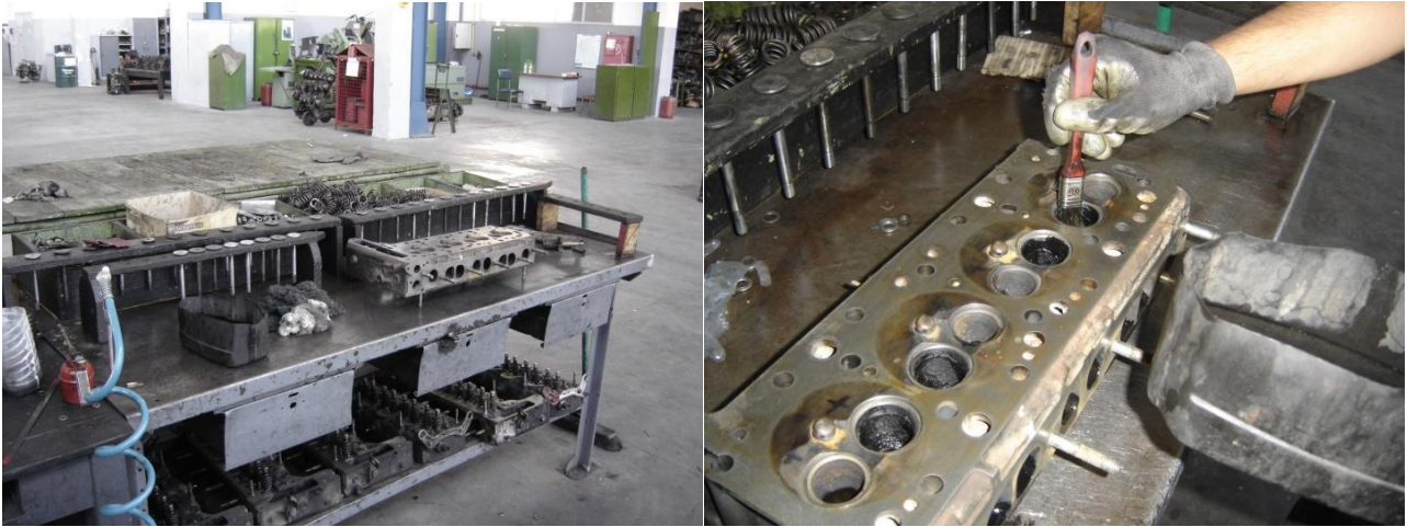
Εικόνα 2.85 Στην αριστερή φωτογραφία απεικονίζεται η κυλινδροκεφαλή 3. Στη δεξιά φωτογραφία στιγμιότυπο από την επάλειψη των οδηγών βαλβίδων με βενζίνη.
