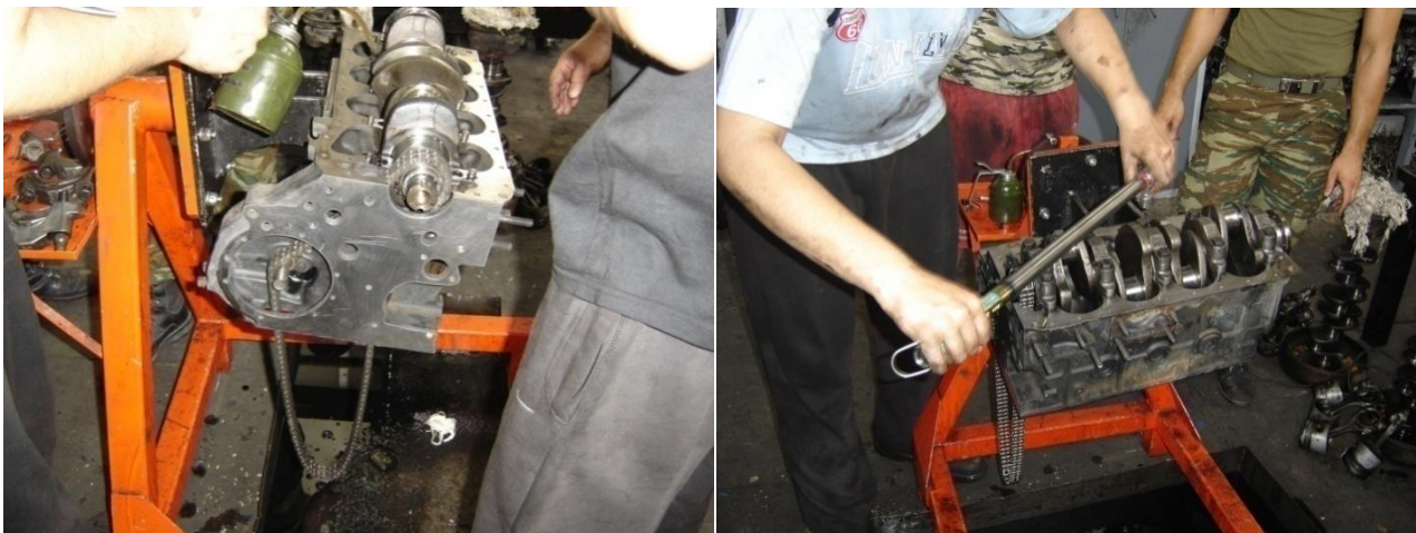
Εικόνα 2.131 Στην αριστερή φωτογραφία απεικονίζεται ο στροφαλοφόρος και η αλυσίδα. Στη δεξιά φωτογραφία στιγμιότυπο από την σύσφιξη των κοχλιών των καβαλέτων με την κατάλληλη ροπή.
