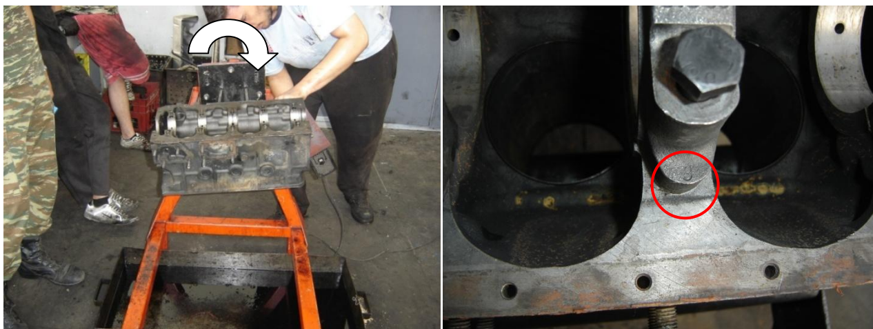
Εικόνα 2.116 Στην αριστερή φωτογραφία, η βάση στήριξης κινητήρα. Στη δεξιά φωτογραφία απεικονίζεται η αρίθμηση που έχουν τα καβαλέτα του στροφαλοφόρου άξονα.
