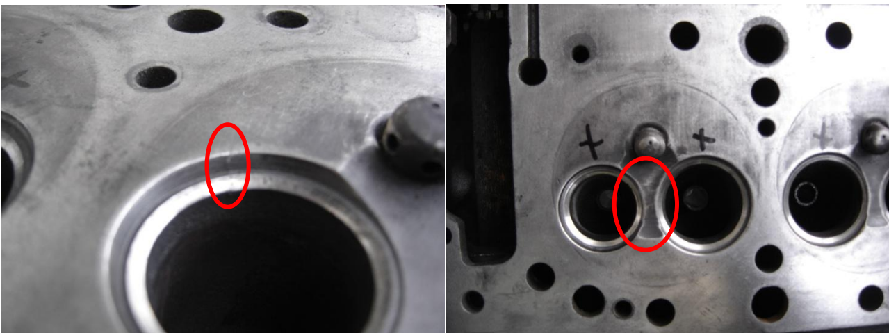
Εικόνα 2.77 Στην αριστερή φωτογραφία μόλις που διακρίνεται ρωγμή σε έδρα. Στη δεξιά φωτογραφία απεικονίζεται η περιοχή που συγκεντρώνονται τα σημεία ολίσθησης του φίλερ. Με σταυρό είναι σημειωμένες οι έδρες με κακή στεγανότητα.
