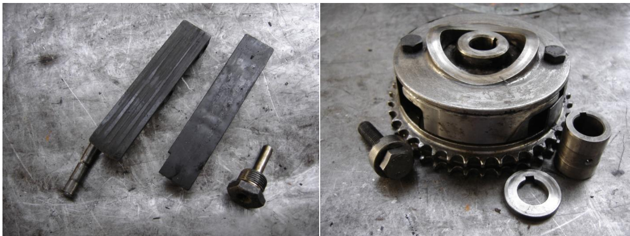
Εικόνα 2.136 Στην αριστερή φωτογραφία απεικονίζονται δύο ευθείς οδηγοί αλυσίδας, με τους πύρους τους. Ο οδηγός που έχει την εγκοπή είναι ο εξωτερικός. Στη δεξιά φωτογραφία απεικονίζεται η τροχαλία του αντίβαρου με τα παρελκόμενά της.
