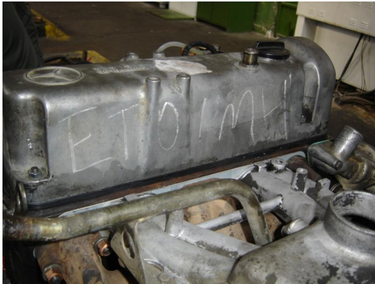
Εικόνα 2.192 Στην εικόνα απεικονίζεται η σήμανση ενός κινητήρα ("έτοιμη"), όταν εξέρχεται από το δοκιμαστήριο με επιτυχία.
