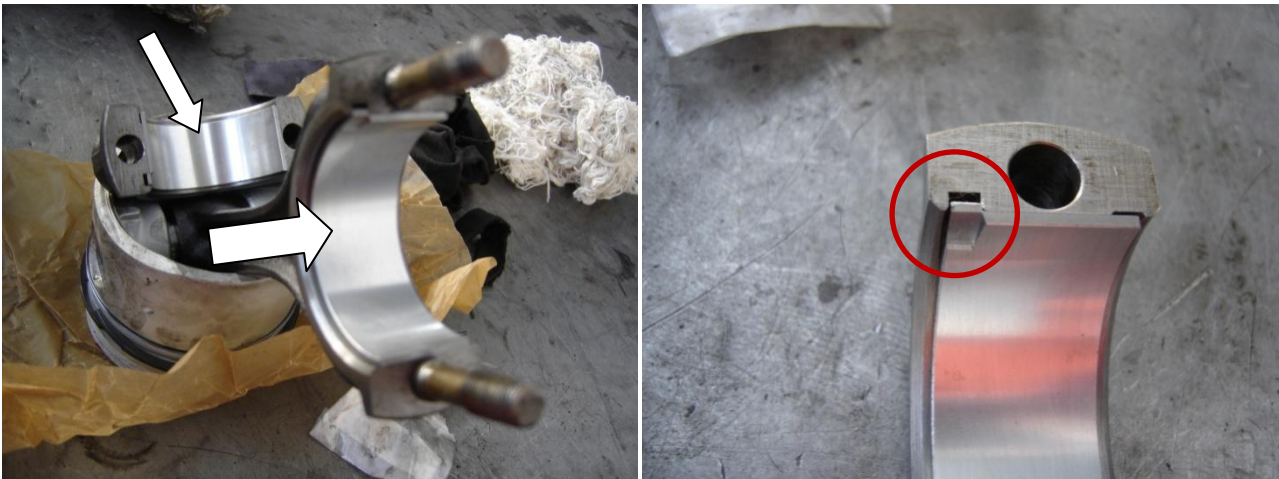
Εικόνα 2.127 Στην αριστερή φωτογραφία απεικονίζονται τα μέταλλα τοποθετημένα στον διωστήρα και στο καβαλέτο του. Στη δεξιά φωτογραφία απεικονίζεται η εγκοπή που φέρει το μέταλλο.
