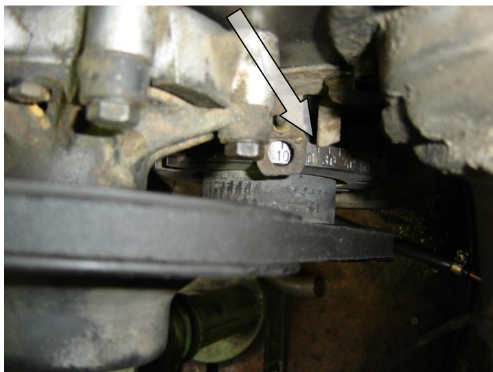
Εικόνα 2.184 Στην εικόνα επιδεικνύονται οι 24 μοίρες πριν το άνω νεκρό σημείο του 1 ου εμβόλου.
