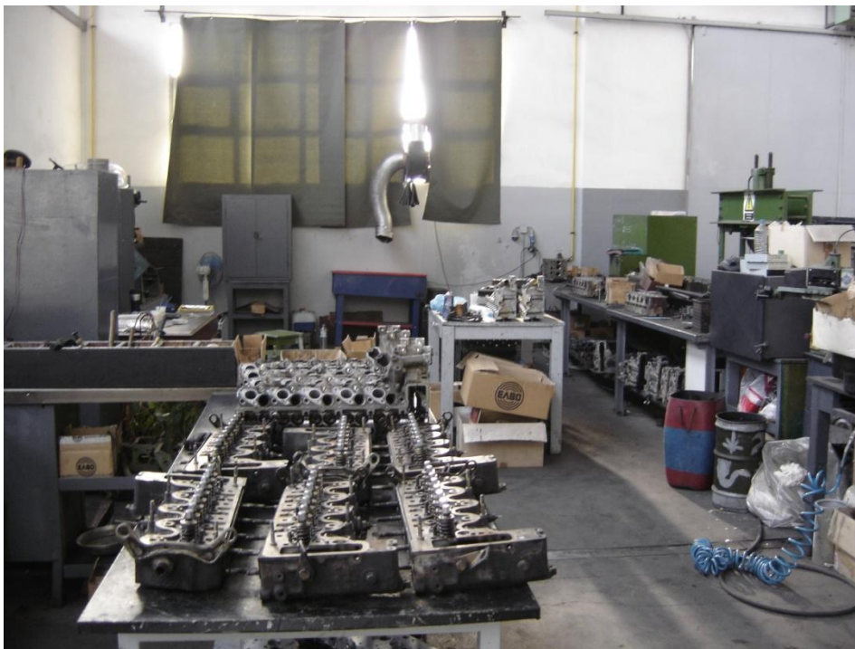
Εικόνα 2.59 Αποψη του τμήματος. Σε πρώτο πλάνο επισκευασμένες κυλινδροκεφαλές M/S 240GD.
