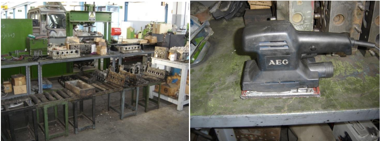
Εικόνα 2.66 Στην αριστερή φωτογραφία διακρίνεται ο ραουλόδρομος, η ξύλινη βάση και κεφαλές που αναμένουν καθαρισμό. Στη δεξιά φωτογραφία απεικονίζεται το ηλεκτρικό τριβείο.
