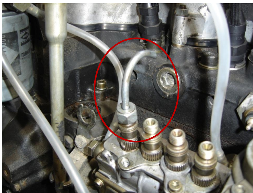
Εικόνα 2.186 Στην φωτογραφία επισημαίνεται ο μεταλλικός σωλήνας υπερχειλίσσης που βιδώθηκε στο 1ο ακροφύσιο.
