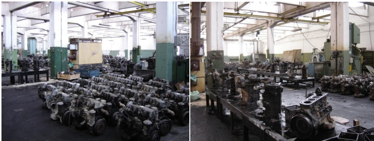
Εικόνα 2.1 Οι κινητήρες προς ανακατασκευή βρίσκονται στο δάπεδο του συνεργείου. Διακρίνονται κινητήρες που λύνονται.
