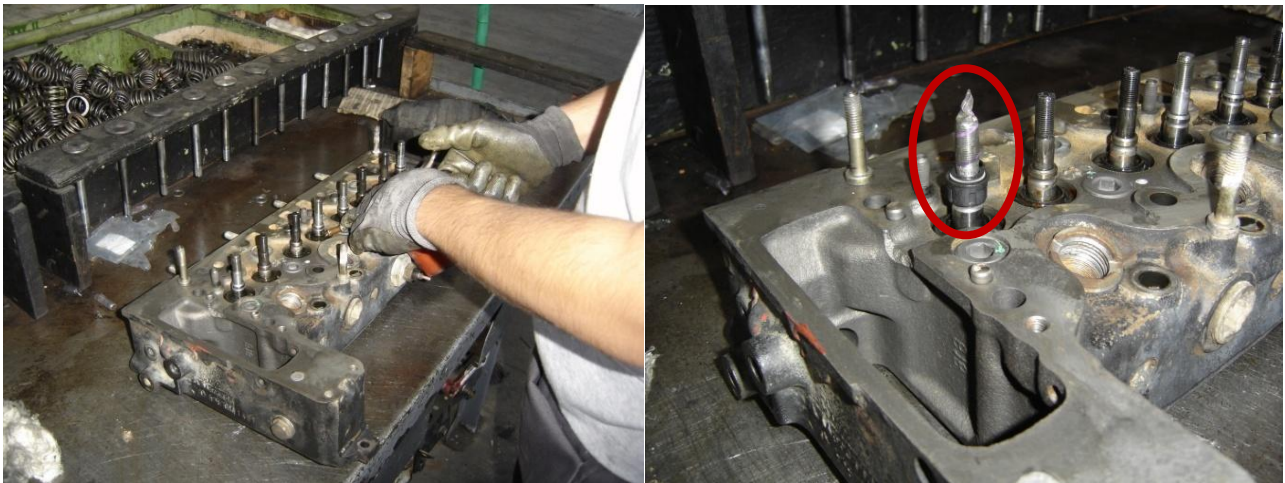
Εικόνα 2.91 Στην αριστερή φωτογραφία λίπανση των δακτυλίων. Στη δεξιά φωτογραφία απεικονίζεται το πλαστικό καπελάκι στο σπείρωμα των βαλβίδων και η τσιμούχα.
