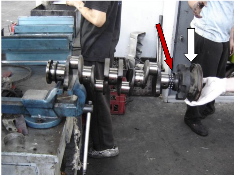
Εικόνα 2.118 Απεικονίζεται ο στροφαλοφόρος στη μέγγενη. Με άσπρο βέλος επισημαίνεται η τροχαλία που θα αφαιρεθεί. Με κόκκινο βέλος επισημαίνεται η τσιμούχα στροφάλου.
