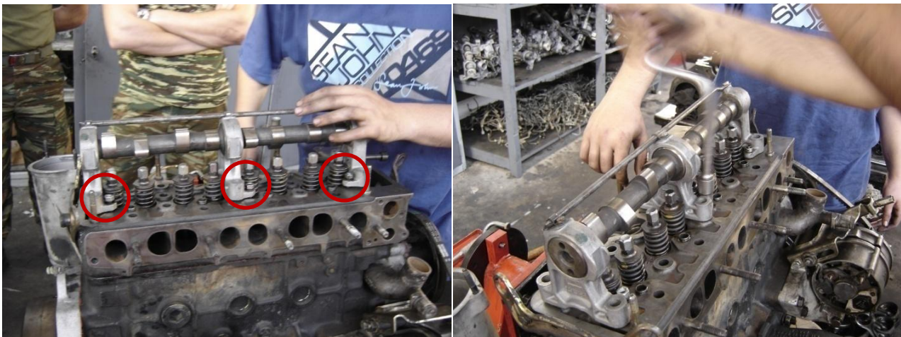
Εικόνα 2.157 Στιγμιότυπα από την τοποθέτηση του εκκεντροφόρου με τα καβαλέτα του και την κοχλίωσή του πάνω στην κυλινδροκεφαλή. Με κύκλους επισημαίνονται οι θέσεις των περικοχλίων που θα κοχλιωθούν.
