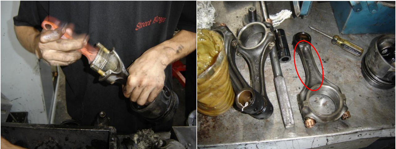
Εικόνα 2.124 Στην αριστερή φωτογραφία στιγμιότυπο από την καθαριότητα των διωστήρων. Στη δεξιά φωτογραφία επισημαίνονται τα "γράμματα" στον κορμό του διωστήρα.
