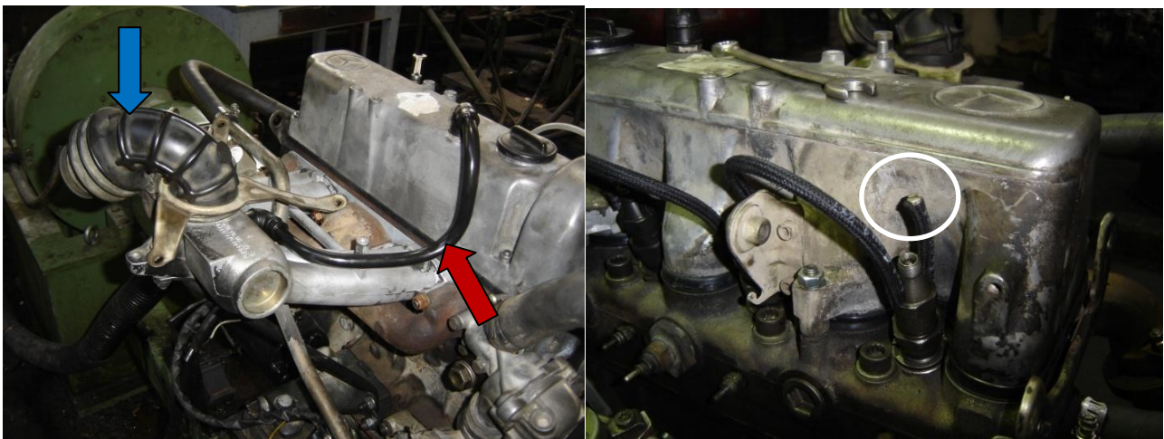
Εικόνα 2.183 Στην αριστερά φωτογραφία επισημαίνονται με βέλη ο λαστιχένιος σωλήνας της πολλαπλής εισαγωγής (μπλε) και ο σωλήνας ανακυκλοφορίας των αναθυμιάσεων (κόκκινο). Στη δεξιά φωτογραφία επιδεικνύεται η "τάπα" - βίδα που σφραγίζει τον τελευταίο αγωγό.
