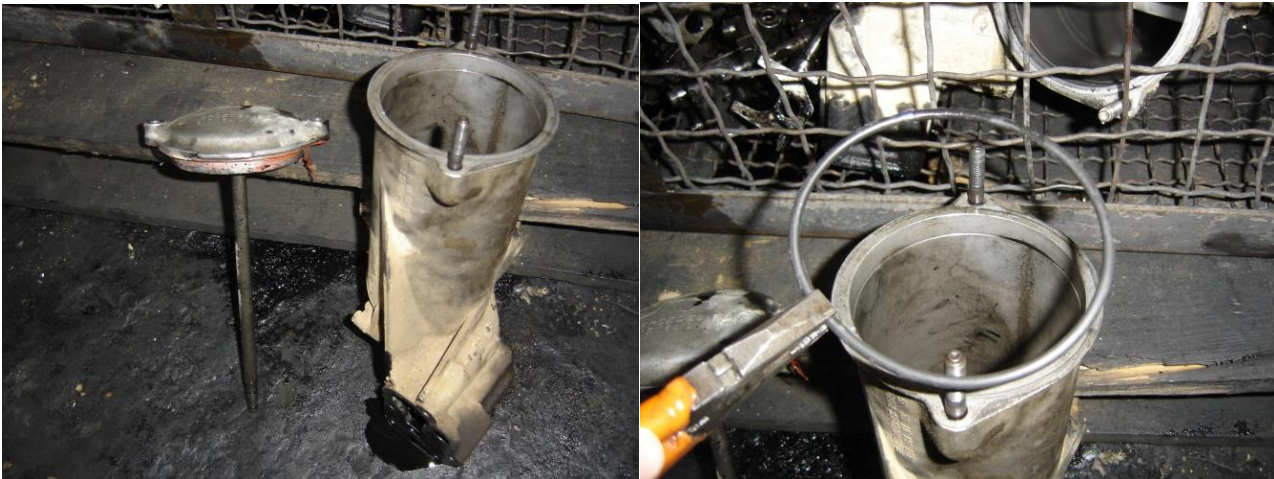
Εικόνα 2.6 Αριστερά η θήκη με το καπάκι και δεξιά η φλάντζα στεγανοποίησης.
