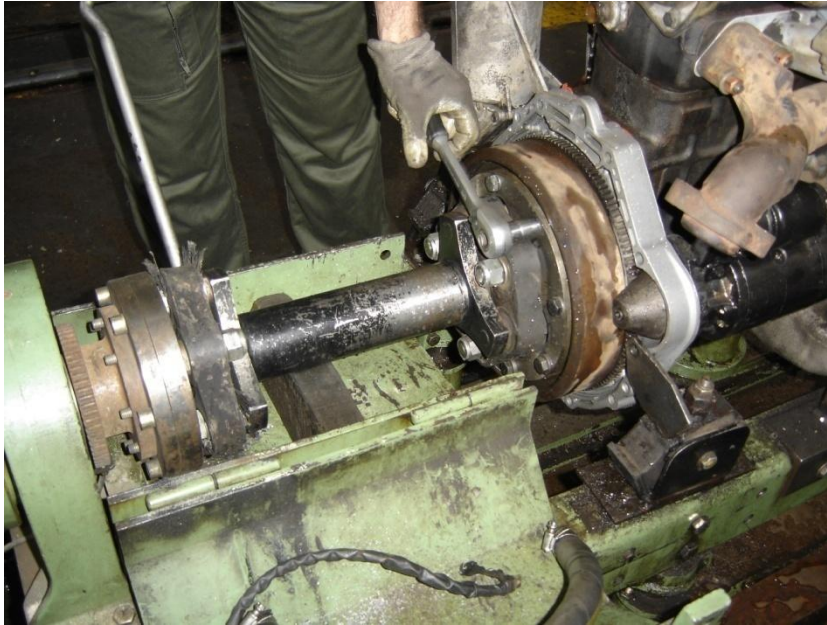
Εικόνα 2.187 Στην φωτογραφία στιγμιότυπο από την πρόοδο του άξονα της πέδης στην κυλινδρική προσθήκη του βολάν.
