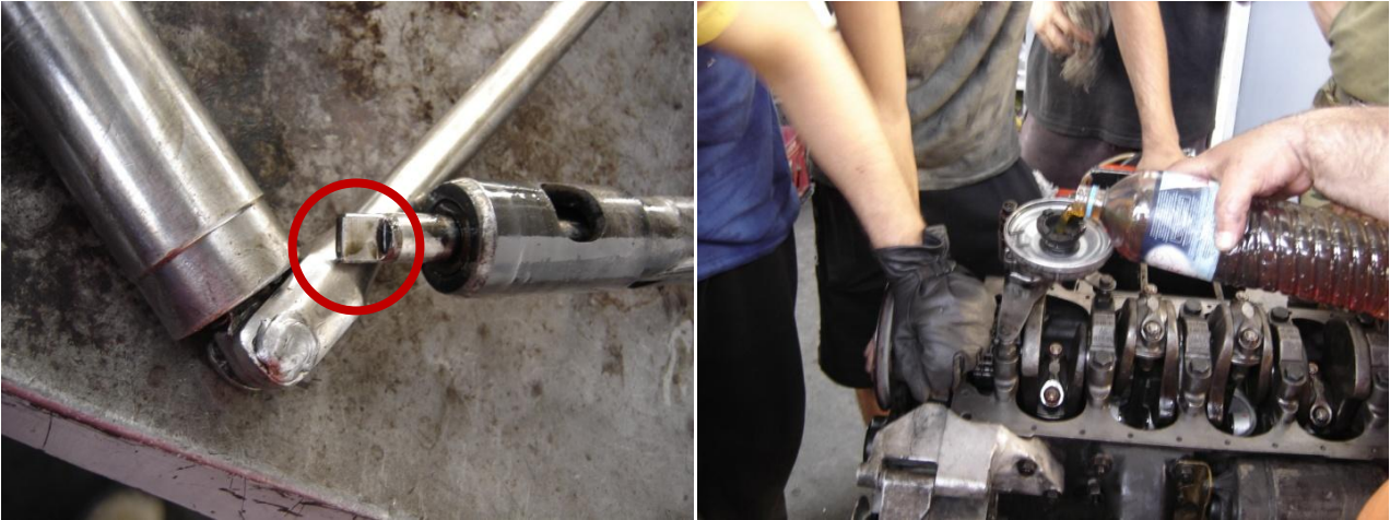
Εικόνα 2.146 Στην αριστερή φωτογραφία λεπτομέρεια από τον άξονα της ελαιαντλίας. Στη δεξιά φωτογραφία πλήρωση με λάδι της αντλίας.
