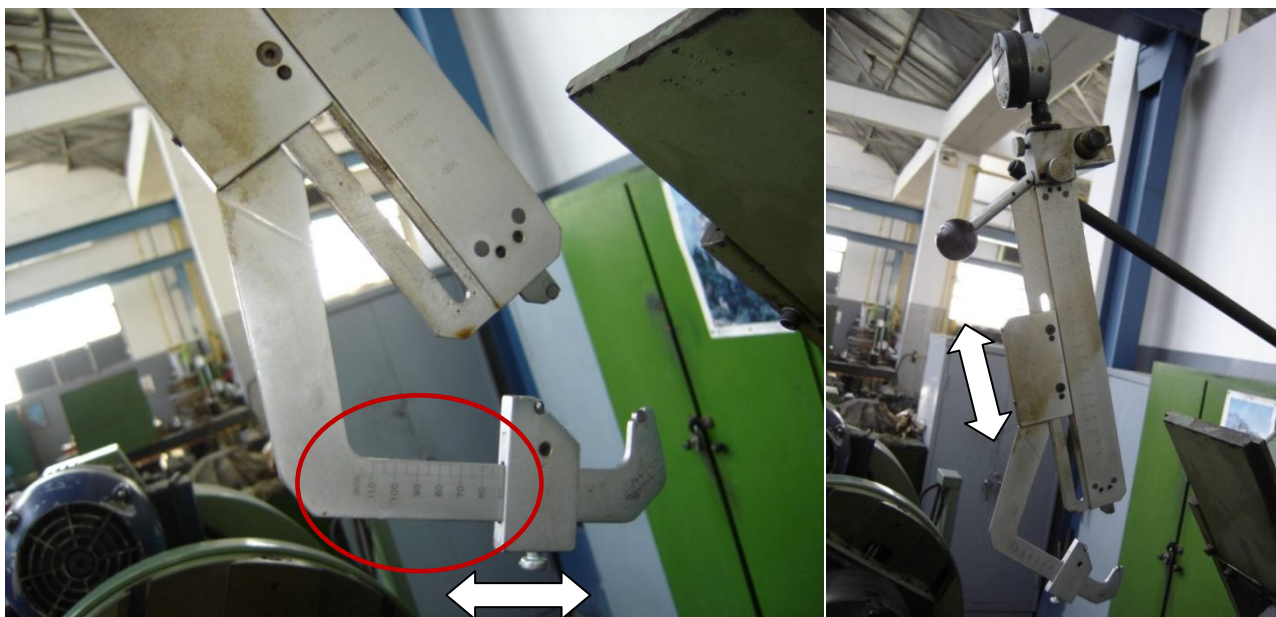
Εικόνα 2.110 Στην αριστερή εικόνα διακρίνεται η κλίμακα που φέρουν τα σκέλη του παχύμετρου. Δεξιά εικόνα, το κινητό σκέλος του παχύμετρου.
