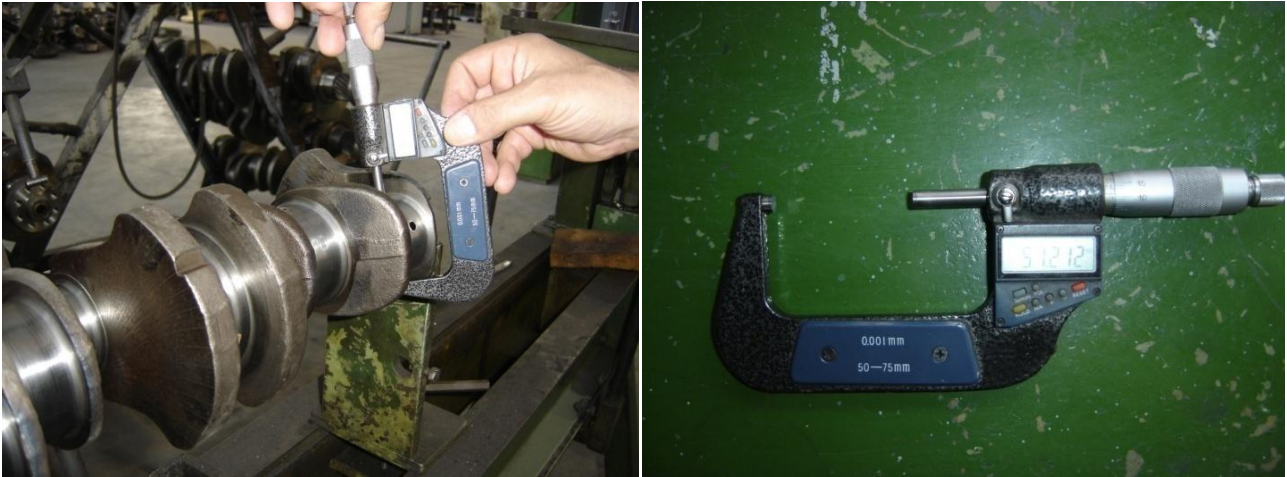
Εικόνα 2.102 Αριστερά μέτρηση κομβίου διωστήρα. Δεξιά το μικρόμετρο.
