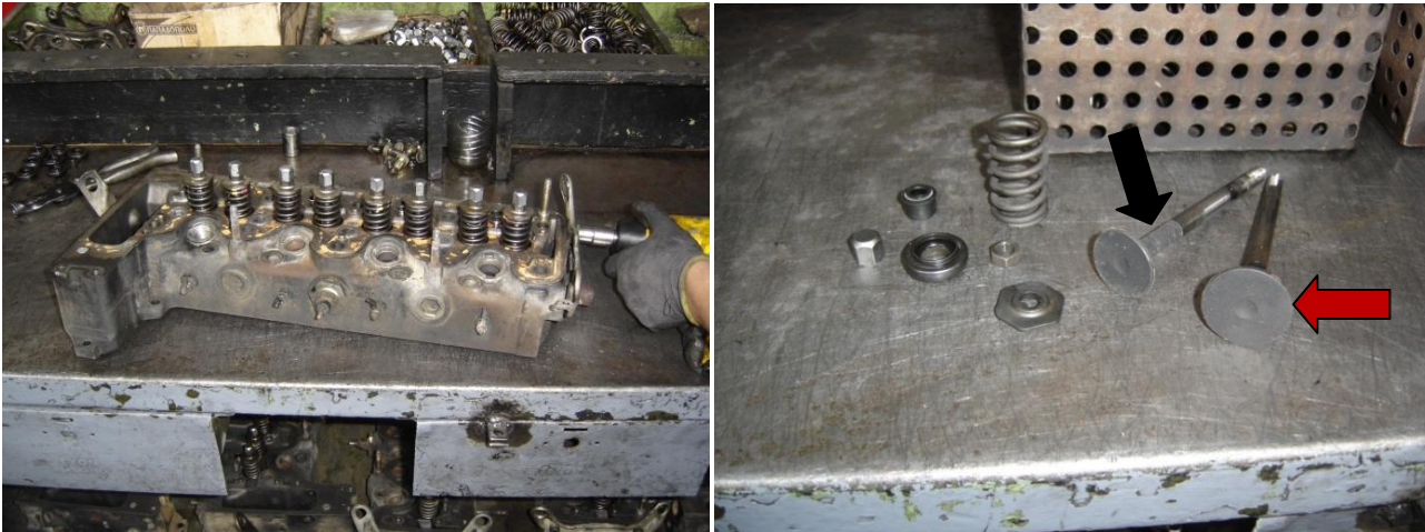
Εικόνα 2.61 Στην αριστερή φωτογραφία στιγμιότυπο από την αφαίρεση του διπλού αναρτήρα. Στη δεξιά φωτογραφία το σύστημα συγκράτησης των βαλβίδων λυμένο, και δύο βαλβίδες: με κόκκινο βέλος η εισαγωγής, με μαύρο η εξαγωγής.
