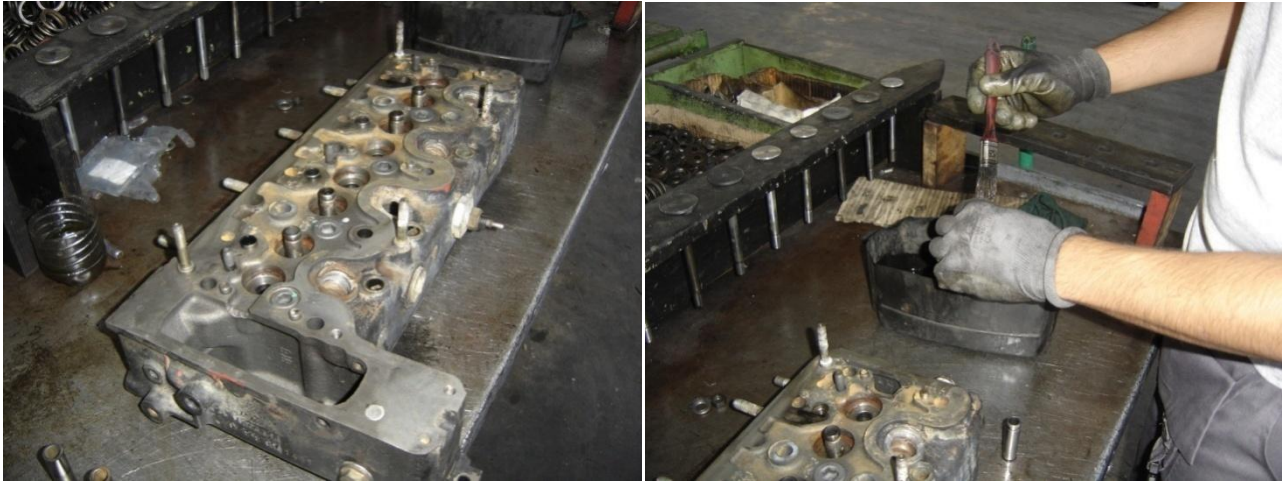
Εικόνα 2.87 Στην αριστερή φωτογραφία η κυλινδροκεφαλή χωρίς τους 4 οδηγούς εξαγωγής. Στη δεξιά φωτογραφία στιγμιότυπο καθαριότητας καινούργιων οδηγών.
