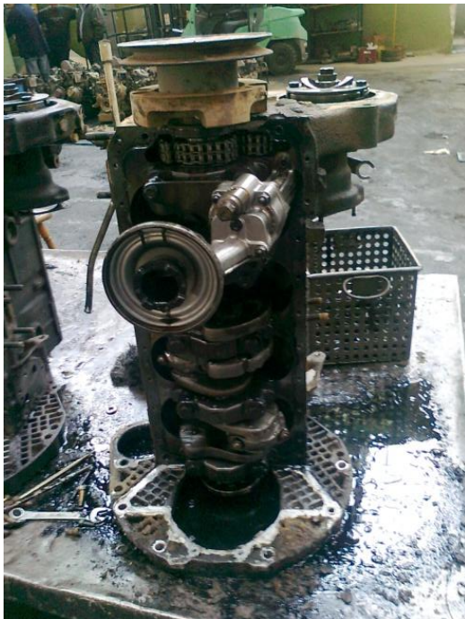
Εικόνα 2.23 Αριστερά διακρίνεται η ελαιαντλία στερεωμένη στον κορμό. Δεξιά η ελαιαντλία σε μεταλλικό καλάθι.
