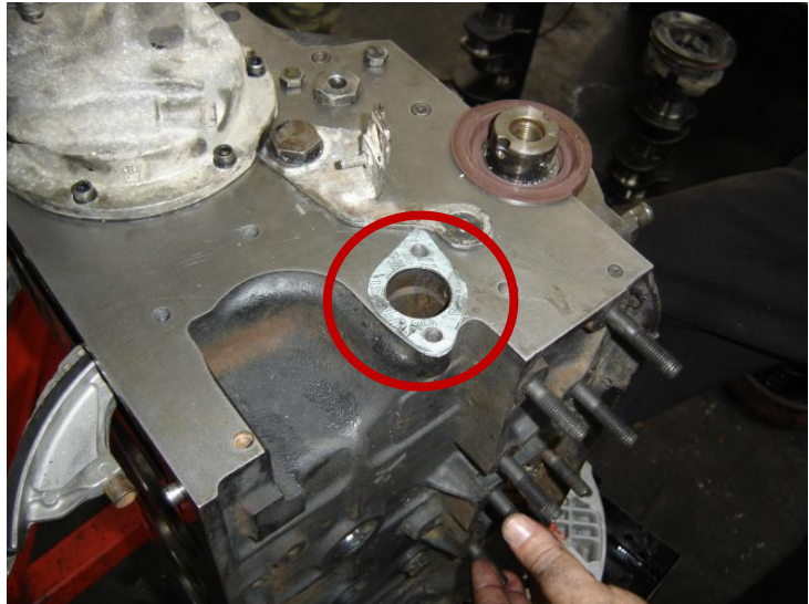
Εικόνα 2.140 Στην αριστερή φωτογραφία απεικονίζονται η αριστερή βάση του κινητήρα και η βάση του δυναμό. Διακρίνονται στη βάση στήριξης του κινητήρα ότι μερικά περικόχλια δεν έχουν βιδωθεί (βέλη). Στη δεξιά φωτογραφία απεικονίζεται η φλάντζα της υδραντλίας.
