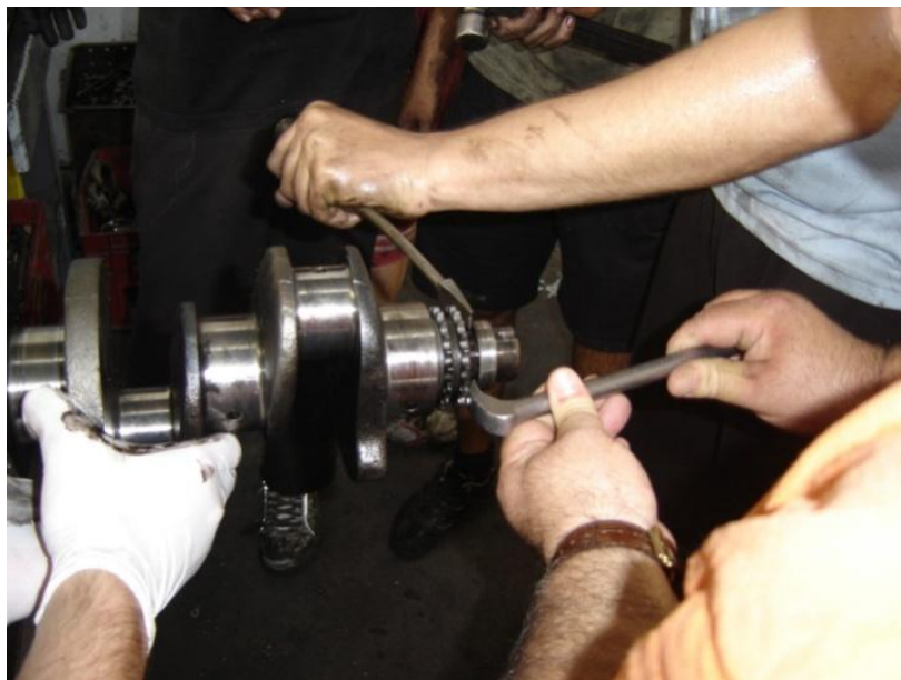
Εικόνα 2.119 Στιγμιότυπο από την αφαίρεση του δακτυλίου με τη χρήση νυχιών.
