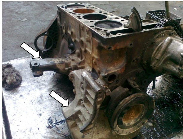
Εικόνα 2.20 Σε πρώτο πλάνο η βάση στήριξης του δυναμό. Σε δεύτερο πλάνο μία βάση στήριξης του κινητήρα.
