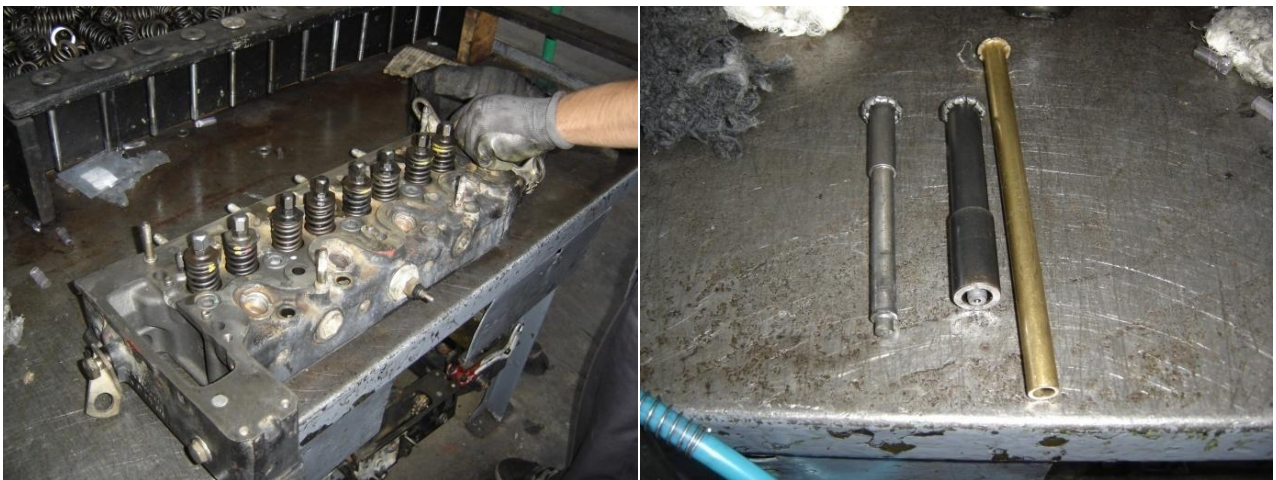
Εικόνα 2.96 Στην αριστερή φωτογραφία στιγμιότυπο από το βίδωμα των αναρτήρων. Στη δεξιά φωτογραφία απεικονίζονται από αριστερά ο ζουπάς αφαίρεσης των οδηγών, τοποθέτησης των οδηγών και τοποθέτησης των ταιμούχων.
