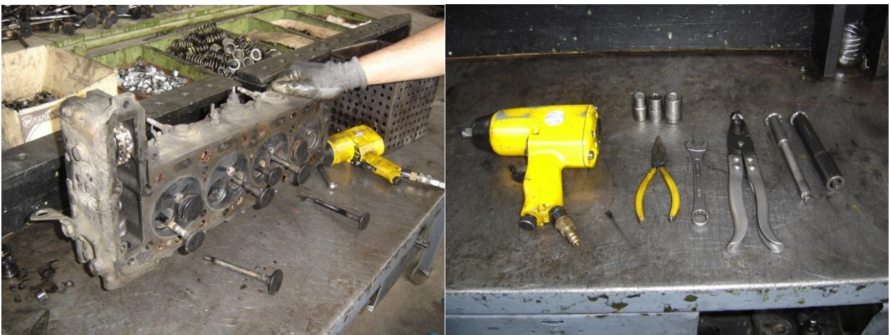
Εικόνα 2.64 Στην αριστερή φωτογραφία οι βαλβίδες βγαίνουν μόνες τους. Στη δεξιά φωτογραφία τα εργαλεία που απαιτούνται για το λύσιμο και δέσιμο των βαλβίδων: Πιστόλι, καρυδάκια, μυτοσίμπιδο, γερμανικό - πολυγωνικό κλειδί, λαβίδα και ζουπάδες για την αφαίρεση - τοποθέτηση των οδηγών.
