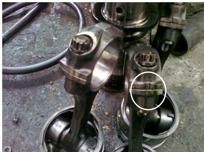
Εικόνα 2.27 Αριστερά διακρίνονται τα καβαλέτα των διωστήρων (πάνω) και στροφαλοφόρου άξονα (μέση), μέσα σε κύκλους. Δεξιά και μέσα στον κύκλο, οι δύο μαύρες γραμμές επισημαίνουν ότι πρόκειται για τον 2ο διωστήρα.
