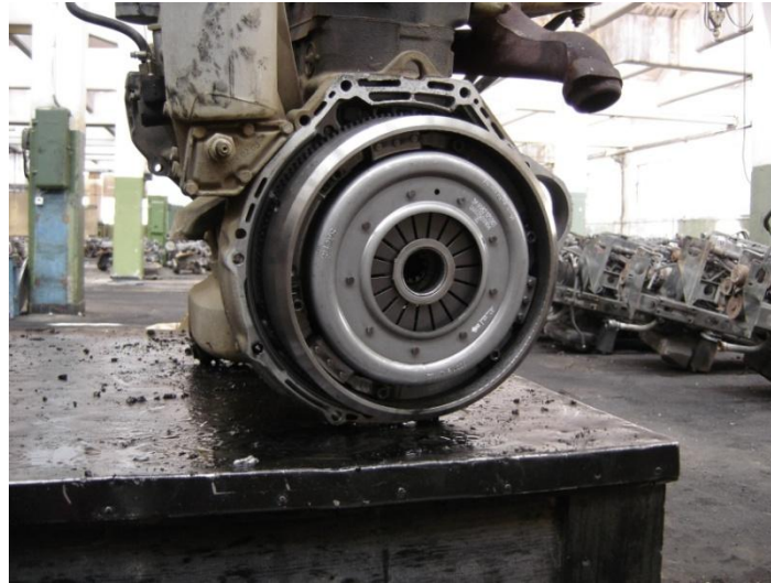
Εικόνα 2.3 Πλάκα πίεσης. Ο δίσκος του συμπλέκτη δεν διακρίνεται.
