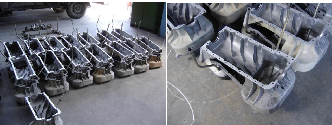
Εικόνα 2.55 Στην αριστερή φωτογραφία στοιβάδα καθαρών κάρτερ. Στη δεξιά φωτογραφία λεπτομέρεια.
