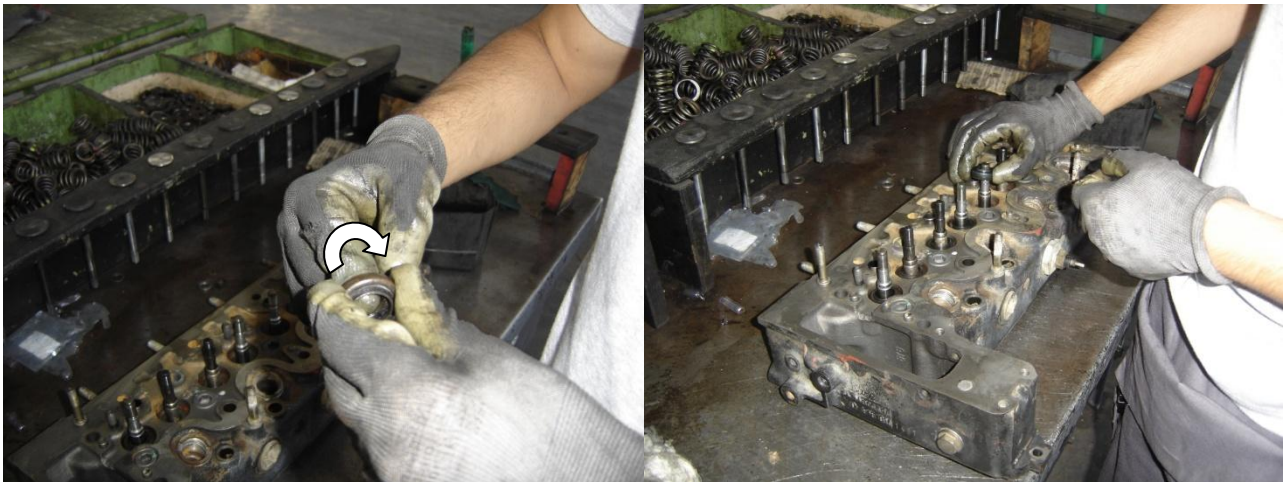
Εικόνα 2.90 Στιγμιότυπα ελέγχου ένοσφαιρου δακτυλίου και τοποθέτησή τους στην κεφαλή.
