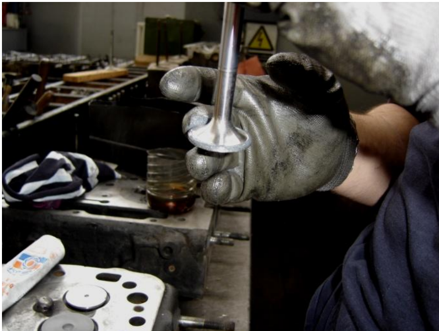
Εικόνα 2.82 Επάλειψη της σμυριδαλοιφής στην επιφάνεια που εφάπτεται η βαλβίδα με την έδρα της.
