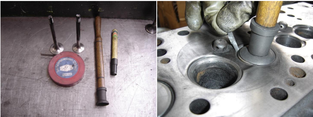
Εικόνα 2.76 Στην αριστερή φωτογραφία απεικονίζονται τα εργαλεία ελέγχου των εδρών. Στη δεξιά φωτογραφία, στιγμιότυπο από τον έλεγχο.
