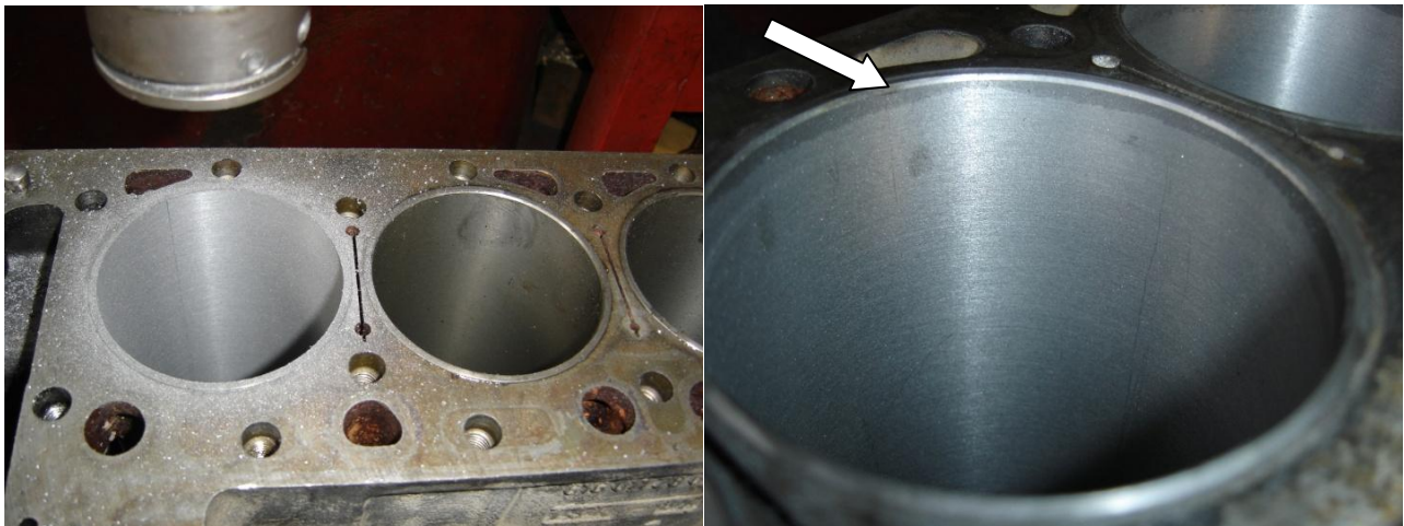
Εικόνα 2.50 Στην αριστερή φωτογραφία λεπτομέρεια κατεργασμένου (αριστερά) και μη (δεξιά) χιτωνίου. Στη δεξιά φωτογραφία, διακρίνεται η κλίση που έχει δοθεί στο χείλος του χιτωνίου.
