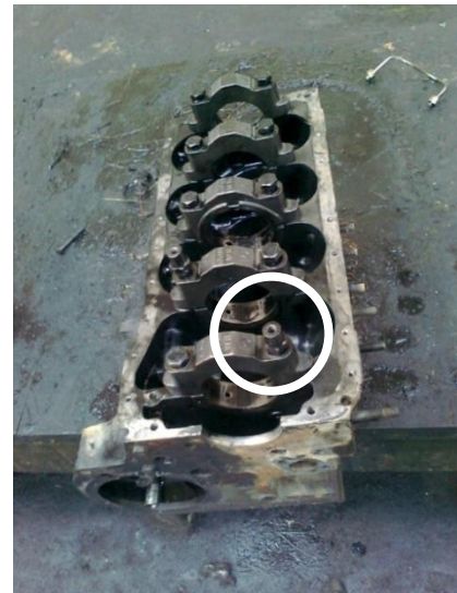
Εικόνα 2.52 Αριστερά απεικονίζονται το 1ο και 5ο καβαλέτο του στροφαλοφόρου. Διαχωρίζονται εύκολα από την μακρυνά βίδα του 1ου καβαλέτου.
