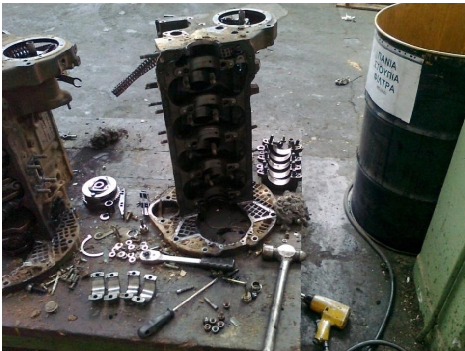
Εικόνα 2.30 Απεικονίζεται η τοποθέτηση των καβαλέτων στροφαλοφόρου (πάνω) και διωστήρων (αριστερά). Η αρίθμηση ξεκινά από αριστερά προς τα δεξιά για τα καβαλέτα των διωστήρων και από πάνω προς τα κάτω για τα καβαλέτα του στροφαλοφόρου.
