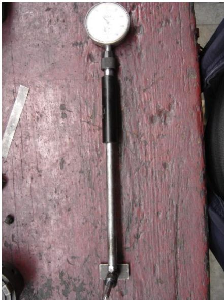
Εικόνα 2.38 Κυλινδρόμετρα. Το δεξιά έχει κλίμακα σε ίντσες.
