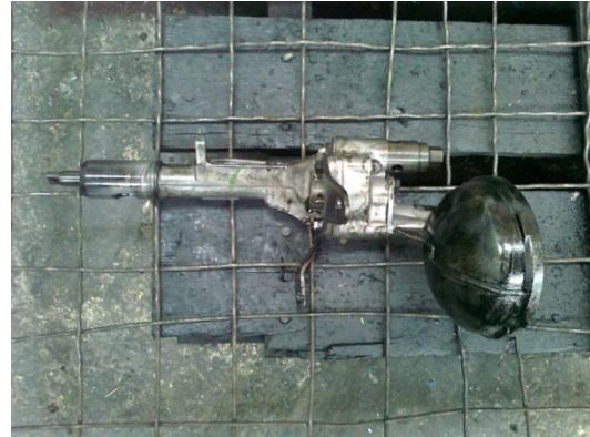
Εικόνα 2.23 Αριστερά διακρίνεται η ελαιαντλία στερεωμένη στον κορμό. Δεξιά η ελαιαντλία σε μεταλλικό καλάθι.
