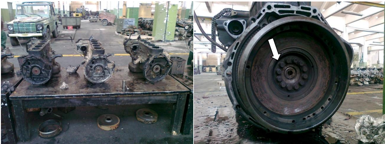
Εικόνα 2.21 Αριστερή φωτογραφία: Βολάν τοποθετημένα στο δάπεδο, κάτω από κινητήρες. Δεξιά φωτογραφία: Διακρίνονται οι κοχλίες συγκράτησης του βολάν.
