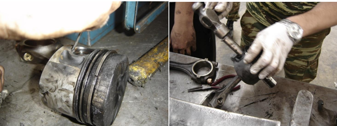
Εικόνα 2.123 Στην αριστερή φωτογραφία στιγμιότυπο από την αφαίρεση του ασφαλιστικού από τον πύρο. Στη δεξιά φωτογραφία αφαίρεση του πύρου με τη χρήση ζουπά και σφυριού.
