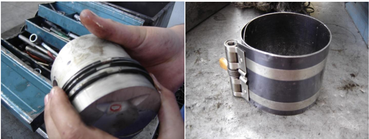
Εικόνα 2.142 Στην αριστερή φωτογραφία απεικονίζονται τα ελατήρια του εμβόλου. Διακρίνονται τα διάκενά τους. Στη δεξιά φωτογραφία απεικονίζεται ο "κολιές".
