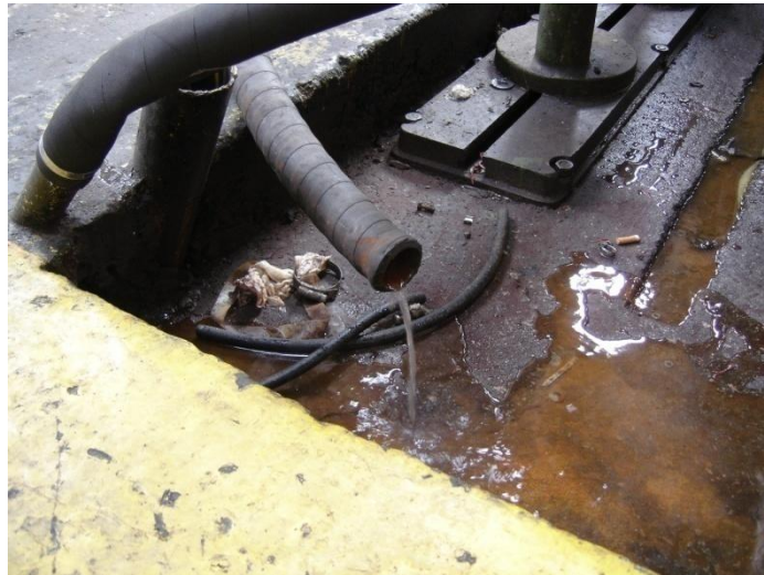
Εικόνα 2.191 Στην εικόνα απεικονίζεται η σωστή ροή ζεστού νερού πριν να ανοίξει ο θερμοστάτης.
