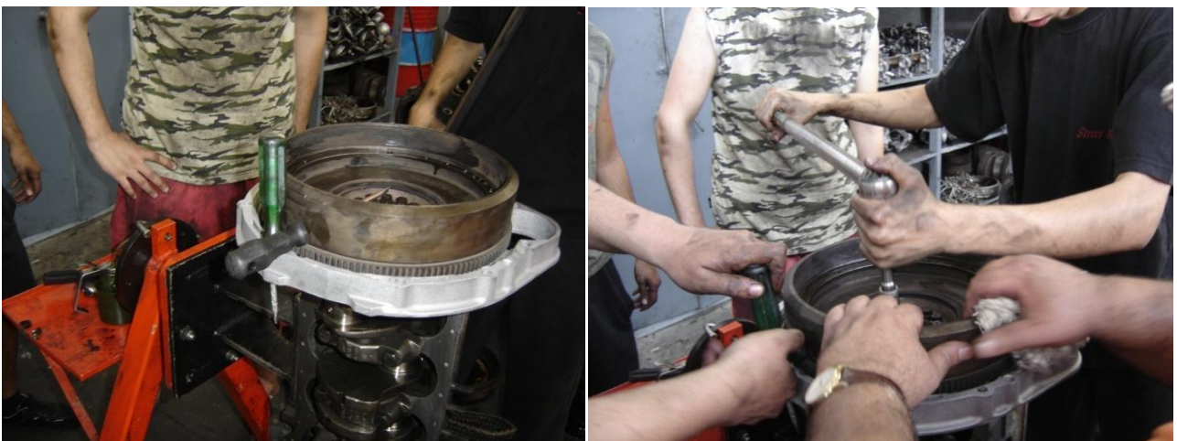
Εικόνα 2.134 Στην αριστερή φωτογραφία η "κόντρα" με τα δύο κατσαβίδια. Στη δεξιά φωτογραφία στιγμιότυπο από τη σύσφιξη με το δυναμόκλειδο των κοχλιών του βολάν.
