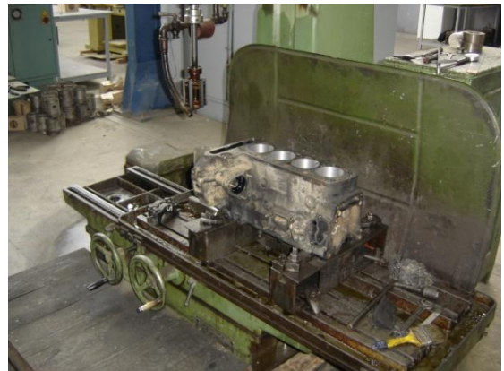
Εικόνα 2.51 Στην αριστερή φωτογραφία με το άσπρο βέλος η μανιβέλα μεταβολής διαμέτρου του λειαντικού στοιχείου και μέσα στον κύκλο το λειαντικό στοιχείο. Δεξιά φωτογραφία το μπλοκ στην τράπεζα της εργαλειομηχανής.
