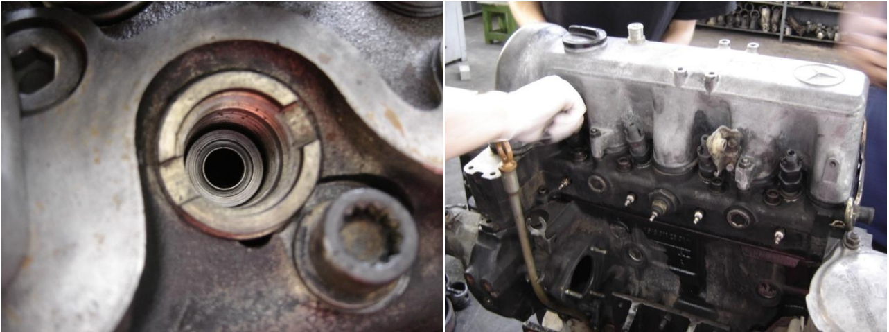
Εικόνα 2.168 Στην αριστερή φωτογραφία η οπή του μπεκ με τη ροδέλα στο βάθος. Στη δεξιά φωτογραφία στιγμιότυπο από την κοχλίωση των μπεκ. Είναι ήδη τοποθετημένο το κάλυμμα της κυλινδροκεφαλής.
