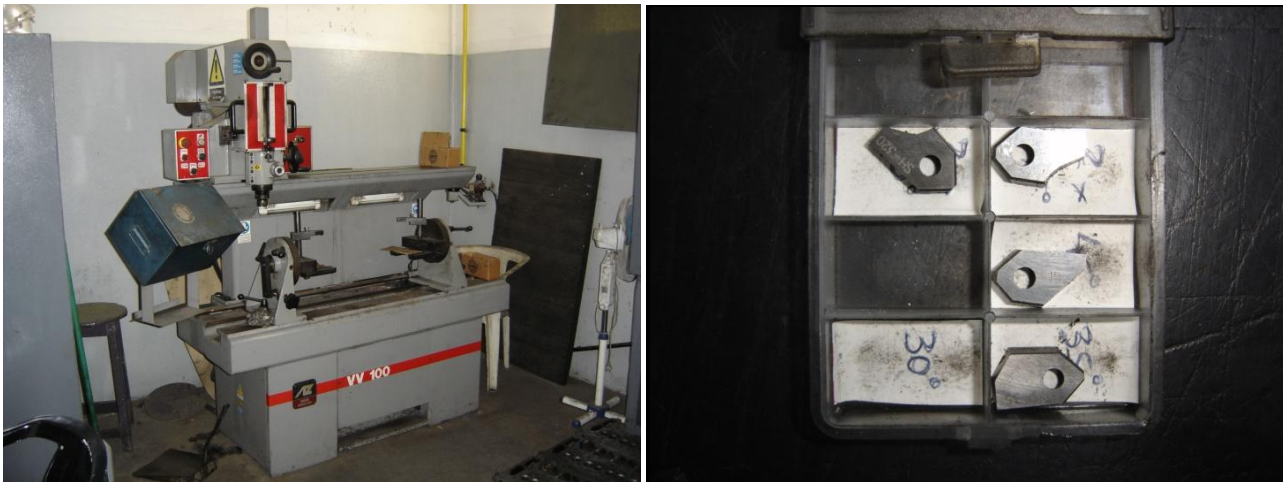
Εικόνα 2.78 Στην αριστερή φωτογραφία απεικονίζεται η εργαλειομηχανή ρεκτιφιέ και στη δεξιά τα κοπτικά εργαλεία.
