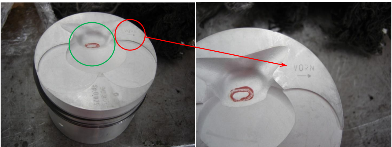
Εικόνα 2.125 Στην αριστερή φωτογραφία επισημαίνονται με πράσινο κύκλο το σημείο στο οποίο η πυρόφουσκα εισέρχεται στο έμβολο, όταν αυτό βρίσκεται στο άνω νεκρό σημείο, και, με κόκκινο κύκλο η λέξη "vorn" και το βελάκι. Στη δεξιά φωτογραφία λεπτομέρεια.
