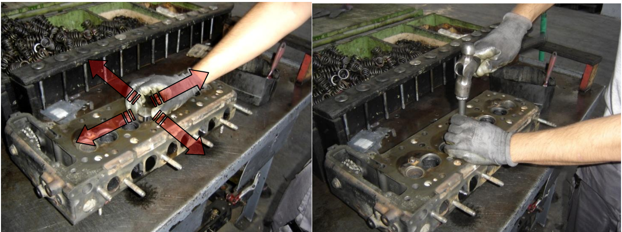
Εικόνα 2.86 Στην αριστερή φωτογραφία στιγμιότυπο από τον έλεγχο των οδηγών. Στη δεξιά φωτογραφία στιγμιότυπο από την αντικατάσταση οδηγού εξαγωγής.
