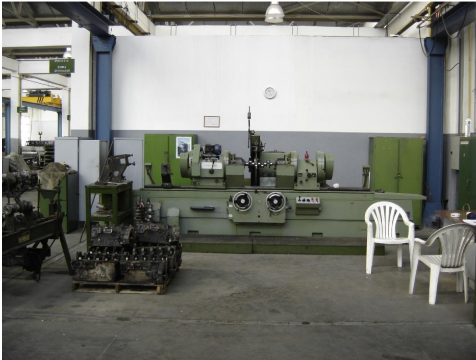
Εικόνα 2.99 Άποψη του τμήματος στροφαλοφόρων. Στο κέντρο η εργαλειομηχανή ρεκτιφιέ. Στο δάπεδο αριστερά επισκευασμένα μπλοκ κινητήρα που τοποθετήθηκαν εκεί λόγω έλλειψης χώρου στο τμήμα ρεκτιφιέ κορμού.
