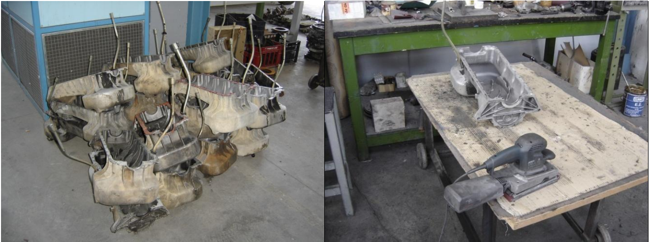
Εικόνα 2.54 Στην αριστερή φωτογραφία κάρτερ που δεν έχουν καθαριστεί. Στη δεξιά φωτογραφία το ηλεκτρικό τριβείο και καθαρό κάρτερ.
