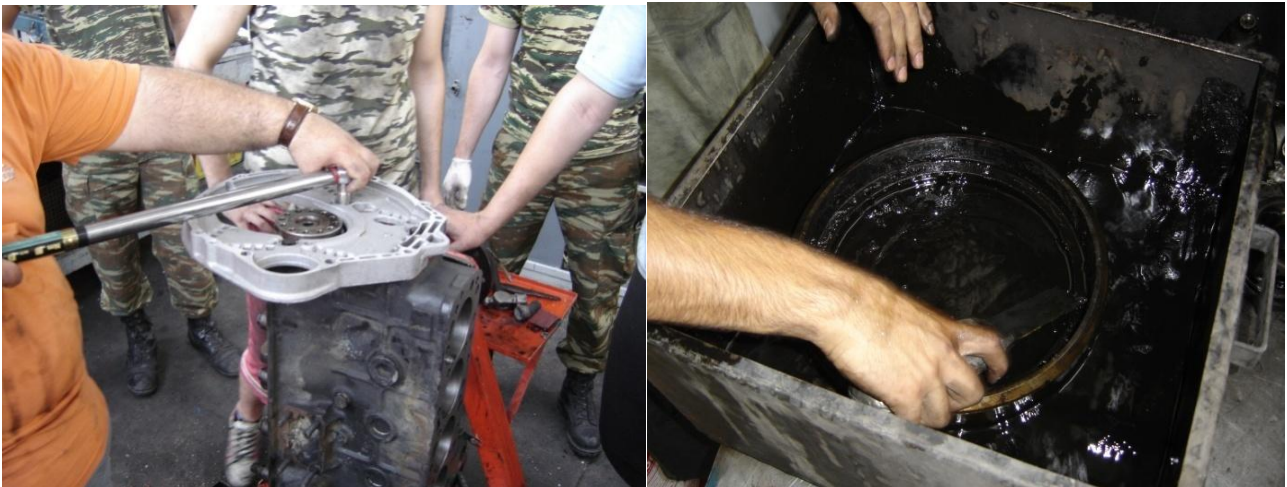
Εικόνα 2.133 Στην αριστερή φωτογραφία στιγμιότυπο από τη σύσφιξη των κοχλιών της πλάτης. Στη δεξιά φωτογραφία στιγμιότυπο από την καθαριότητα του βολάν.
