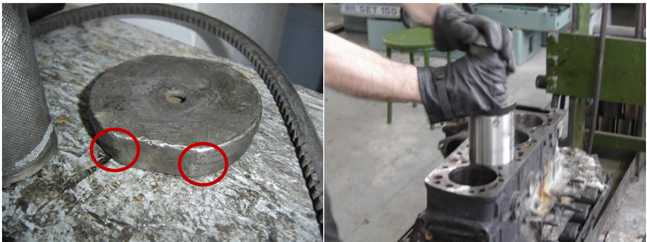
Εικόνα 2.44 Στην αριστερή φωτογραφία απεικονίζεται το κυλινδρικό τεμάχιο με τον αναβαθμό (κύκλοι). Στη δεξιά φωτογραφία στιγμιότυπο από πρεσσάρισμα χιτωνίου.
