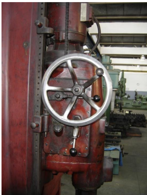
Εικόνα 2.49 Στην αριστερή φωτογραφία η μανιβέλα μετακίνησης πάνω-κάτω του άξονα της εργαλειομηχανής. Στην αριστερή φωτογραφία με τη σειρά κοπτικά εργαλεία δημιουργίας κλίσης και απότμησης.
