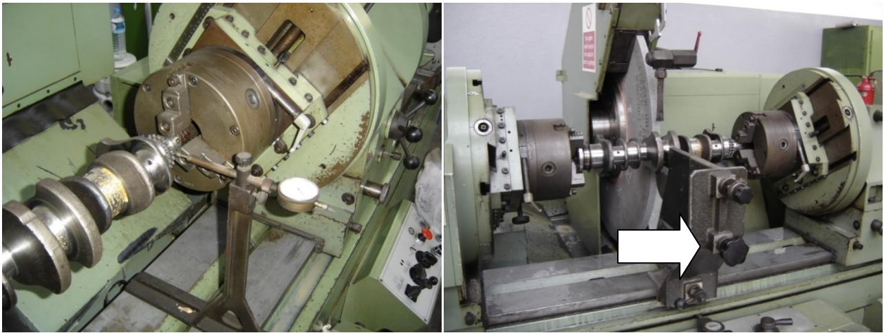
Εικόνα 2.108 Αριστερά στιγμιότυπο από την ευθυγράμμιση του άξονα της ακριανής επιφάνειας του στροφαλοφόρου με το ρολόι. Δεξιά το καβαλέτο για την υποστήριξη του στροφαλοφόρου.
