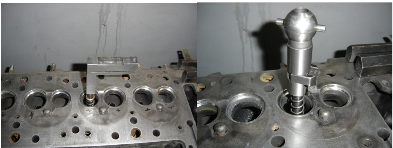
Εικόνα 2.79 Στην αριστερή φωτογραφία απεικονίζεται το αλφάδι. Στη δεξιά φωτογραφία απεικονίζεται η κεφαλή που φέρει το κοπτικό εργαλείο.
