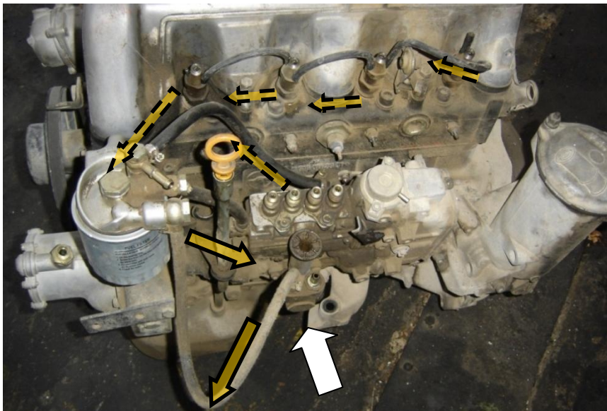
Εικόνα 2.182 Στην εικόνα επισημαίνεται η διαδρομή του πετρελαίου από την ΑΥΠ προς το φίλτρο και από το φίλτρο στην ΑΥΠ (βέλη συνεχούς γραμμής) και η διαδρομή του περισσευούμενου πετρελαίου από την ΑΥΠ στο φίλτρο και από τα μπεκ στο φίλτρο (βέλη διακεκομμένης γραμμής). Με άσπρο βέλος επισημαίνεται η αντλία χαμηλής πίεσης.
