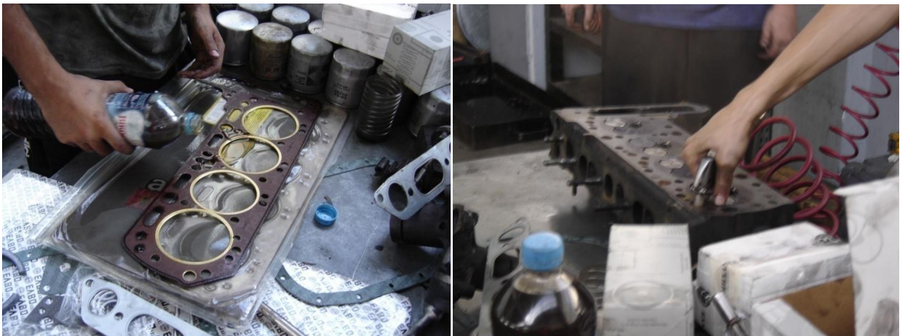
Εικόνα 2.153 Στην αριστερή φωτογραφία στιγμιότυπο από τη λίπανση της φλάντζας κεφαλής. Στη δεξιά φωτογραφία, απομάκρυνση ακαθαρσιών με τη χρήση πεπιεσμένου αέρα.
