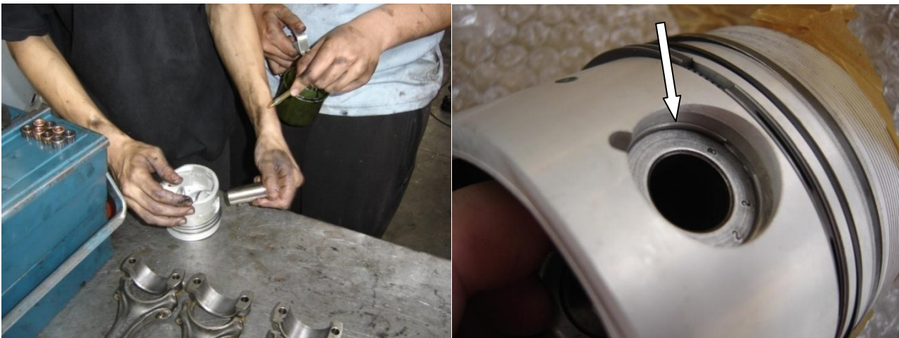
Εικόνα 2.126 Στην αριστερή φωτογραφία στιγμιότυπο από την τοποθέτηση του πύρου στο έμβολο. Στη δεξιά φωτογραφία απεικονίζεται ο πύρος και ο ασφαλιστικός δακτύλιος (βέλος).
