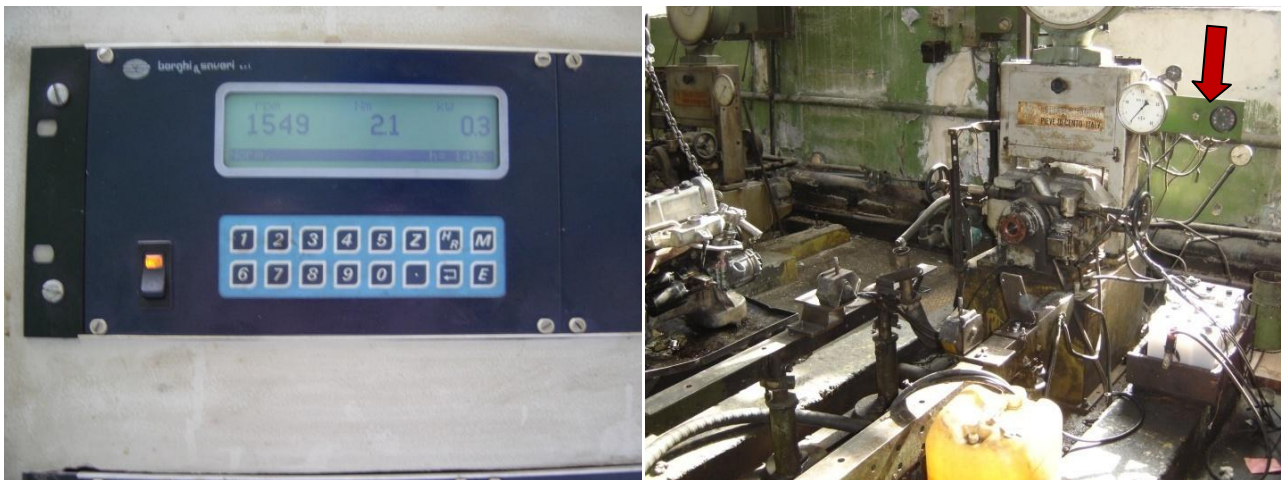
Εικόνα 2.189 Στην αριστερή φωτογραφία η οθόνη της κλίνης με την υδραυλική πέδη. Διακρίνονται οι τιμές ισχύος (0,3 kW), ροπής (2,1 Nm) και στροφών (1549 rpm). Στη δεξιά φωτογραφία επιδεικνύεται ο πίνακας ελέγχου της κλίνης χωρίς πέδη. Είναι παρόμοιος με αυτόν του αυτοκινήτου.
