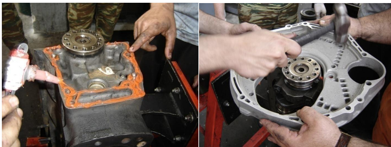
Εικόνα 2.132 Στην αριστερή φωτογραφία απεικονίζεται η επάλειψη με κόλλα της επιφάνειας επαφής κορμού - πλάτης. Στη δεξιά φωτογραφία στιγμιότυπο από τη χρήση του σφυριού για να φωλιάσουν οι πύροι του κορμού στις οπές της πλάτης.
