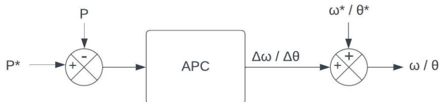
Σχήμα 2.9: Ο Ελεγκτής Ενεργούς Ισχύος ή Active Power Controller, όπου P^* , P , \Delta\omega , \Delta\theta , \omega^* , \theta^* , \omega , \theta η ενεργός ισχύς αναφοράς, η μετρούμενη ενεργός ισχύς, η διαφορά γωνιακής συχνότητας, η διαφορά φάσης, η ονομαστική γωνιακή συχνότητα, η ονομαστική φάση, η παραγόμενη γωνιακή συχνότητα και η παραγόμενη φάση.
