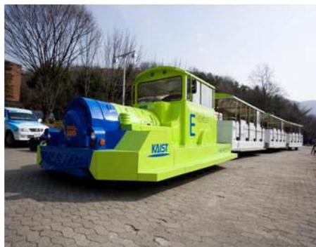
Εικόνα 2-44: 3ης γενιάς OLEV τρένο σε δρόμο 2,2 km στο Seoul Grand Park όπου 375m ήταν στρωμένα με ράγες παροχής ισχύος των 24m [19]
