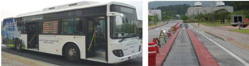
Εικόνα 2-42: 2ης γενιάς OLEV λεωφορείο στο KAIST Munji Campus με τέσσερις ράγες ισχύος των 60 m η καθεμιά [19]
