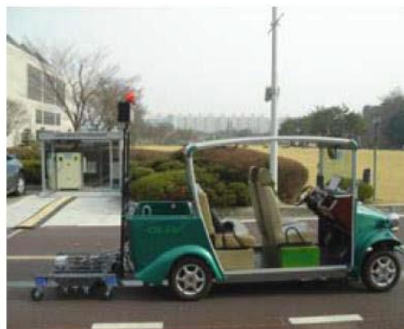
Εικόνα 2-40: 1ης γενιάς OLEV όχημα γκολφ [19]
