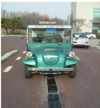
Εικόνα 2-40: 1ης γενιάς OLEV όχημα γκολφ [19]
