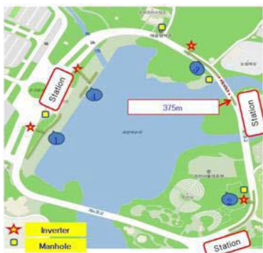
Εικόνα 2-44: 3ης γενιάς OLEV τρένο σε δρόμο 2,2 km στο Seoul Grand Park όπου 375m ήταν στρωμένα με ράγες παροχής ισχύος των 24m [19]
