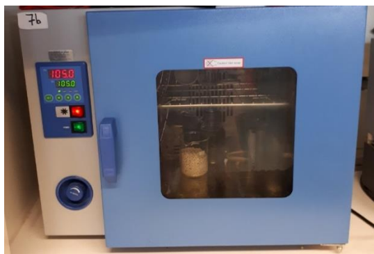
Εικόνα 32: Φούρνος ξήρανσης Carbolite.
